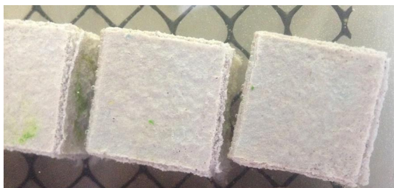
Figura 4.15 – Detalhe da camada de sulfato de cálcio sobre os corpos de prova de argamassa
