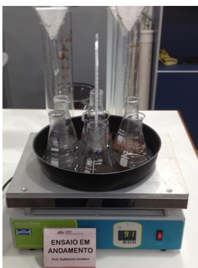
Figura 3.15 – Etapa de mistura da solução do ensaio de fração solúvel.
