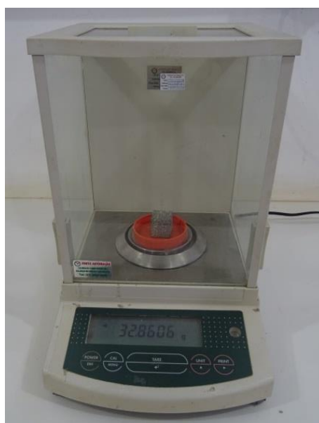
Figura 3.30 – Detalhe da medição da massa saturada superfície seca de uma amostra de argamassa submetida a ataque ácido.
