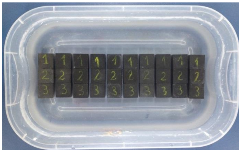
Figura 3.27 – Corpos de prova das argamassas imersos em água.
