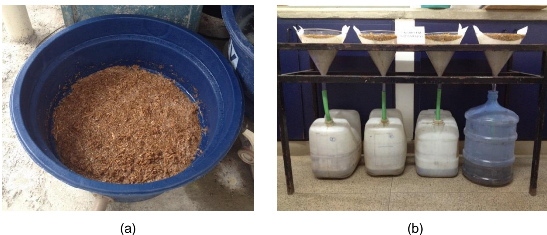
Figura 3.5 – Lixiviação da amostra de folha de milho (a) e filtragem da amostra lixiviada (b).
