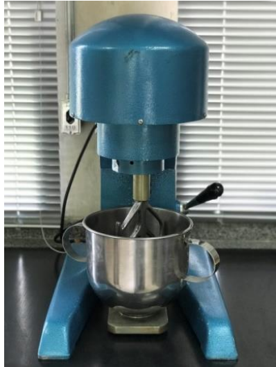
Figura 3.24 – Misturador de bancada utilizado na produção das argamassas.
