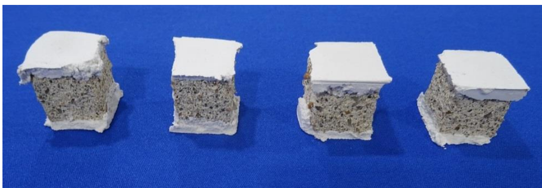
Figura 3.31 – Detalhe do capeamento dos corpos de prova degradados.
