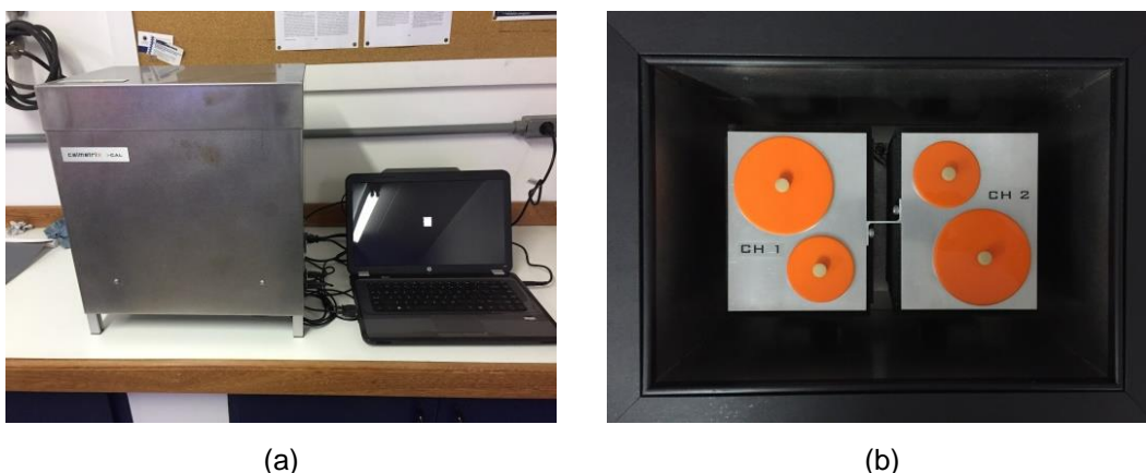
Figura 3.22 – Calorímetro isotérmico Calmetrix I-CAL 2000 (a) e detalhe dos canais do calorímetro (b).
