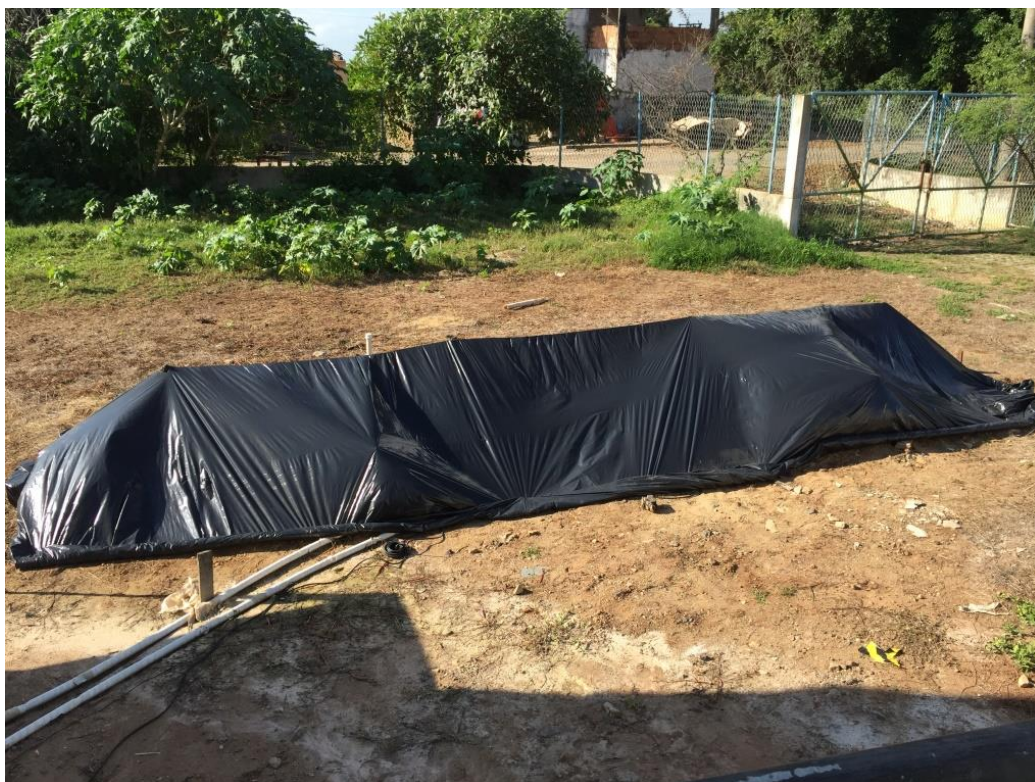
Figura 24 - Proteção com lona plástica na viga de referência utilizada na medição do deslocamento da cabeça da estaca.
