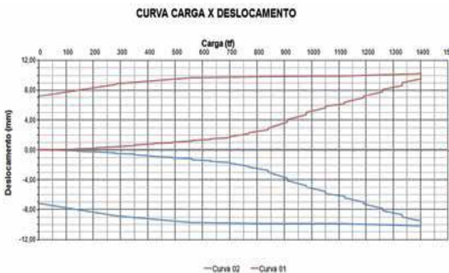
Figura 14 - Curva carga x deslocamento de topo e base - Ensaio Bidirecional. (Souza Cruz et al. 2015).
