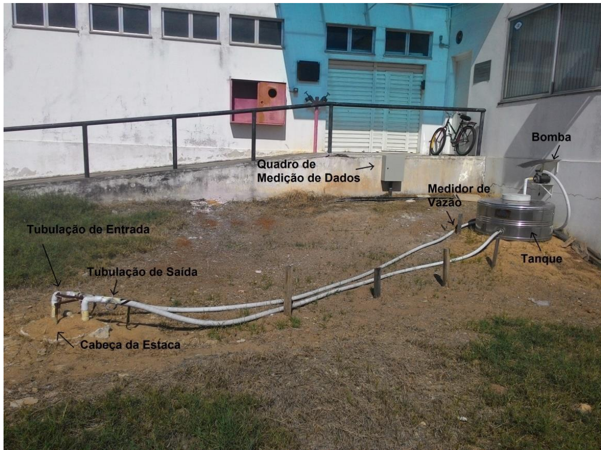
Figura 23 – Equipamentos auxiliares utilizados na realização do ensaio experimental. (Ferreira, 2017).
