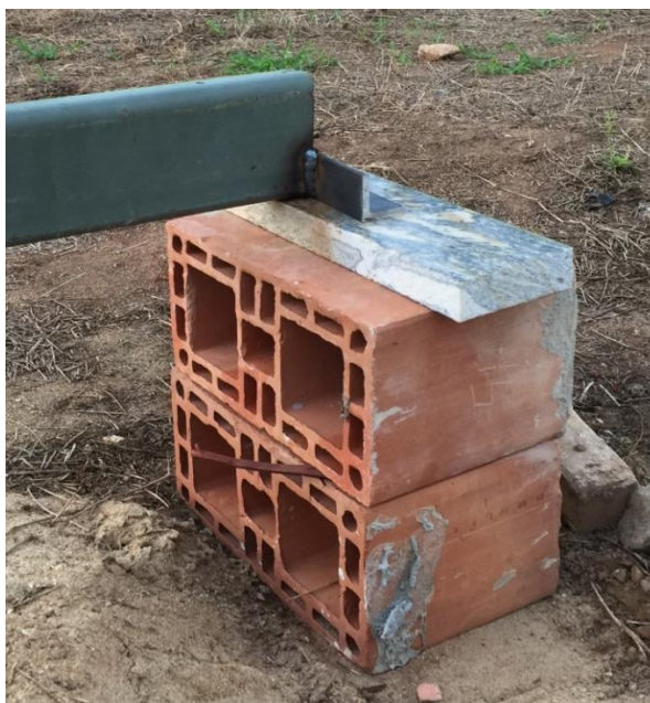
Figura 25 - Apoio da viga de referência lubrificada no contato entre a viga e o apoio.
