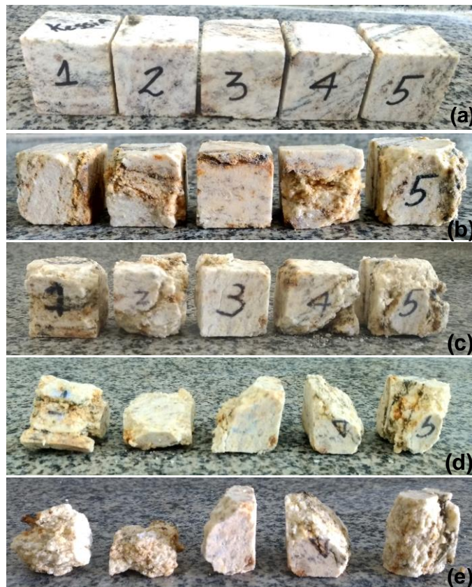
Figura 60: Corpos de prova de gnaiss: (a) Ciclo 0; (b) 10 ciclos; (c) 20 ciclos; (d) 30 ciclos; (e) 40 ciclos.
