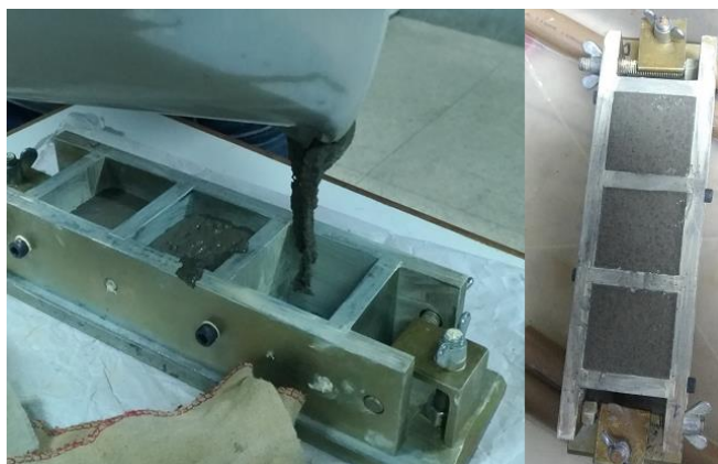
Figura 38: Moldagem dos traços
