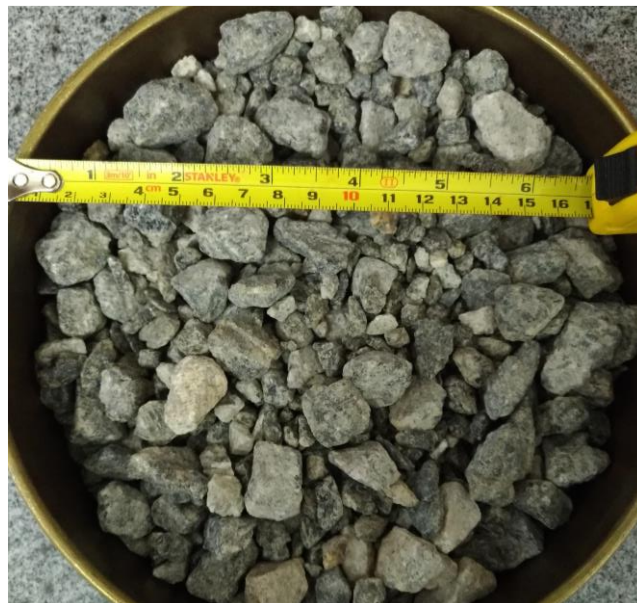
Figura 17: Agregado proveniente do pátio da Pedreira Itereré: Brita 0 e brita 1 (Escala em cm).
