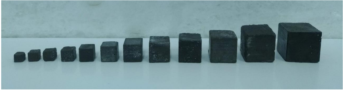
Figura 45: Agregados de concreto de ultra alta performance (4,76mm a 19mm).
