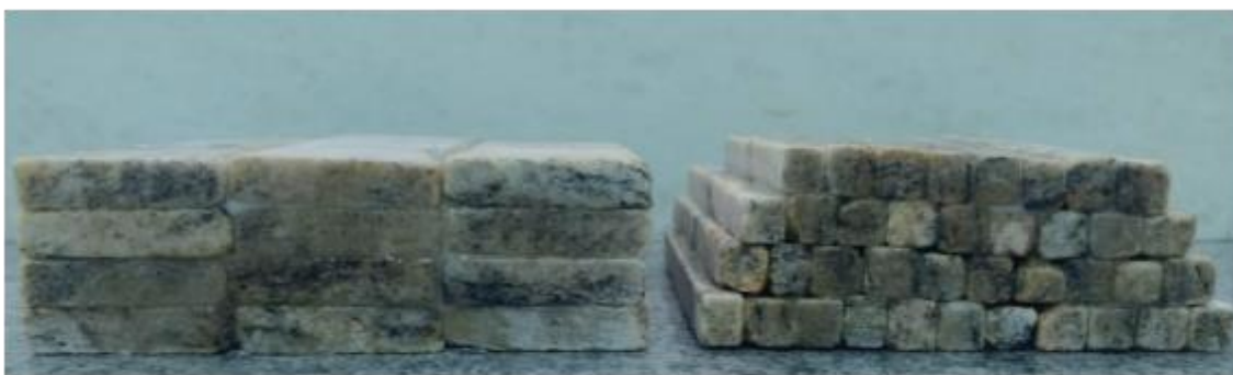
Figura 33: Processo de corte das partículas de material rochoso de menores dimensões.
