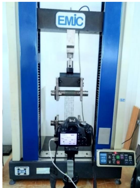
Figura 26: Equipamento para ensaio de tração em geogrelhas – Laboratório de Engenharia Civil (UENF).
