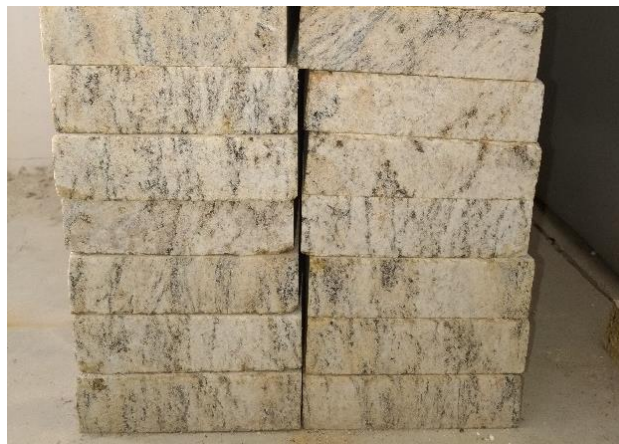
Figura 19: Placas de rocha – Gnaiss proveniente da pedreira Paraíso.
