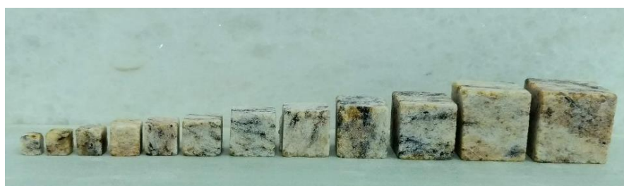
Figura 34: Cubos de material rochoso pós corte (4,76mm a 19mm).
