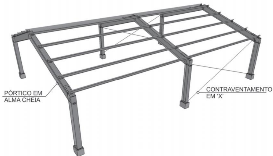
Figura 12: Galpão com colunas e vigas em perfis I
