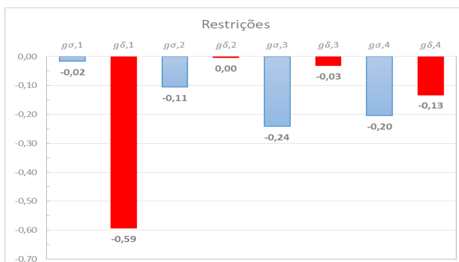
Figura 6.5. Restrições para a solução ótima do modelo semirrígido do primeiro pórtico
