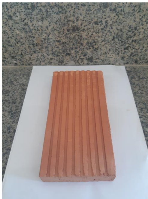
Figura 64 – Exemplo de tijolo com a nova ranhura.
