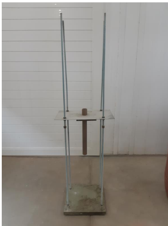
Figura 34 – Lançador vertical de argamassa. Ajustado para 1m de altura de lançamento.
