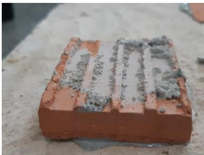
Figura 53 – Bloco cerâmico na ruptura na argamassa utilizando a nova ranhura.
