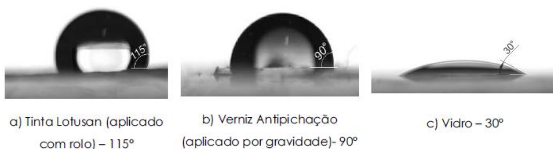
Figura 5 – Medição dos ângulos de contato (adaptado de FLORES et al , 2012).
