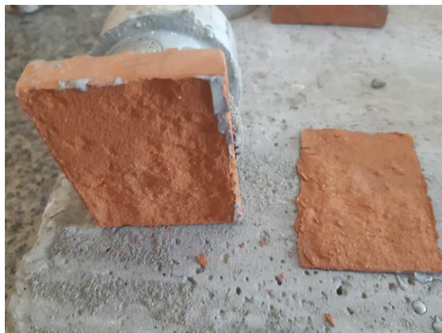
Figura 57 – Ruptura na seção transversal do bloco cerâmico no ensaio de aderência à tração.
