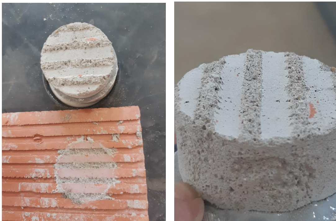
Figura 66 – Ruptura na argamassa no ensaio de aderência à tração nos tijolos fabricados com a nova ranhura em cerâmica.
