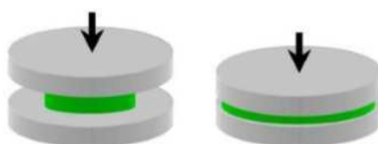
Figura 9 - Esquematização do ensaio de squeeze-flow .
