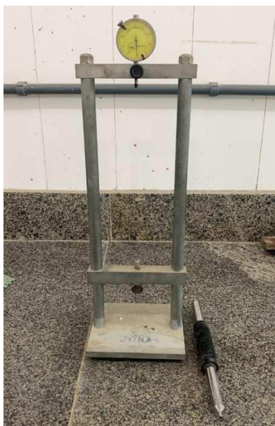
Figura 36 - Equipamento para medição da variação dimensional com bastão de calibração à direita.
