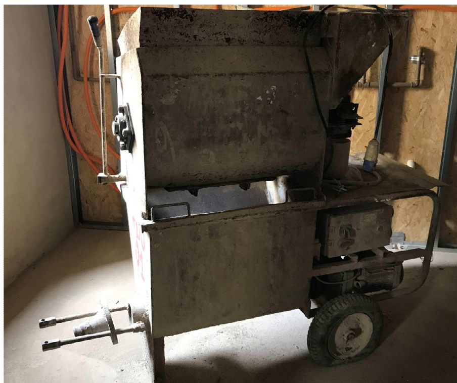
Figura 21 - Equipamento de projeção empregado na obra de referência.
