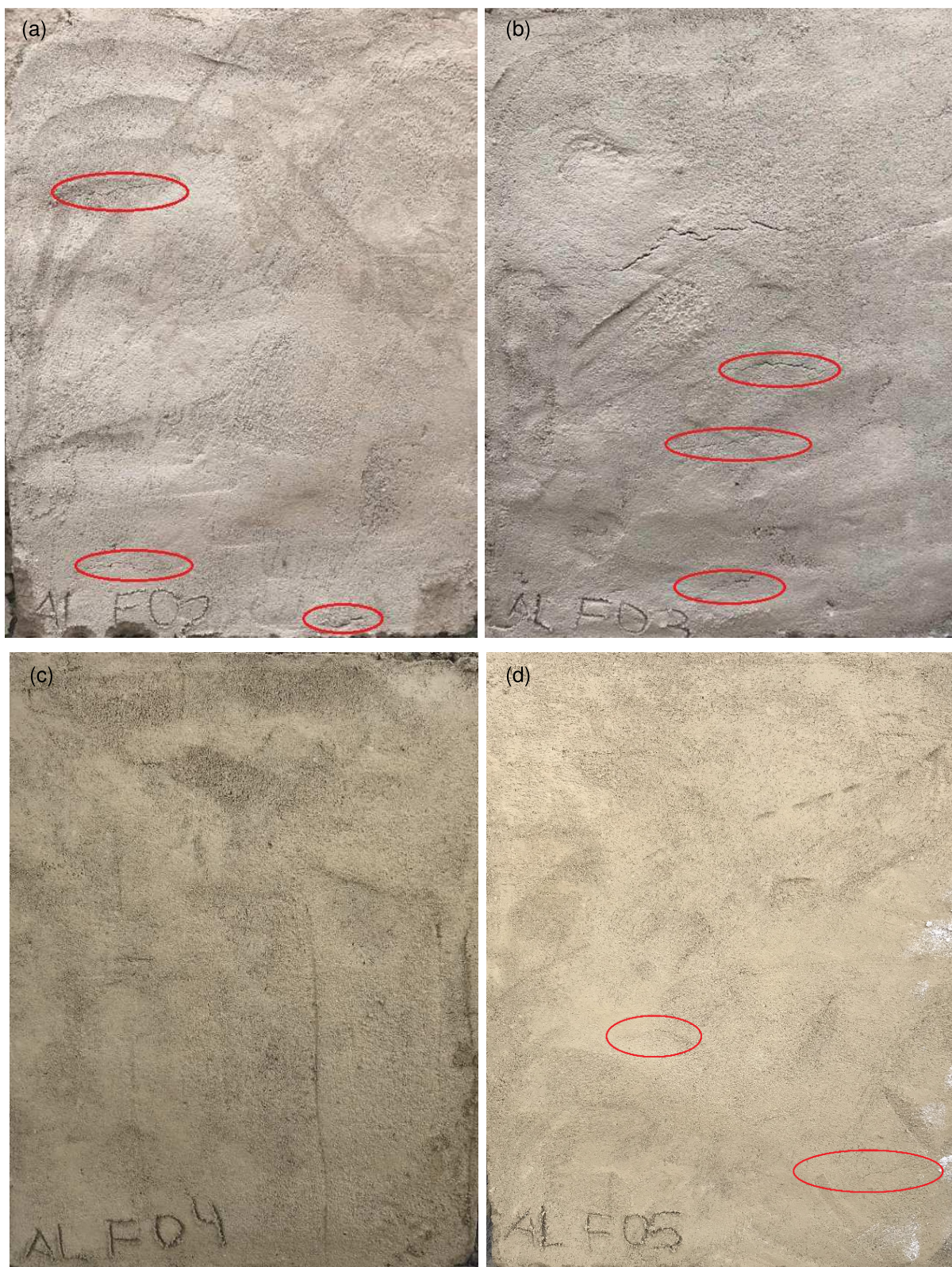
Figura 52 - Corpos de prova para ensaio de aderência à tração e visualização de presença de fissuras. Traços: (a) F02, (b) F03, (c) F04 e (d) F05.
