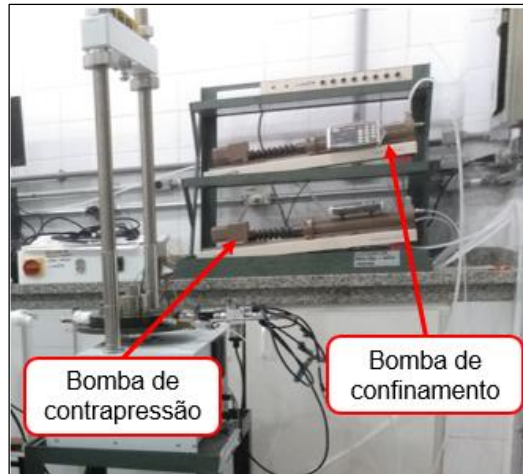
Figura 3.6: Atuadores hidráulicos do triaxial convencional no laboratório da centrifuga geotécnica – UENF.
