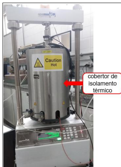
Figura 3.12: Cobertor de isolamento térmico da célula triaxial térmica do laboratório de centrifuga geotécnica – UENF.
