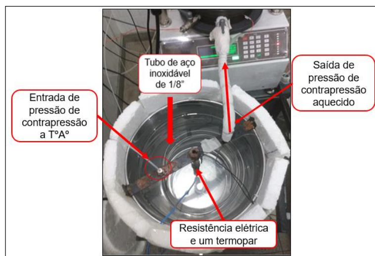
Figura 3.16: Vista por cima do sistema de aquecimento na direção de contrapressão.
