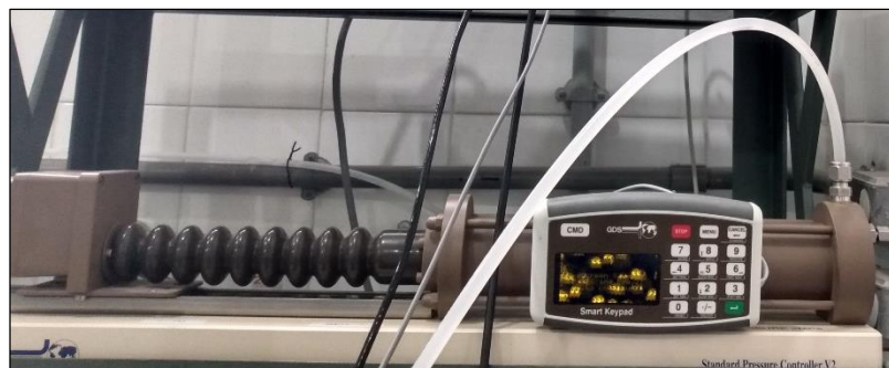
Figura 3.5: Bomba de confinamento do triaxial convencional no laboratório da centrifuga geotécnica (UENF).
