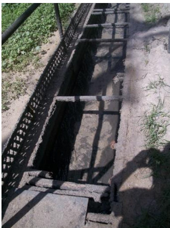
Figura 3-2 - Sistemas de alimentação da caldeira com bagaço. As setas verdes representam o descarte do bagaço e as vermelhas a alimentação da caldeira.
