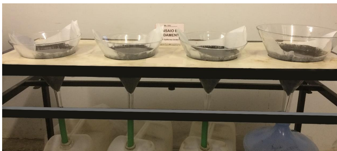
Figura 3-10 - Filtragem da CBCA-2 com água deionizada até a neutralização do pH.
