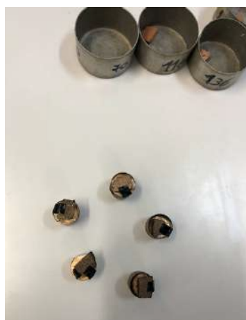
Figura 3.42: Amostras de resinas geopoliméricas e epóxi comercial extraídas da zona de fratura dos corpos-de-prova submetidos a ensaios mecânicos.
