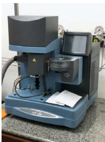
Figura 3.6: Equipamento para análises térmicas: termogravimetria (TGA) e termodiferencial (DTA).
