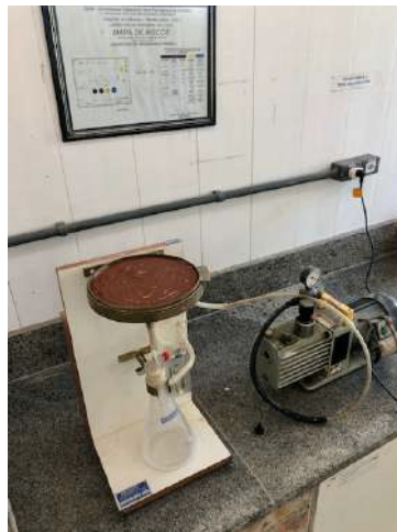
Figura 3.20: Ensaio de retenção de água em resinas geopoliméricas.
