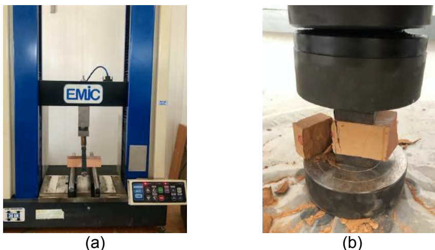
Figura 3.29: Ensaios mecânicos em corpos-de-prova prismáticos: (a) ensaio à tração na flexão; (b) ensaio à compressão axial.
