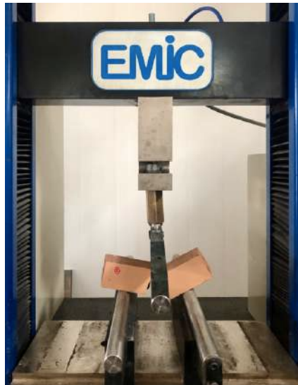
Figura 4.18: Ruptura do corpo-de-prova prismático de resina geopolimérica no ensaio de tração na flexão em 3 pontos.
