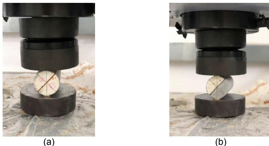
Figura 3.37: Posicionamento dos corpos-de-prova cilíndricos na prensa mecânica com planos de interface inclinados: (a) interface substrato/resina geopolimérica; (b) interface substrato/resina epóxi.
