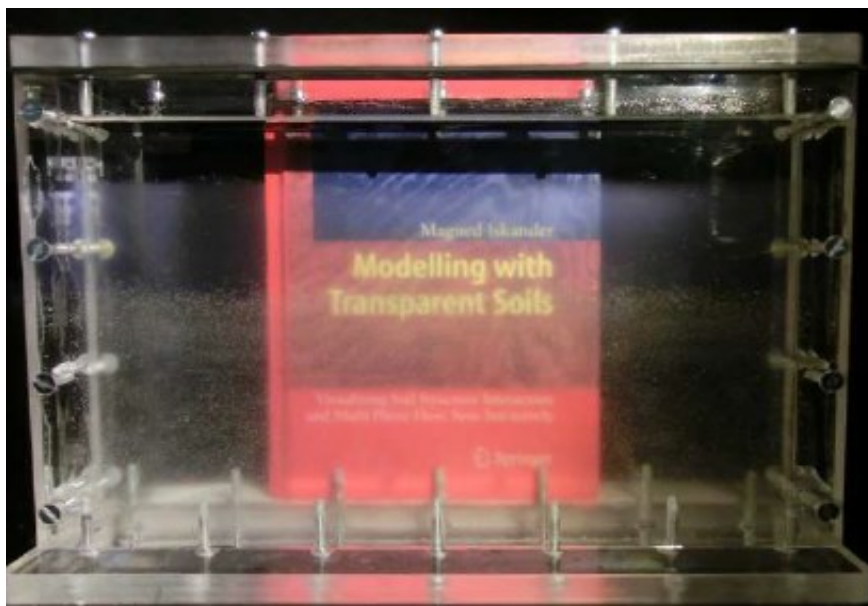
Figura 30 - Capa do livro “ Modelling with transparentsoils” do prof. Magued Iskander visto através de uma espessura de 5 cm de solo transparente feito com quartzo fundido e mistura de óleos minerais.
