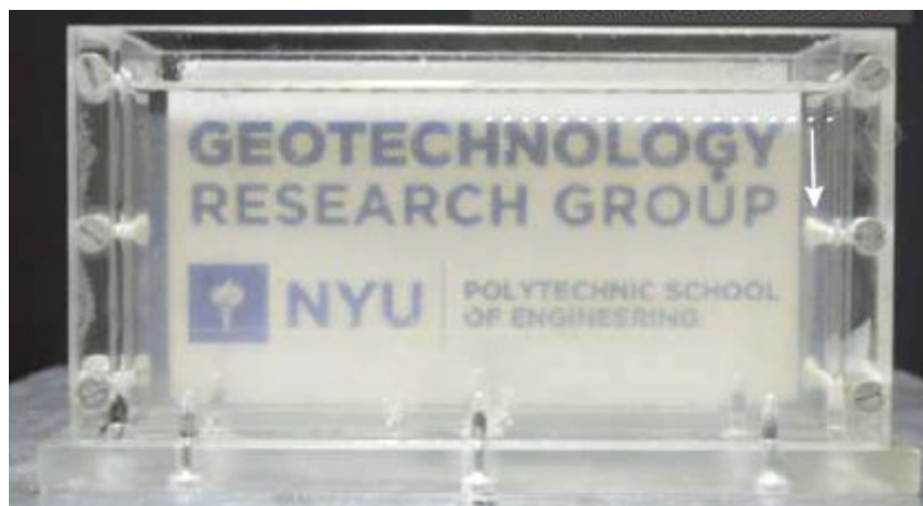
Figura 32 - Logotipo do grupo de geotecnologia da NYU visto a 50 mm de espessura em um container com solo transparente composto de quartzo fundido e solução de água com iodeto de sódio tratado com tiosulfato de sódio, (CARVALHO, 2015).
