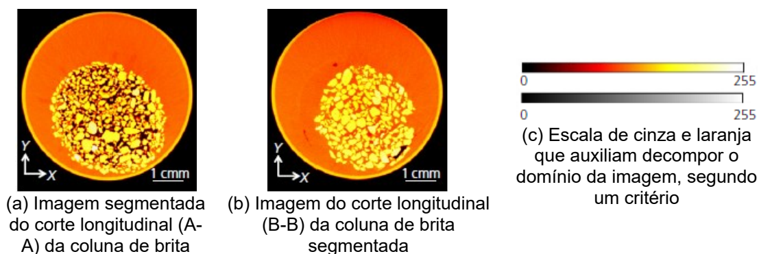
Figura 52 – Ilustrações de imagens segmentadas de colunas de brita modeladas em centrífuga geotécnica, MANHÃES et al. 2016.
