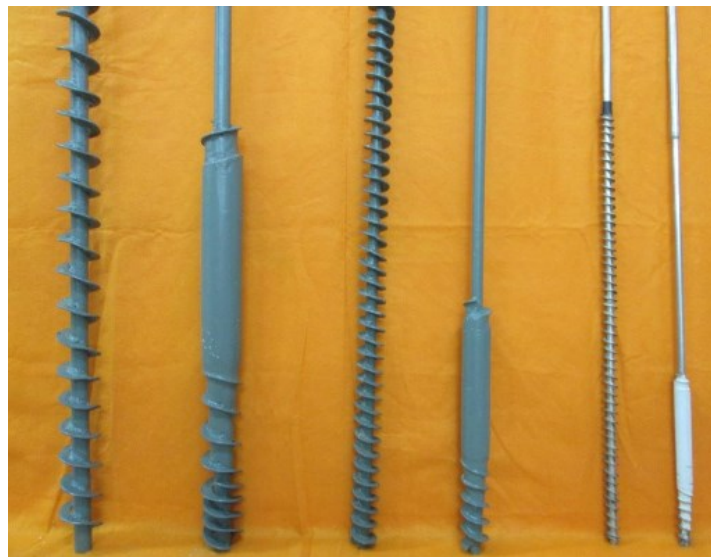
Figura 20 - Modelos reduzidos dos trados de hélice contínua e ômega, PESSANHA et al. (2014).
