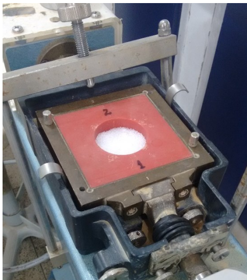
Figura 79 – Preparação da Sílica Gel seca na caixa de cisalhamento circular para iniciar a etapa de consolidação.
