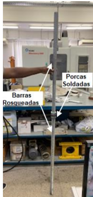
Figura 26 - Esquema das Barras rosqueadas presas por Porcas Soldadas
