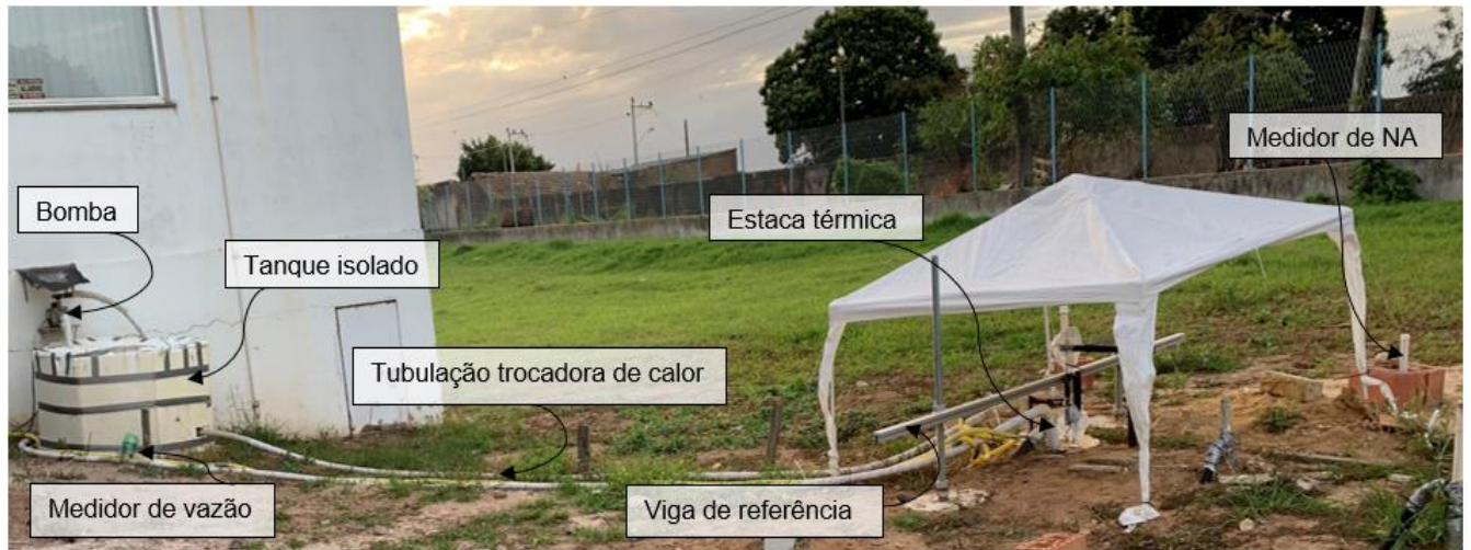
Figura 34- Disposição final dos equipamentos para o ensaio.
