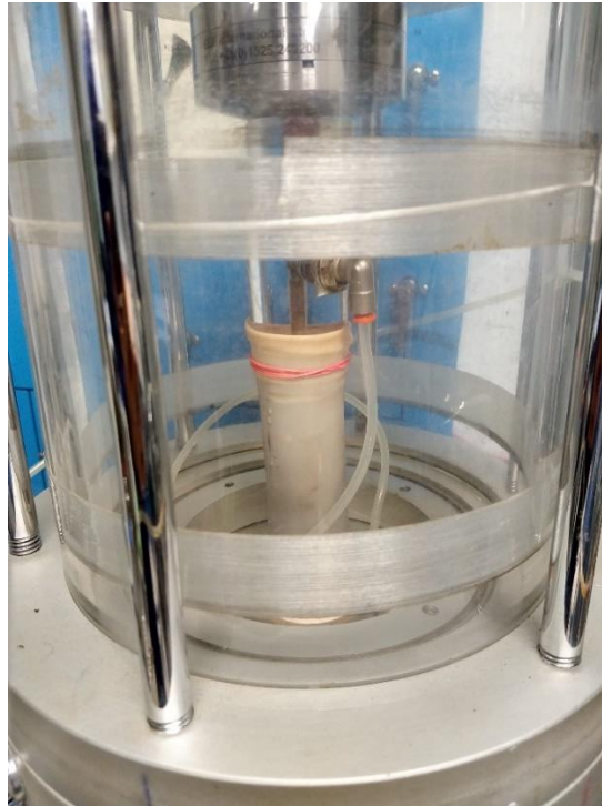
Figura 4.22 - Corpo de prova pronto para ser ensaiado no aparelho triaxial Bishop-Wesley da PUC-Rio.
