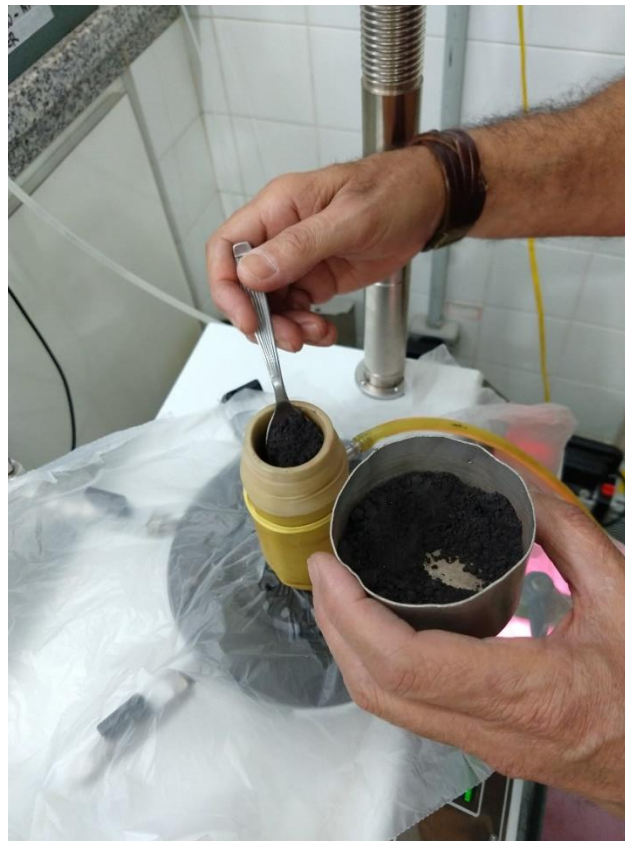
Figura 4.8 – Moldagem do corpo de prova na condição fofa para os triaxiais convencionais.
