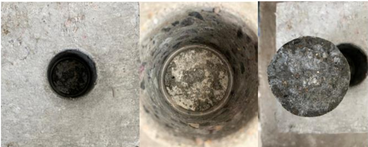
Figura 3.31 - Ruptura de um corpo-de-prova pull-off na interface.
