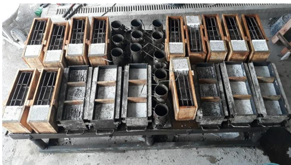
Figura 3.18 - Formas do push-off e pull-off antes de ser concretado o complemento.
