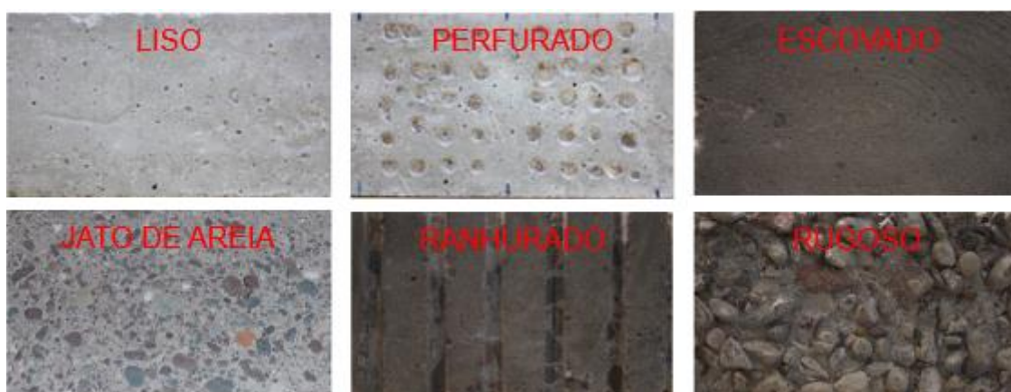
Figura 2.25 - Rugosidades do substrato do concreto normal de Carbonell Muñoz et al. (2014).
