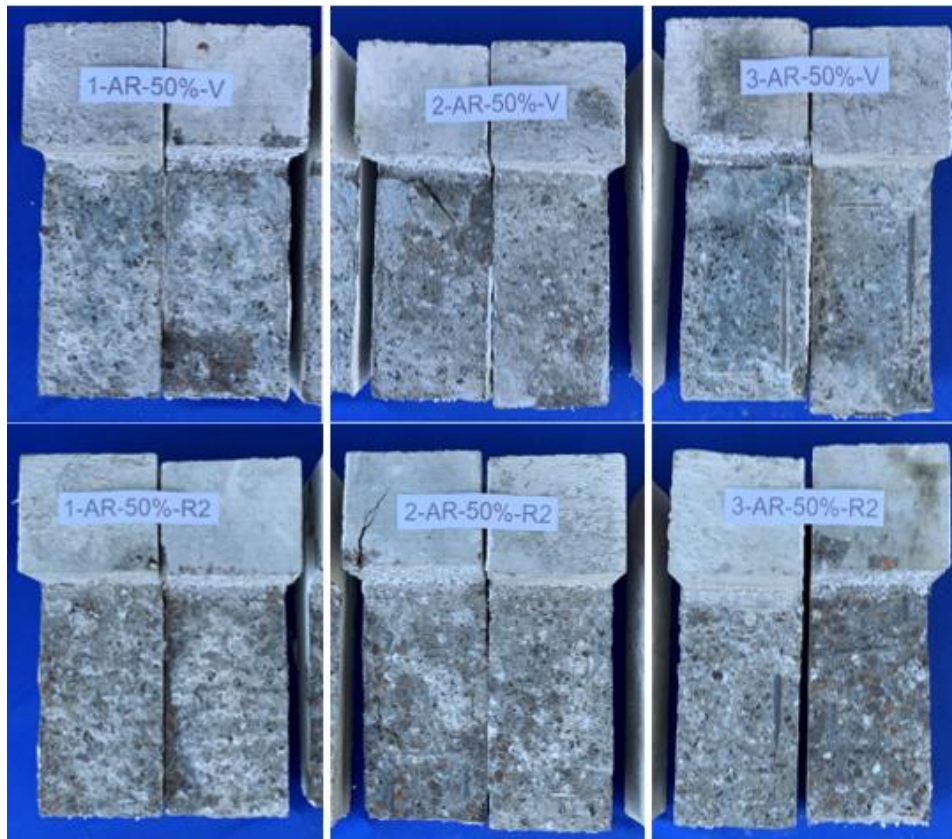
Figura 4.62 - Corpos-de-prova da série AR-50% do tipo push-off após ruptura.
