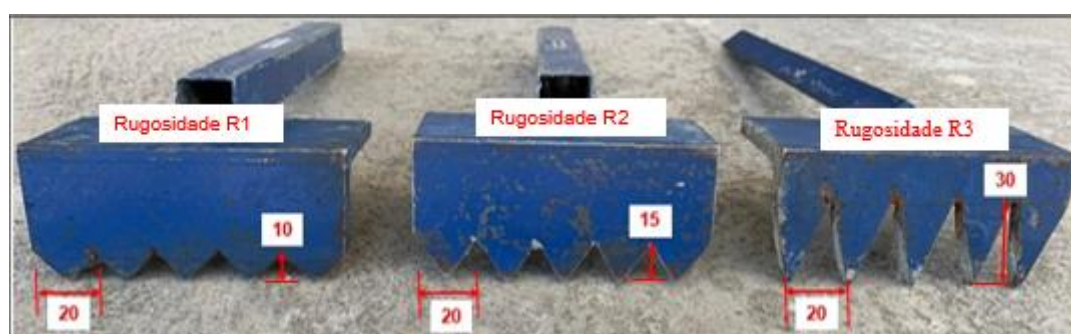
Figura 3.13 - Instrumento de indução das interfaces rugosas (R1, R2 e R3). Dimensões em mm.
