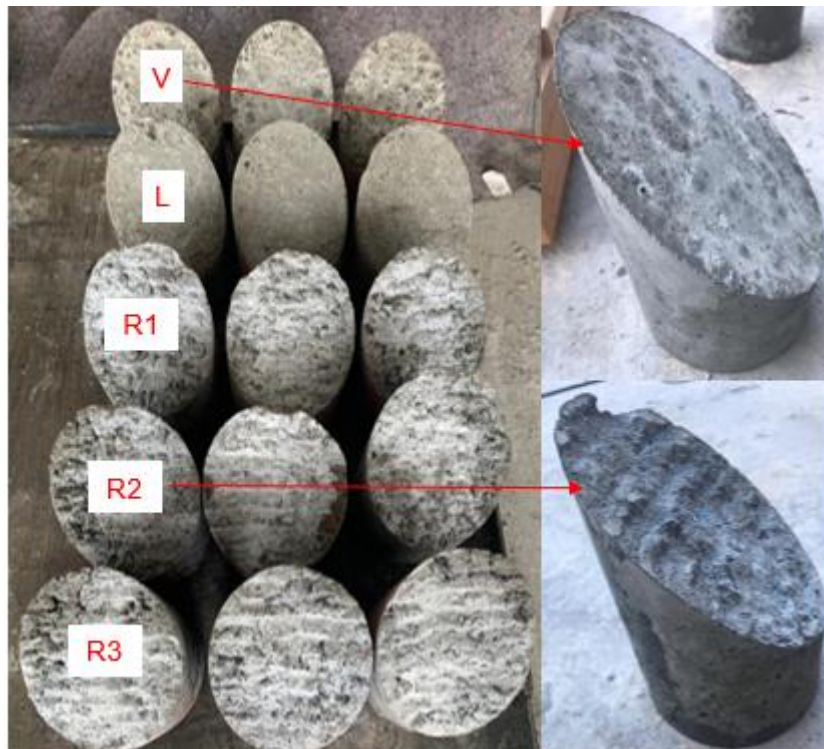
Figura 3.14 - Superfície da interface dos corpos-de-prova slant shear .
