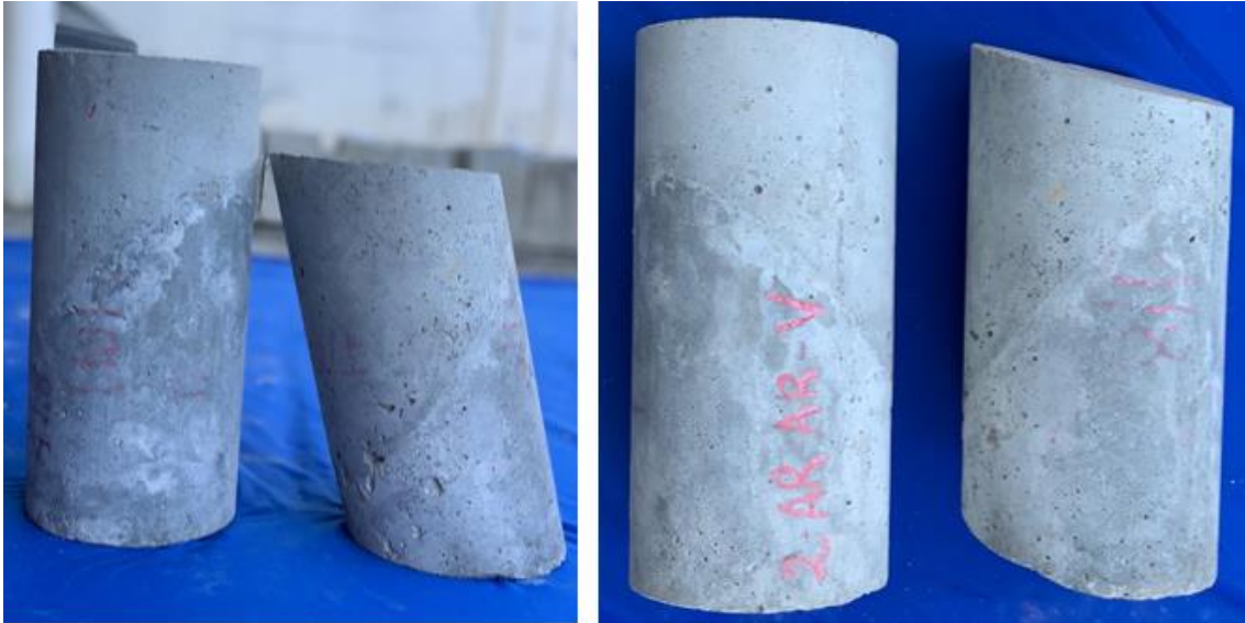
Figura 3.26 - Corpos-de-prova para o ensaio slant shear original e modificado.
