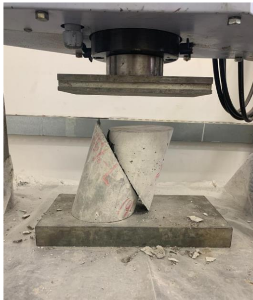
Figura 3.27- Ensaio de corpos-de-prova do tipo slant shear modificado com ruptura pela interface.
