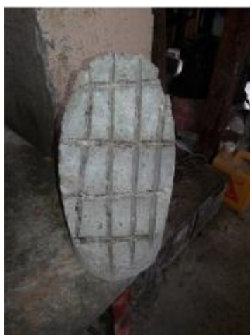
Figura 2.27 - Configuração do corpo-de-prova do tipo slant shear (Diab,2017).
