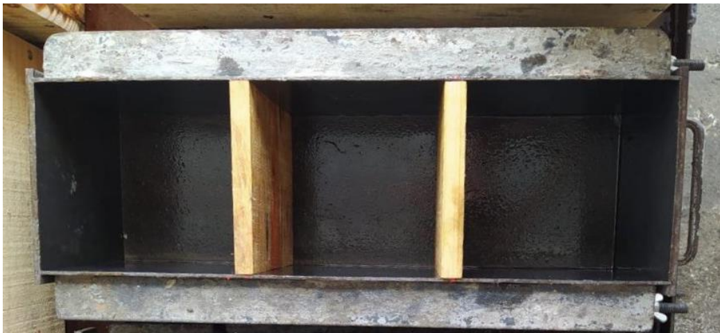
Figura 3.8 - Forma metálica para produção dos corpos-de-prova para o ensaio do tipo pull-off .
