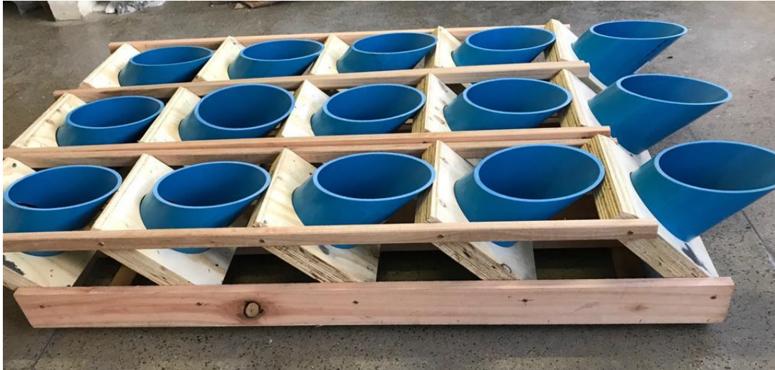
Figura 3.7 - Formas de policloreto de vinil (PVC) para a concretagem da primeira metade dos corpos-de-prova do tipo slant shear .
