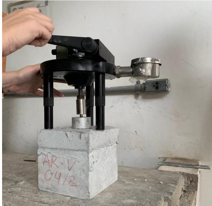
Figura 3.30 - Processo de execução do ensaio do tipo pull-off .
