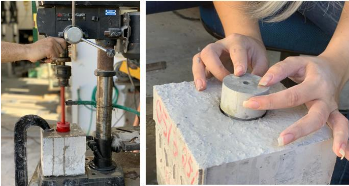
(a) (b) Figura 3.29 - Procedimentos prévios para a execução do ensaio do tipo pull-off: a) execução do carote; b) colagem do disco.
