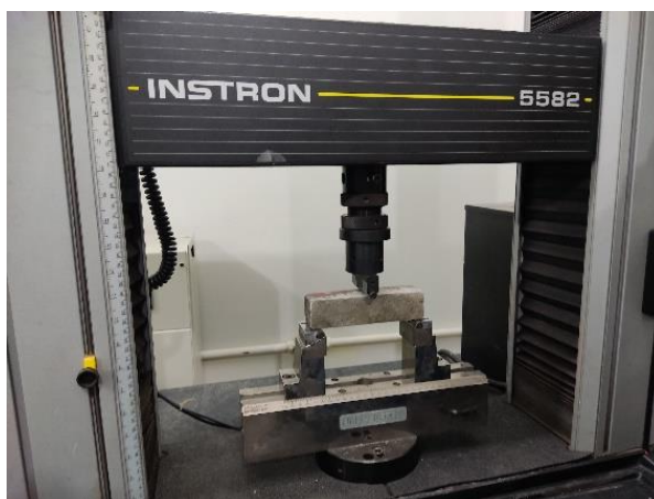
Figura 3.15: Corpo de prova prismático durante o ensaio de tração na flexão.
