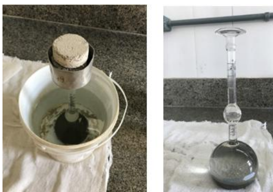
Figura 3.4: Ensaio de Le Chatelier
