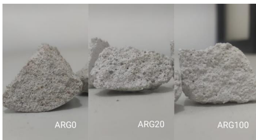
Figura 4.1: Presença de poros abertos nas argamassas.
