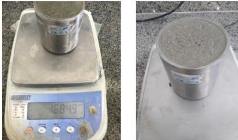
Figura 3.9: Ensaio para determinação da densidade das argamassas no estado fresco.
