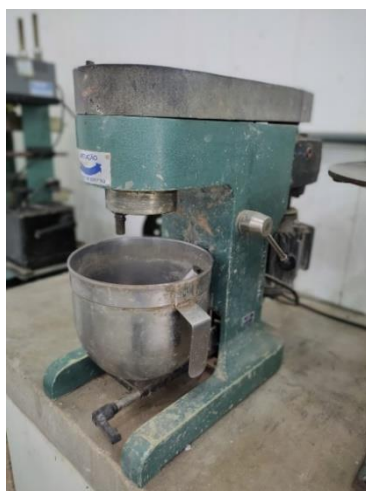
Figura 3.5: Misturador de bancada utilizado na confecção das argamassas.
