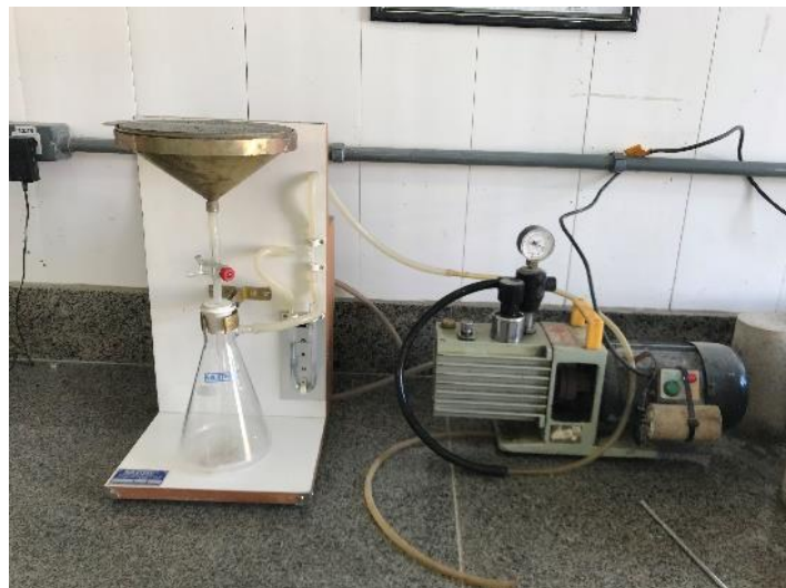
Figura 3.10: Funil de Buchner modificado acoplado à bomba de vácuo.
