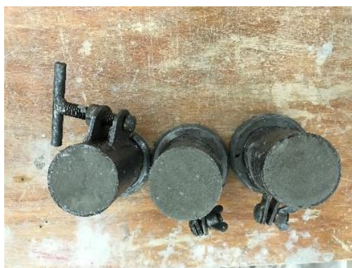
Figure 3.12:Corpos de prova para determinação das resistências à compressão e à tração por compressão diametral.
