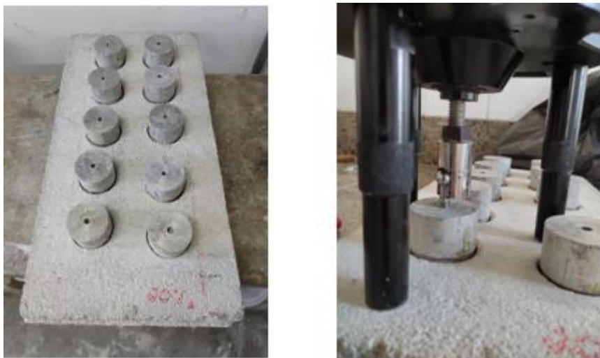
Figura 3.14: Argamassa com pastilhas metálicas coladas para determinação da resistência potencial de aderência à tração.
