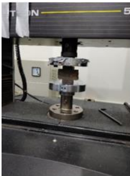
Figura 3.16: Corpo de prova durante o ensaio de compressão.
