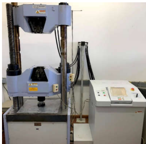
Figura 31: Prensa Shimadzu UH-F500kNI para execução de ensaio de resistência à compressão.
