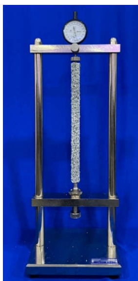
Figura 34: Leitura da variação dimensional dos corpos de prova prismáticos.
