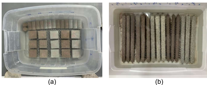
Figura 33: Exposição dos corpos de prova ao ataque ácido: cúbicos e cilíndricos (a); prismáticos (b)
