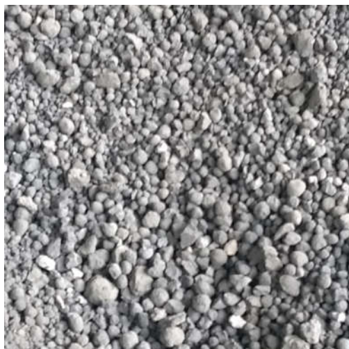
Figura 8: Nódulos de clínquer obtidos para a pesquisa.
