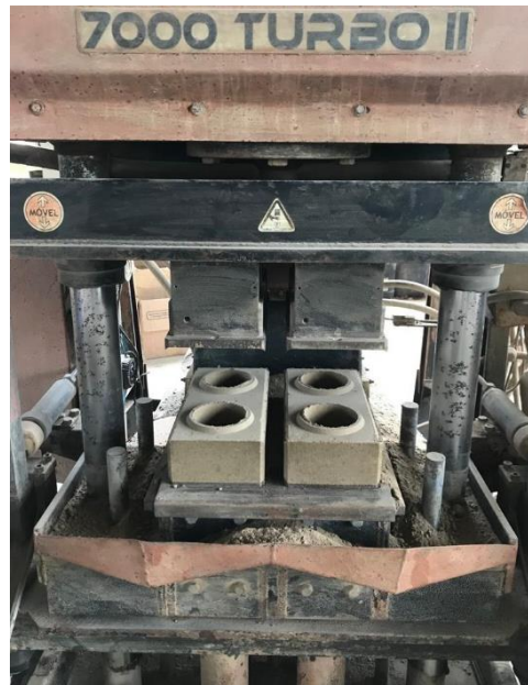
Figura 3-9 - Prensa hidráulica utilizada na pesquisa para fabricação de tijolos de solo-cimento
