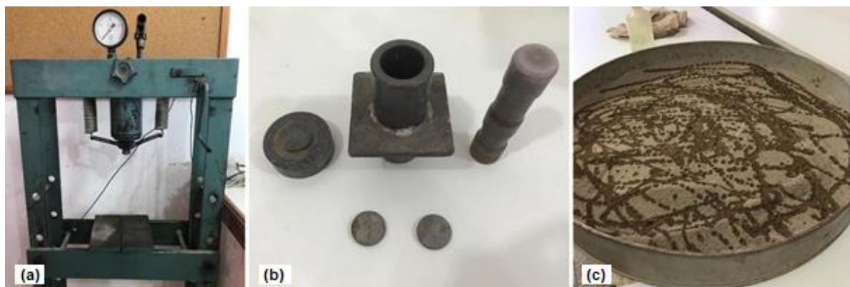
Figura 3-5 - Procedimentos e equipamentos utilizados para mistura e moldagem os CPs
