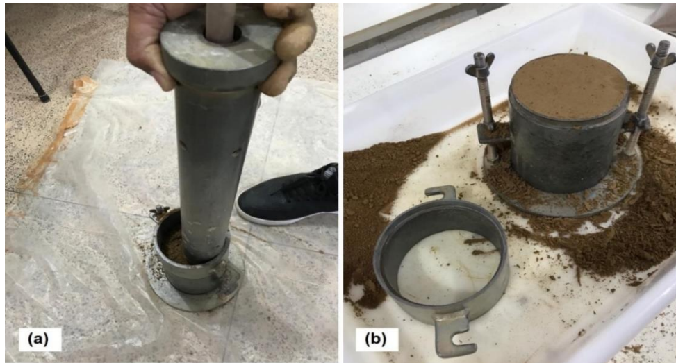
Figura 3-2 - Execução do ensaio de compactação Proctor normal
