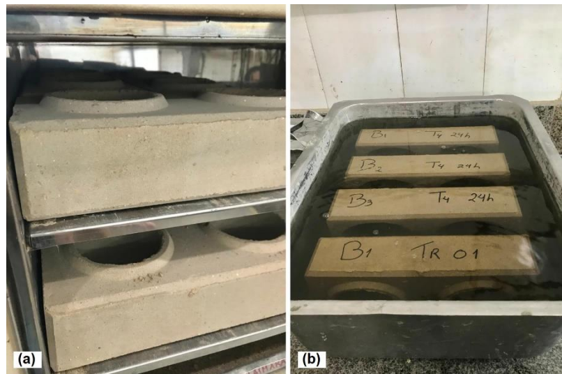
Figura 3-12 - Procedimentos do ensaio de absorção de água
