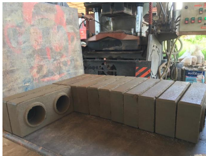
Figura 2-5 - Tijolo de solo-cimento com as mesmas dimensões que serão produzidas na pesquisa
