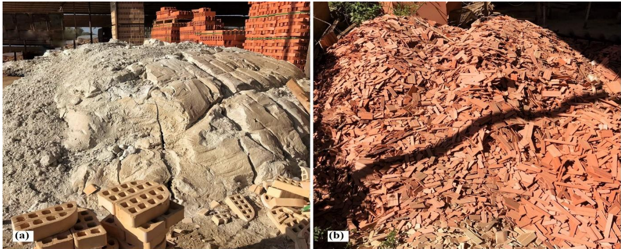
Figura 2-1 - Resíduos da construção civil, em (a) resíduo proveniente de rocha e em (b) resíduo cerâmico
