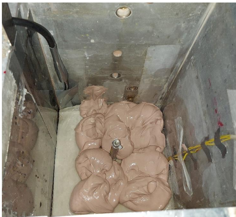
Figura 3.21 – Lançamento do solo em um dos compartimentos da caixa de teste.
