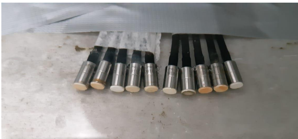
Figura 3.11 – Transdutores de poropressão posicionados para calibração.
