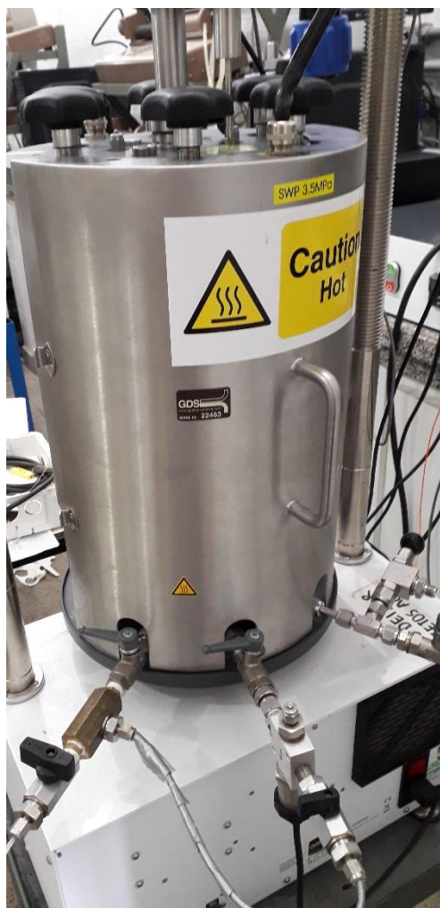
Figura 3.6 – Cobertor de isolamento térmico evolto na célula triaxial térmica.
