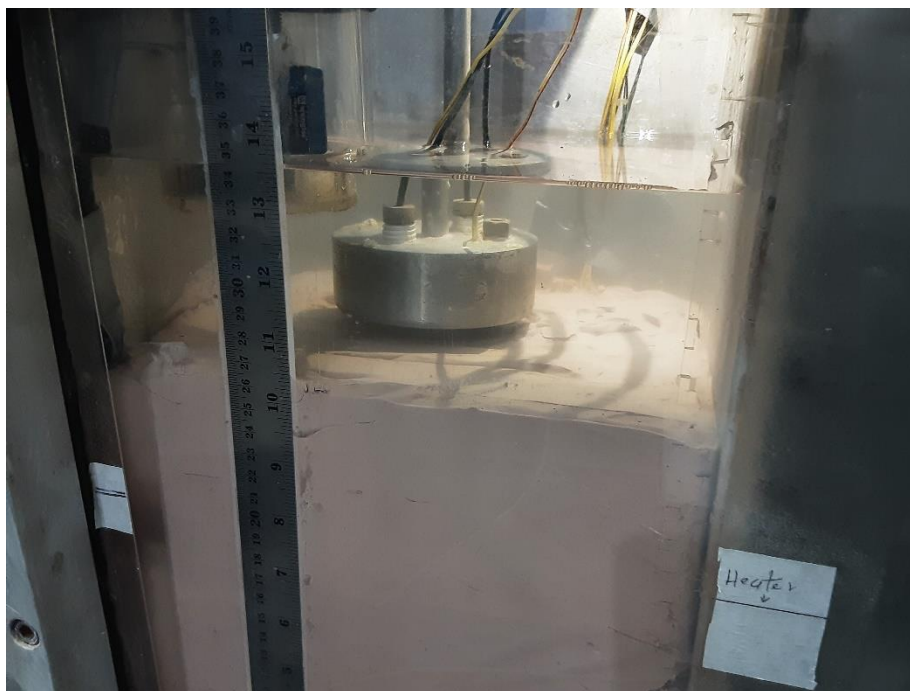
Figura 3.25 – Vista lateral da fundação posicionada antes da cravação.
