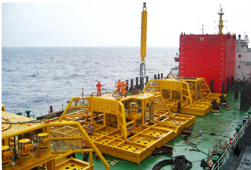
Figura 1.2 – Equipamentos de interligação PLEM apoiados em mudmats sobre uma embarcação. (Fonte: https://www.cranemaster.com/ )
