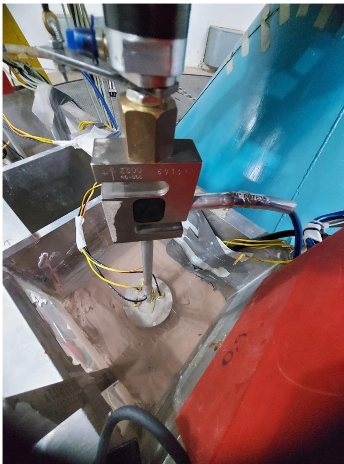
Figura 3.23 – Detalhe da célula de carga e fundação conectadas pela haste (vista superior).
