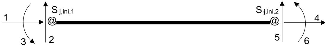
**Figura 3.6:** Elemento com ligações semirrígidas (Chen, 2000).
