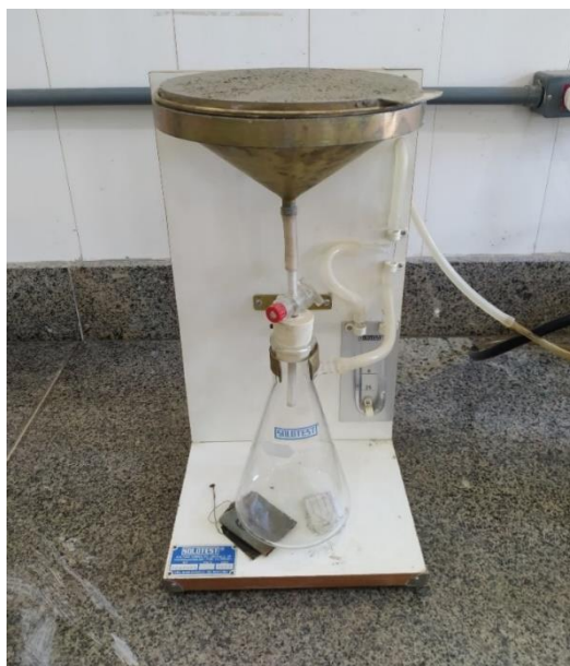
Figura 25: Dispositivo para ensaio de retenção de água.
