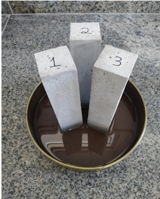
Figura 27: Ensaio de absorção de água por capilaridade.
