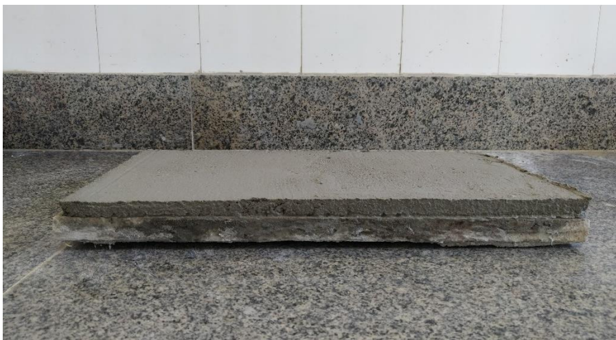
Figura 28: Substrato de concreto com argamassa para ensaio de aderência à tração.
