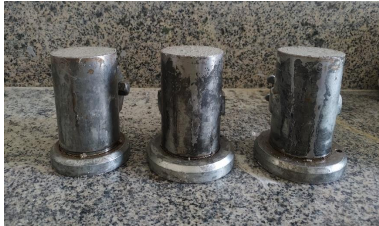
Figura 17: Fôrmas cilíndricas de 100 mm de altura e 50 mm de diâmetro.
