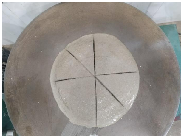
Figura 16: Espalhamento da argamassa na mesa de consistência.
