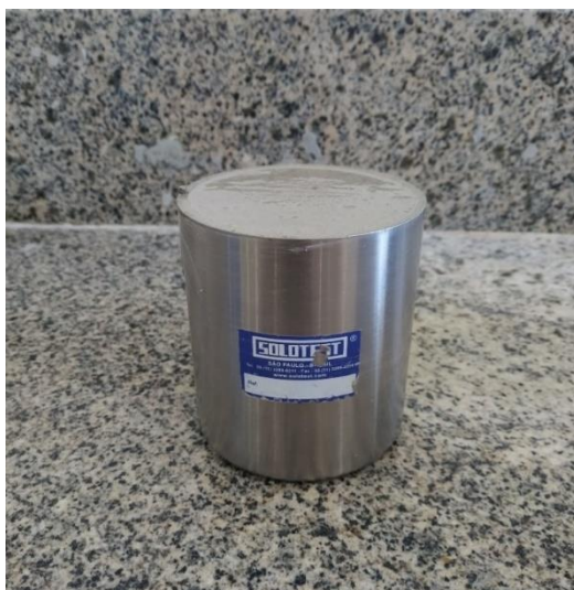
Figura 23: Recipiente metálico, com argamassa, utilizado para determinar a densidade de massa no estado fresco.
