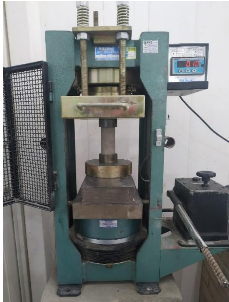
Figura 19: Corpo de prova posicionado na prensa para o ensaio de compressão axial.
