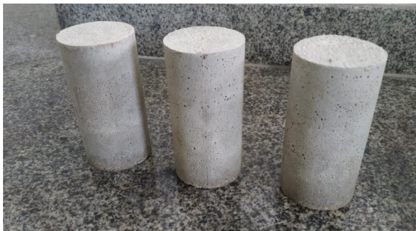
Figura 18: Corpos de prova em cura ambiente de laboratório
