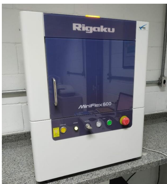
Figura 9: Difratômetro de raios X modelo MiniFlex 600, da marca Rigaku
