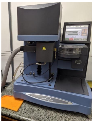
Figura 11: Equipamento para análise termogravimétrica
