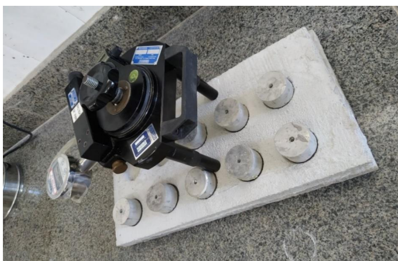
Figura 30: Ensaio de aderência à tração.
