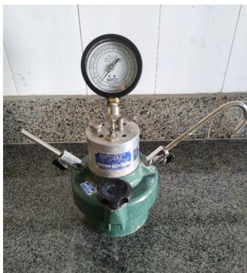
Figura 24: Recipiente para ensaio de teor de ar incorporado.
