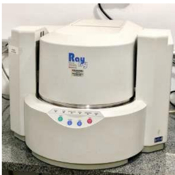
Figura 15: Espectrômetro de fluorescência de raios X.
