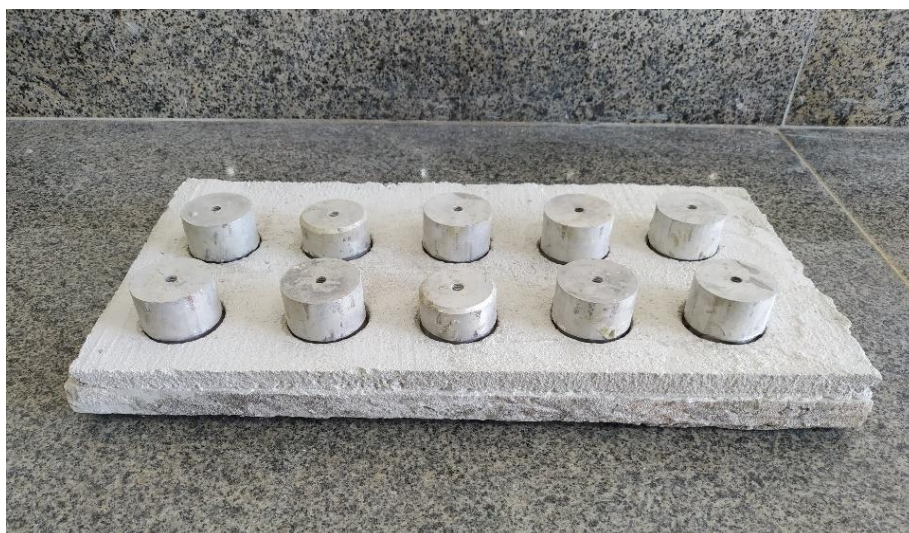
Figura 29: Pastilhas metálicas para o ensaio de aderência à tração.
