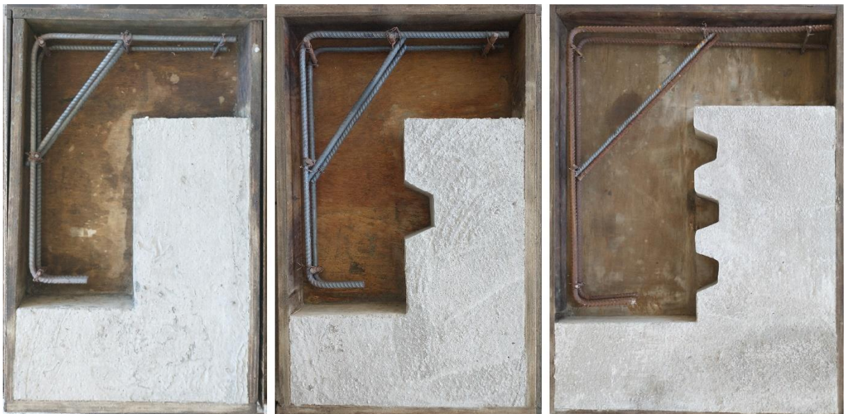
Figura 32 - Segunda etapa da concretagem dos corpos-de-prova com dentes de cisalhamento.
