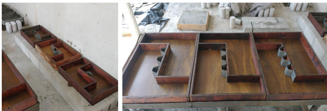
Figura 28 - Fôrmas de madeira para produção dos corpos-de-prova.
