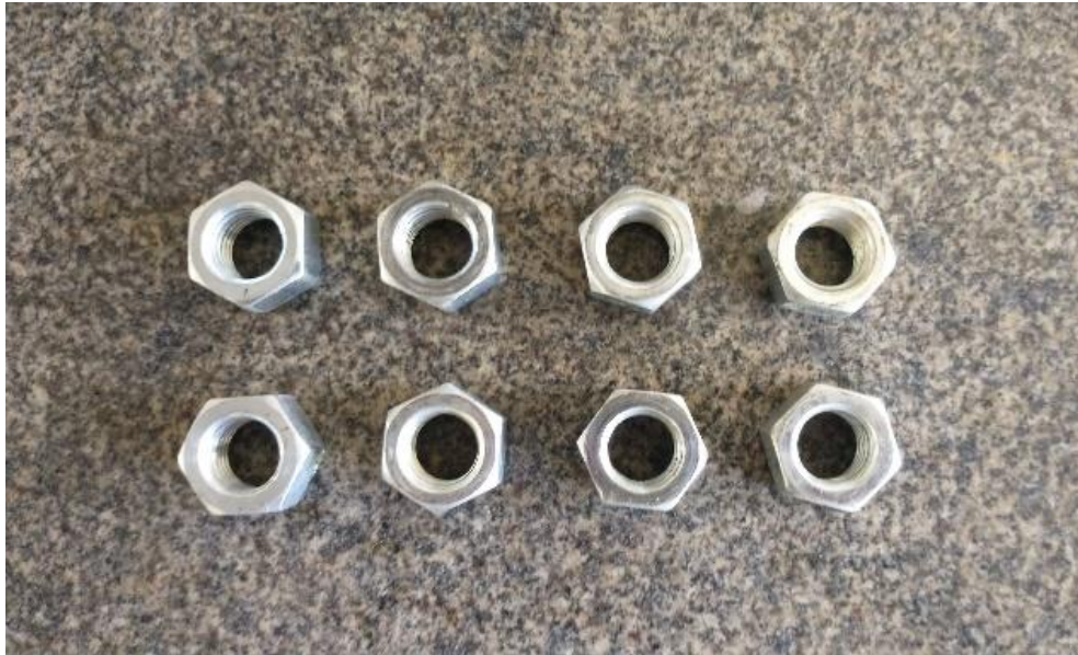
Figura 41 - Porcas de aço compatíveis com as barras de aço de 15 mm utilizadas no sistema de confinamento.
