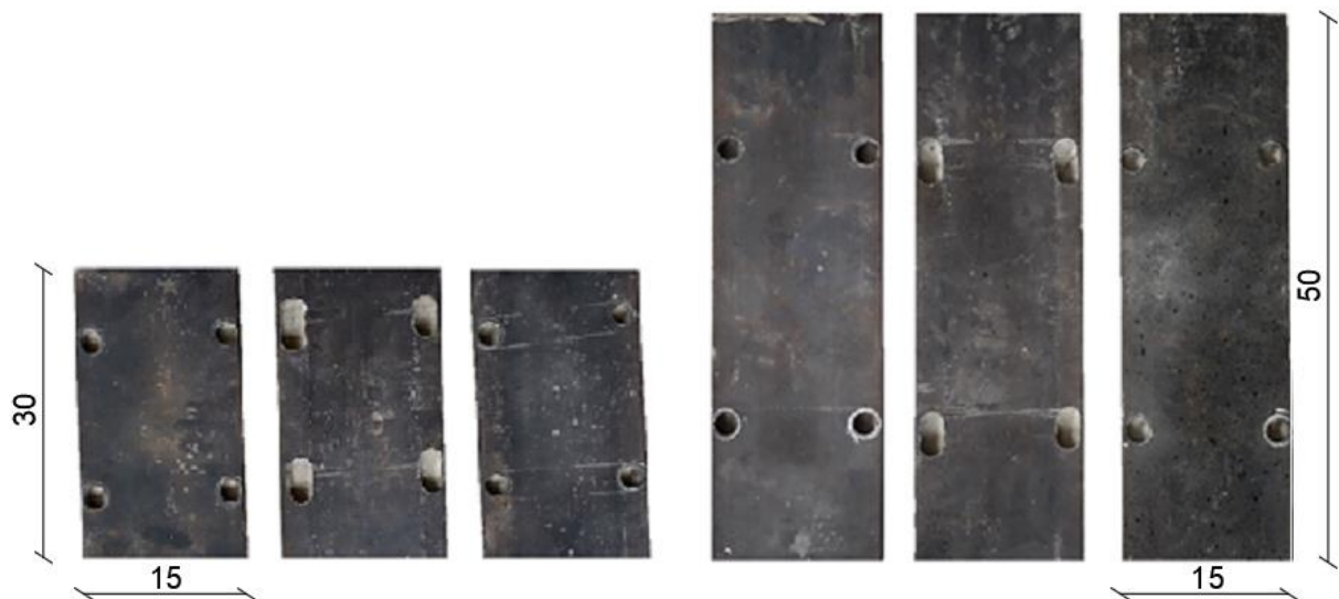
Figura 42 - Chapas de aço utilizadas no sistema de confinamento (unidades em cm).
