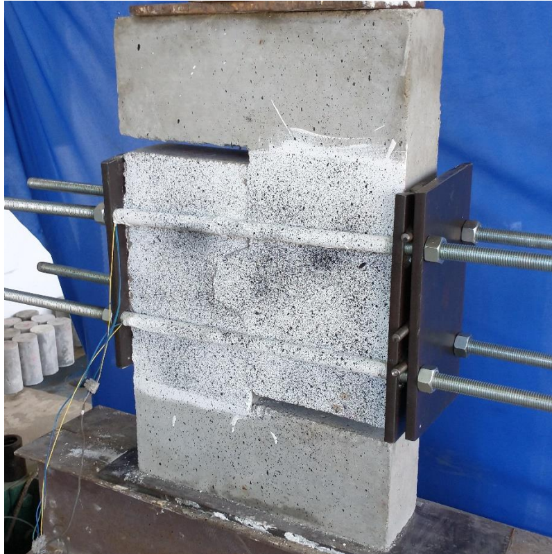
Figura 45 - Sistema de confinamento instalado em um corpo-de-prova de junta seca com um dente de cisalhamento.
