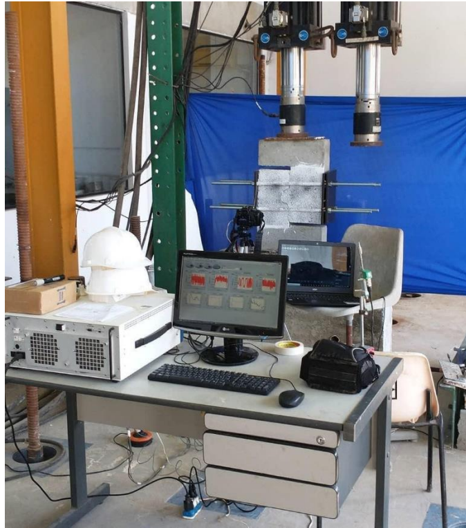
Figura 46 - Ensaio push-off das juntas secas de concreto com agregados graúdos reciclados em conjunto com a análise CID.
