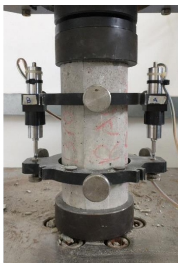
Figura 36 - Ensaio para a determinação do módulo de elasticidade do concreto.
