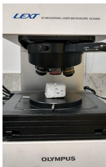
Figura 37 - Ensaio de microscopia da superfície do concreto com agregados graúdos reciclados.
