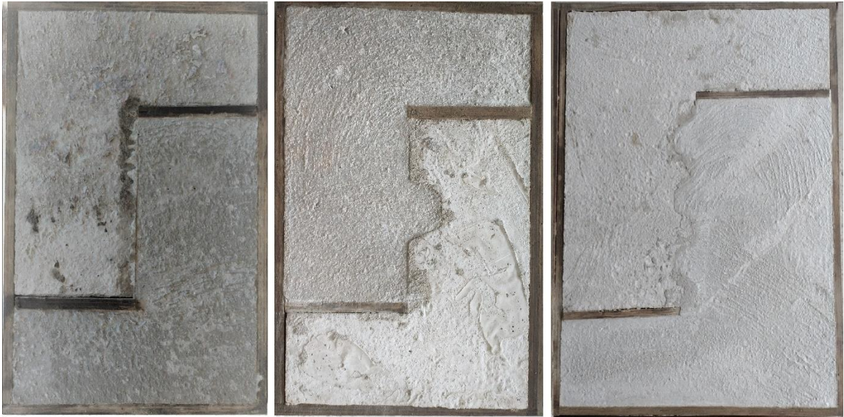
Figura 33 – Garantia do perfeito encaixe entre os dentes de cisalhamento.
