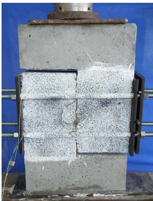
Figura 74 – Corpo-de-prova de junta seca com um dente de cisalhamento rompido.
