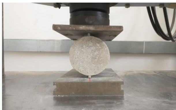
Figura 35 - Ensaio de resistência à tração por compressão diametral por compressão diametral.
