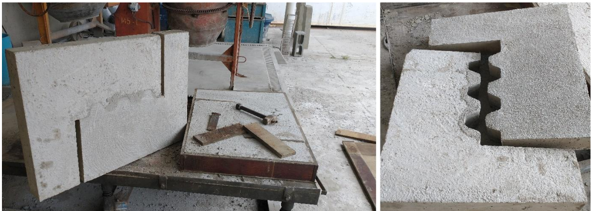
Figura 34 - Desmoldagem e separação das duas partes da junta seca com dentes de cisalhamento.
