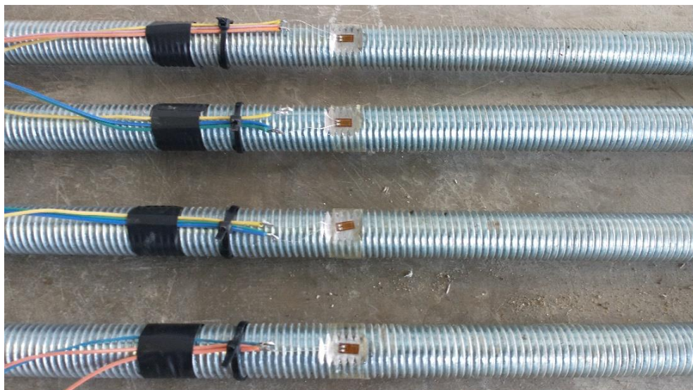
Figura 40 - Barras de aço rosqueadas instrumentadas com strain gauges .
