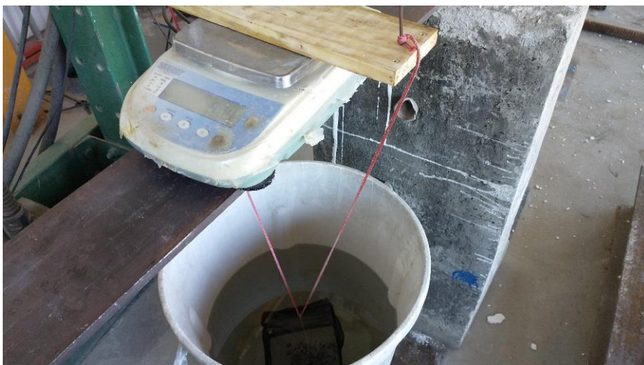
Figura 25 - Ensaio de massa específica real e massa específica unitária dos agregados reciclados.
