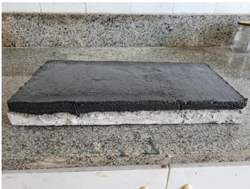
Figura 3.29: Substrato preenchido com a argamassa AD100.
