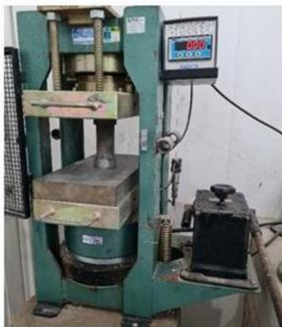
Figura 3.18: Corpo de prova posicionado na prensa hidráulica para o ensaio de compressão.
