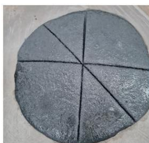
Figura 3.14: Espalhamento da argamassa AD100 na mesa para determinação do índice de consistência padrão.
