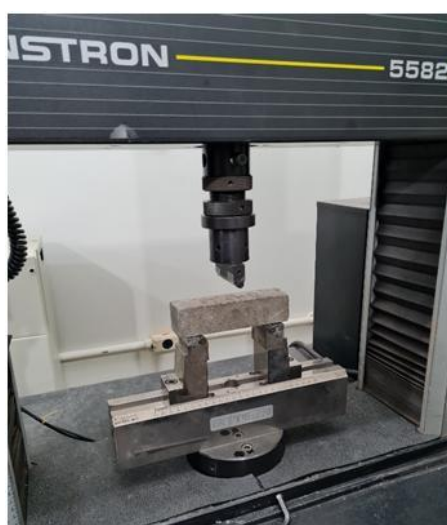
Figura 3.26: Ensaio de resistência à tração na flexão em 3 pontos.
