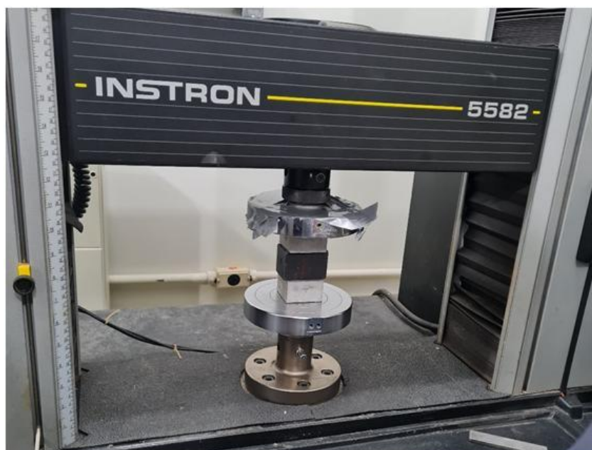
Figura 3.27: Ensaio de resistência à compressão axial.
