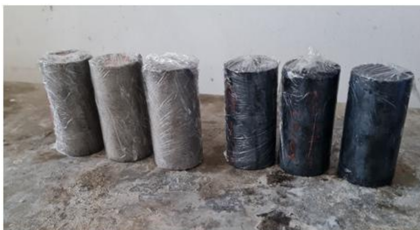
Figura 3.24: Envolvimento dos corpos de prova com filme de PVC.
