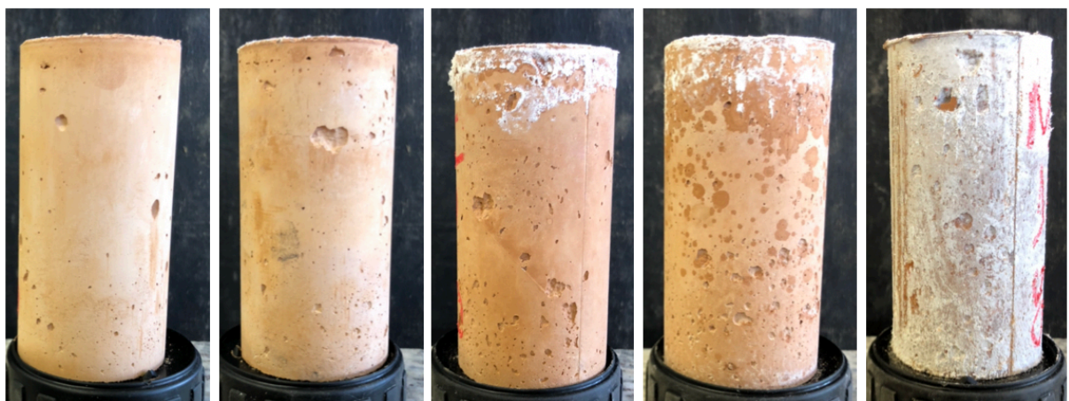
Figura 34: Argamassas com 100% de metacaulim curadas a 80°C - cinco concentrações: 6, 8, 10, 12,5 e 15 mol/litro, da esquerda para a direita, respectivamente.
