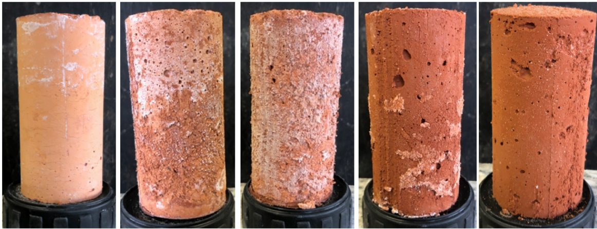
Figura 37: Argamassas com 100% de RTM curadas a 80°C - cinco concentrações: 6, 8, 10, 12,5 e 15 mol/litro, da esquerda para a direita, respectivamente.
