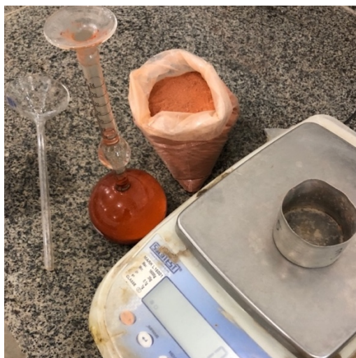
Figura 14: Ensaio para determinação da massa específica real do RTM.
