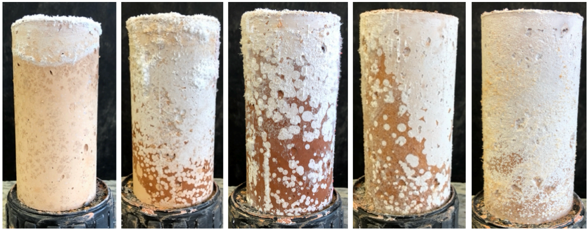
Figura 32: Argamassas com 100% de metacaulim curadas em temperatura ambiente - cinco concentrações: 6, 8, 10, 12,5 e 15 mol/litro, da esquerda para a direita, respectivamente.
