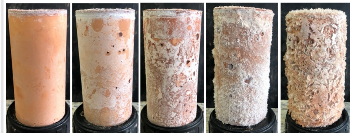
Figura 39: Argamassas com 50% de MC + 50% de RTM curadas a 60°C - cinco concentrações: 6, 8, 10, 12,5 e 15 mol/litro, da esquerda para a direita, respectivamente.
