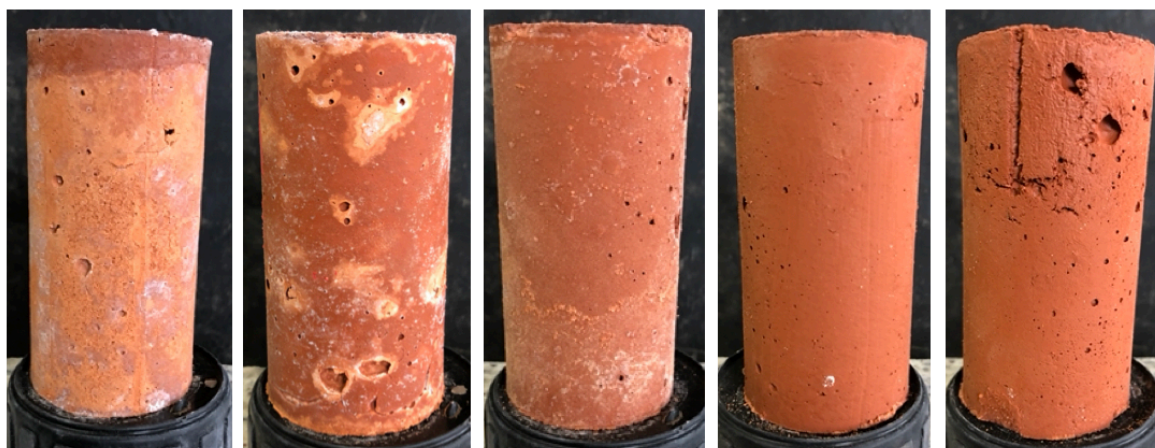
Figura 36: Argamassas com 100% de RTM curadas a 60°C - cinco concentrações: 6, 8, 10, 12,5 e 15 mol/litro, da esquerda para a direita, respectivamente.
