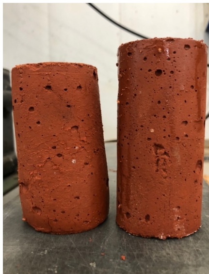
Figura 45: Estado plástico dos corpos de prova RTM-100%-12,5-A.
