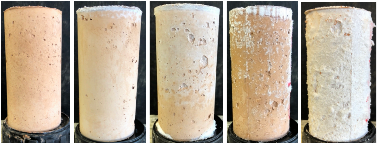
Figura 33: Argamassas com 100% metacaulim curadas a 60°C - cinco concentrações: 6, 8, 10, 12,5 e 15 mol/litro, da esquerda para a direita, respectivamente.
