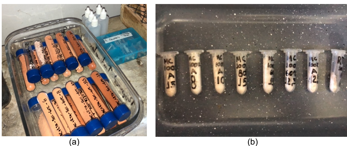
Figura 60: Amostras para TG: (a) argamassas MC-100% e RTM-100%; (b) eflorescência.
