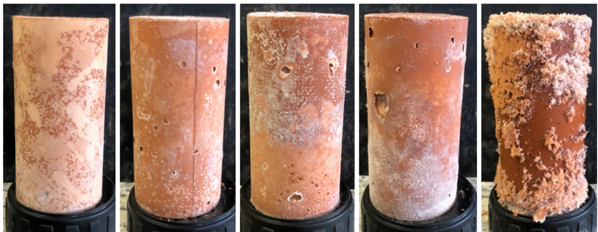
Figura 38: Argamassas com 50% de MC + 50% de RTM curadas em temperatura ambiente - cinco concentrações: 6, 8, 10, 12,5 e 15 mol/litro, da esquerda para a direita, respectivamente.
