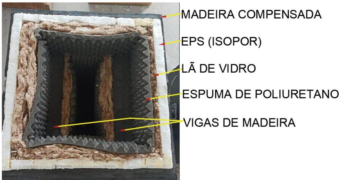
Figura 52 - Vista superior da câmara acústica e seus materiais constituintes
