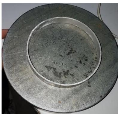
Figura 28 - Molde cilíndrico para ensaio *squeeze flow*
