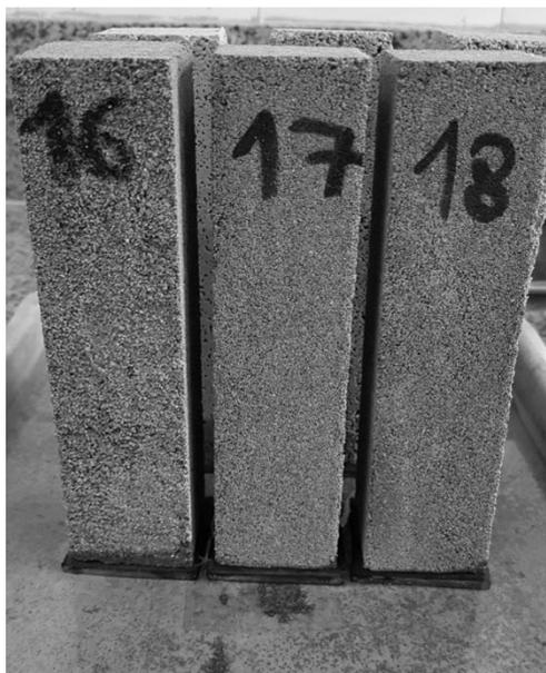
Figura 40 - Ensaio de absorção de água por capilaridade
