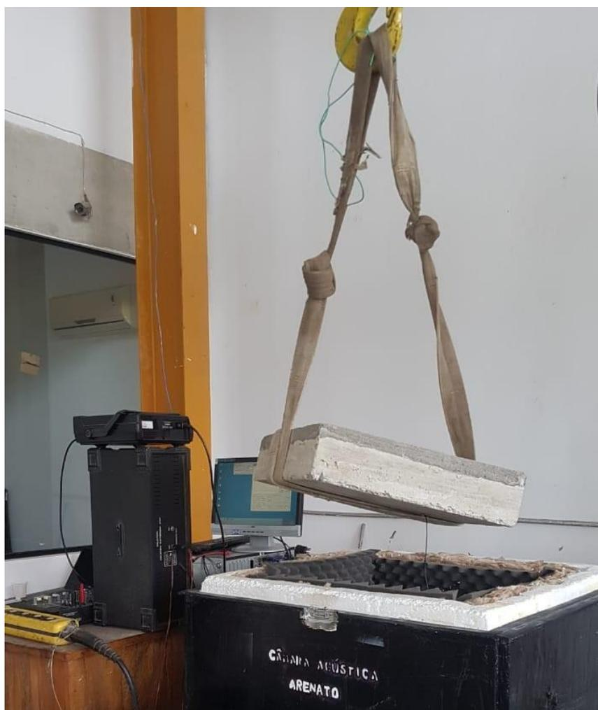
Figura 60 – Posicionamento da laje + contrapiso na câmara feito através de ponte rolante
