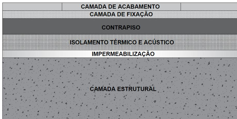
Figura 2 - Exemplo genérico de um sistema de pisos e seus elementos
