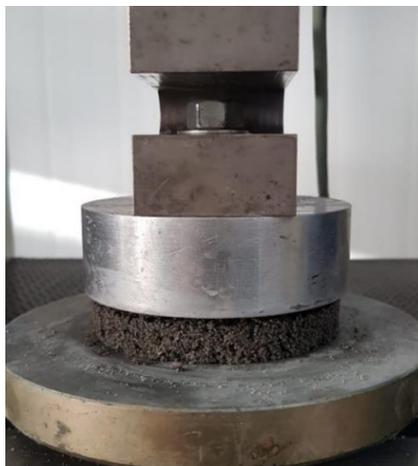
Figura 27 - Ensaio *squeeze flow*
