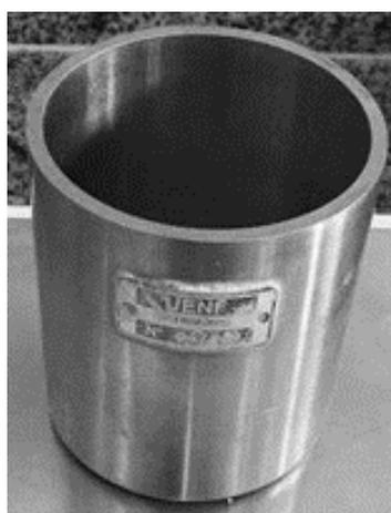
Figura 24 - Recipiente cilíndrico utilizado nos ensaios cujo volume é conhecido (400 cm<sup>3</sup>)
