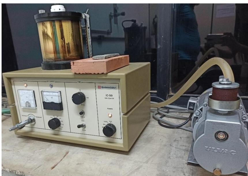
Figura 42 - Equipamento utilizado para recobrimento por deposição metálica sobre as amostras
