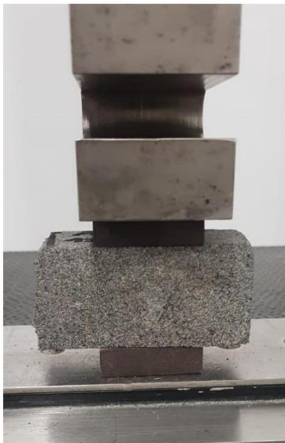
Figura 32 - Ensaio de resistência à compressão
