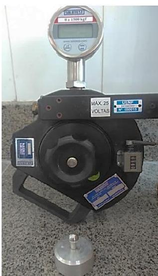
Figura 35 - Dinamômetro utilizado no ensaio de resistência de aderência à tração
