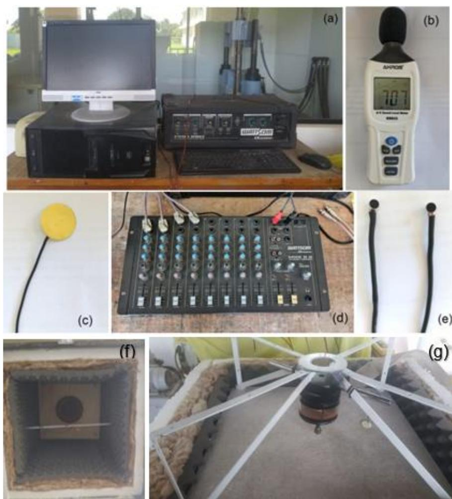
Figura 58 - Equipamentos para ensaio acústico (a) computador a esquerda e amplificador de potência a direita, (b) decibelímetro, (c) sensor de vibração, (d) mesa misturadora de áudio, (e) microfones, (f) alto falante, (g) dispositivo gerador de ruído de impacto
