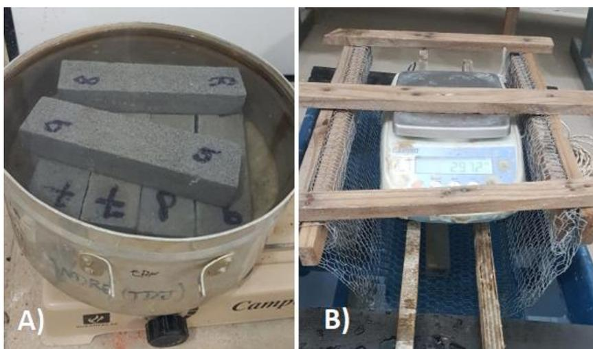
Figura 38 - Ensaio de absorção de água. A) Corpos de prova em ebulição. B) Registro da massa imersa
