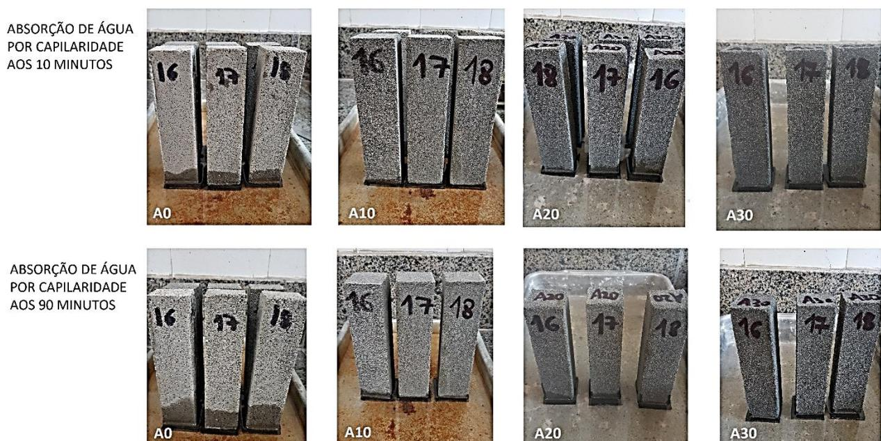
Figura 79 - Corpos de prova no ensaio de capilaridade
