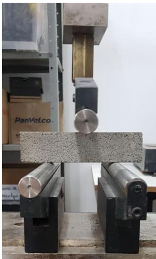
Figura 31 - Ensaio de resistência à tração na flexão
