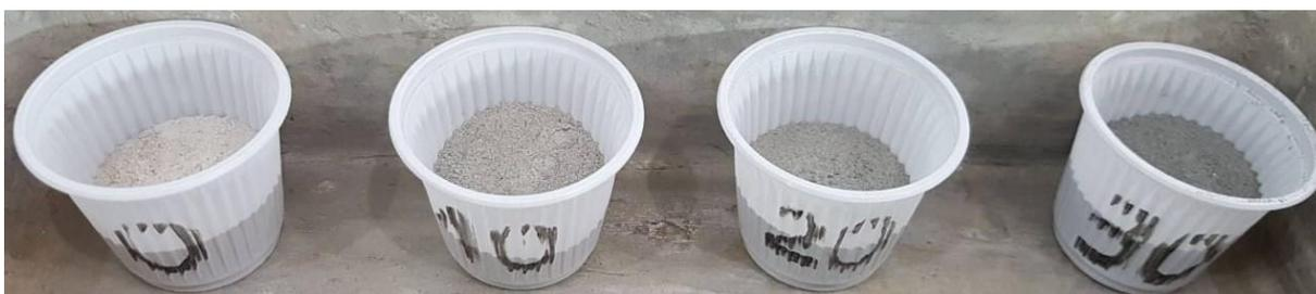
Figura 43 - Amostras das argamassas para ensaio de DRX
