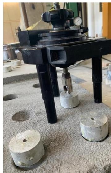
Figura 36 - Ensaio de resistência de aderência à tração sendo executado
