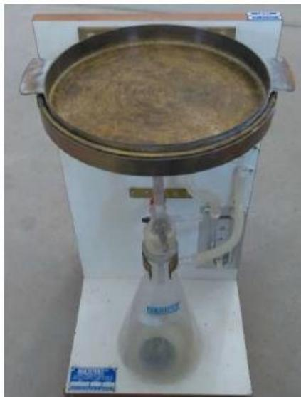
Figura 26 - Aparelho utilizado no ensaio de retenção de água
