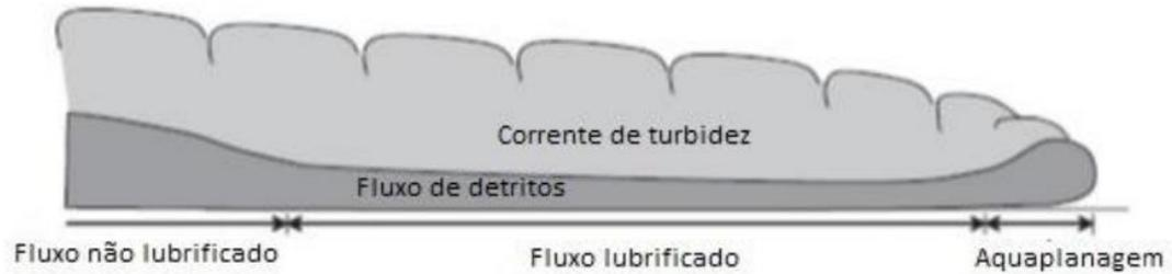
Figura 6. Morfologia de fluxo de detritos com a formação de correntes de turbidez (Ilstad et al, 2004)
