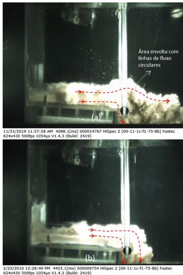
Figura 44. Comportamento do fluxo após interação com o duto. (a) Ensaio1; (b) Ensaio 5.
