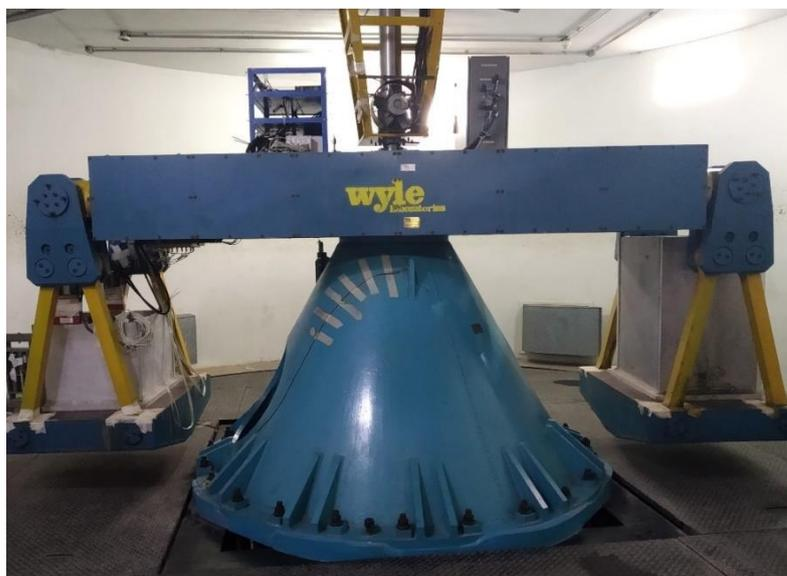
Figura 15. Centrífuga de viga da UENF com o container do ensaio à esquerda e container de contrabalanceamento à direita.
