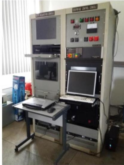
Figura 16. Central de controle da centrífuga.
