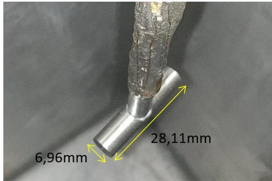
Figura 31. Detalhe da base cilíndrica do penetrômetro.
