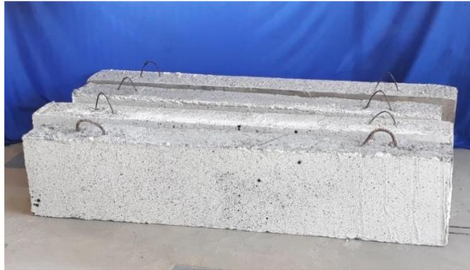
**Figura 3-25 - Vigas com a superfície pintada que será fotografada.**
