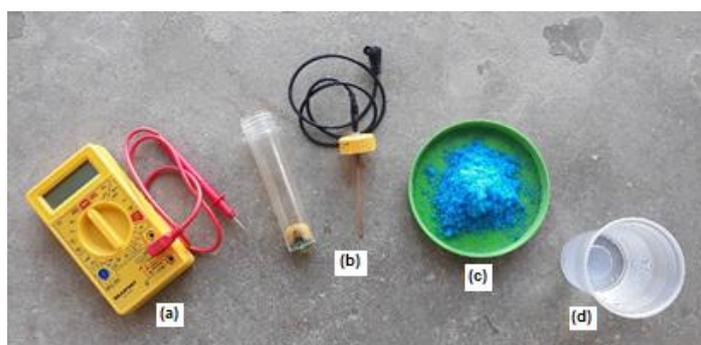
**Figura 3-29 - Elementos utilizados para leitura de potencial : (a) multímetro; (b) eletrodo de referência; (c) sulfato de cobre; (d) água.**
