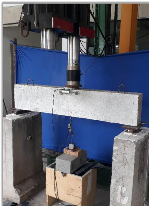
**Figura 3-43 - Ensaio de flexão das vigas estudadas.**
