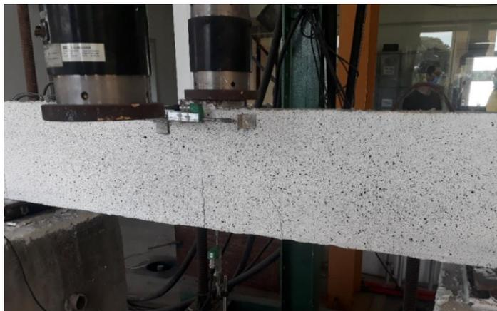
**Figura 3-26 - Viga sendo ensaiada e fotografada com presença de fissura.**
