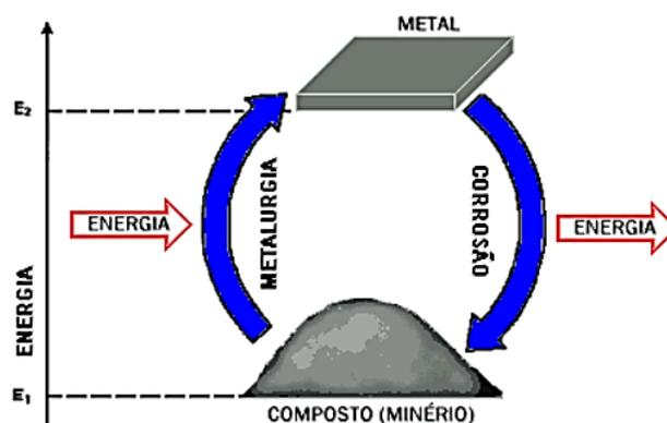
Figura 2-8- Ciclo termodinâmico dos metais (Fonte: Pinto 2006).
