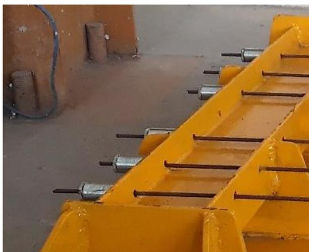
Figura 3-10 - Detalhe do cunhamento do aço.
