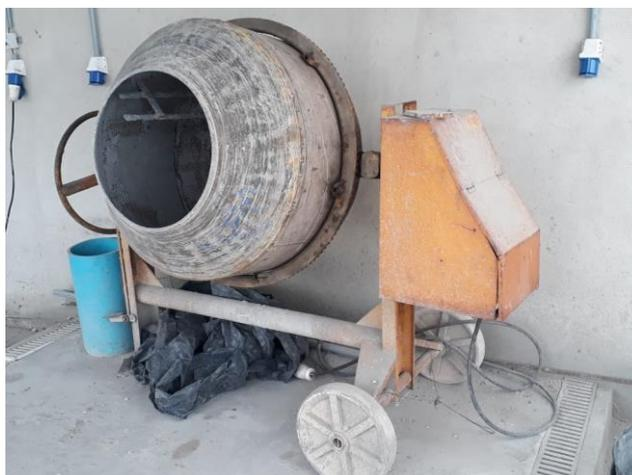
**Figura 3-5 - Betoneira de 400 litros utilizada para as concretagens.**
