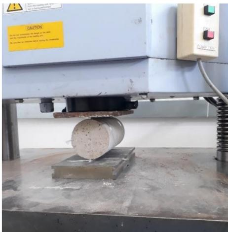
**Figura 3-21 - Ensaio de tração por compressão diametral.**
