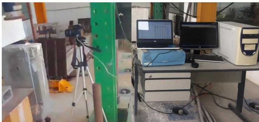
**Figura 3-24 - Set up para aquisição dos dados para o CID.**
