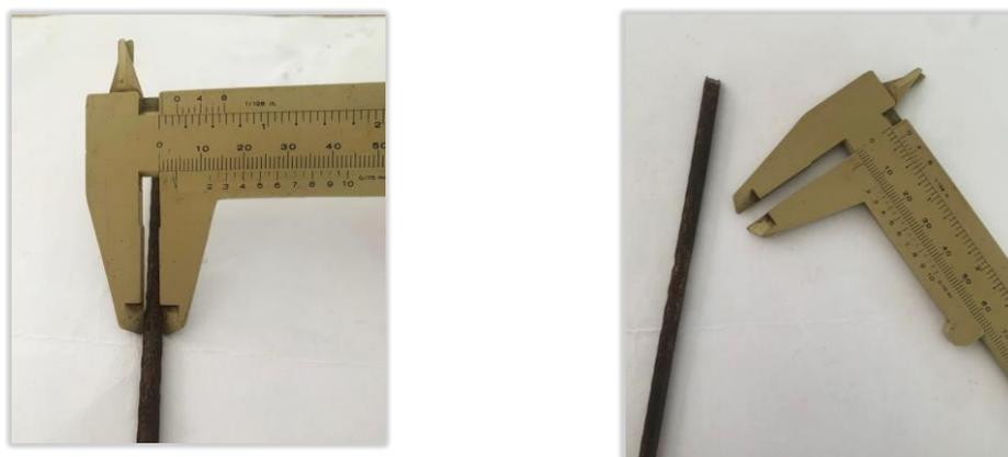
Figura 4-6 – Processo de medição do diâmetro dos fios corroídos ao longo do seu comprimento
