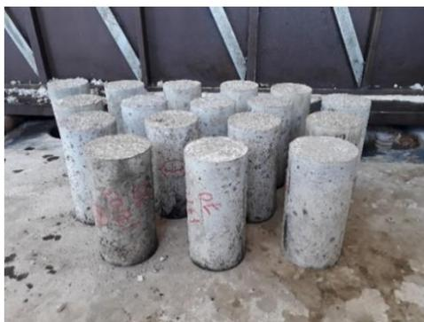
**Figura 3-17 - Corpos de prova cilíndricos para ensaio de caracterização do concreto**
