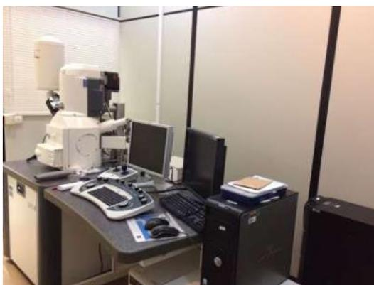
**Figura 3-38 -Equipamento da Microscópio eletrônico de varredura.**
