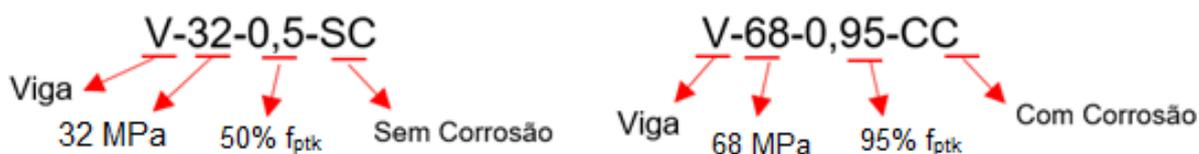
Figura 3-6 - Nomenclaturas adotadas para identificação das vigas
