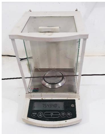
**Figura 3-39 - Pesagem das barras de aço**
