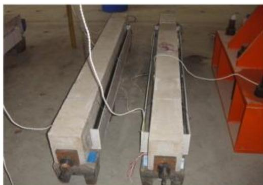
**Figura 2-55 - Teste de corrosão acelerado de vigas. (Fonte: Dai et al. 2016).**
