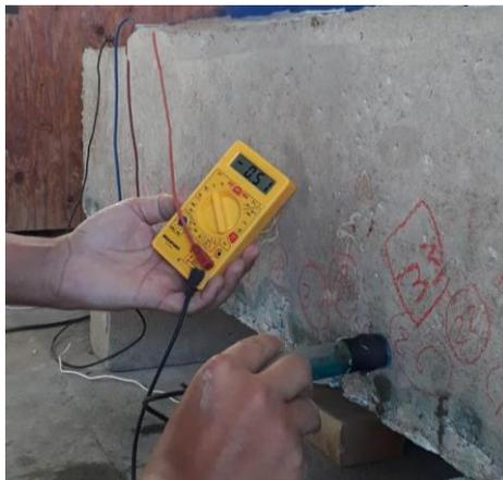
**Figura 3-31 - Execução do ensaio para determinação do potencial de corrosão com multímetro de alta impedância.**
