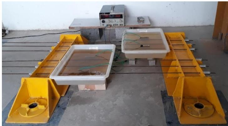
**Figura 3-36 - Configuração experimental do ataque as armaduras tensionadas**
