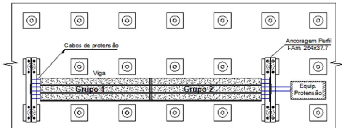
**Figura 3-15 - Esquema da pista de protensão na laje de reação do LECIV**
