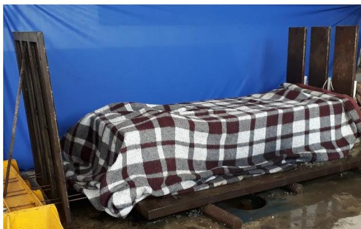
**Figura 3-18 - Vigas em cura úmida por 28 dias**
