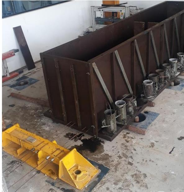
**Figura 3-14 - Forma metálica para concretagem das vigas protendidas**
