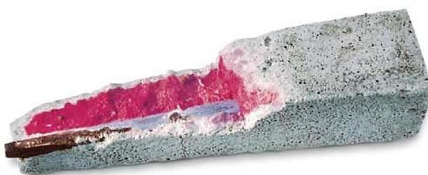
**Figura 2-25 - Carbonatação: Indicadores à base de fenofaleína reagem e tornam-se incolores na zona carbonatada e assumem uma cor vermelho-carmim na região alcalina.**
