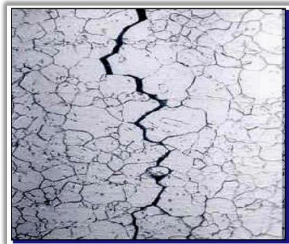
**Figura 2-27: Corrosão intergranular (Fonte: GENTIL, 2003).**
