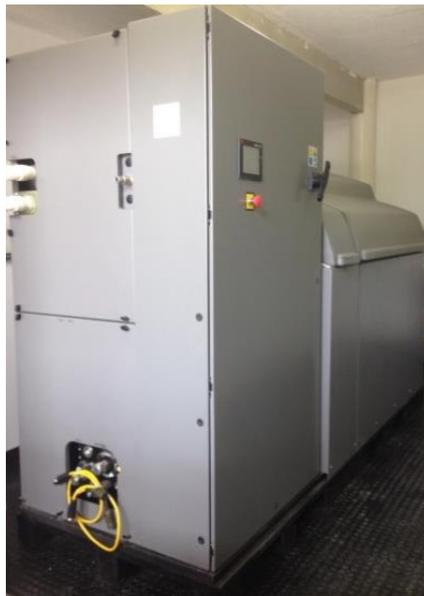
**Figura 3-42 - Unidade hidráulica 505.90S da MTS.**
