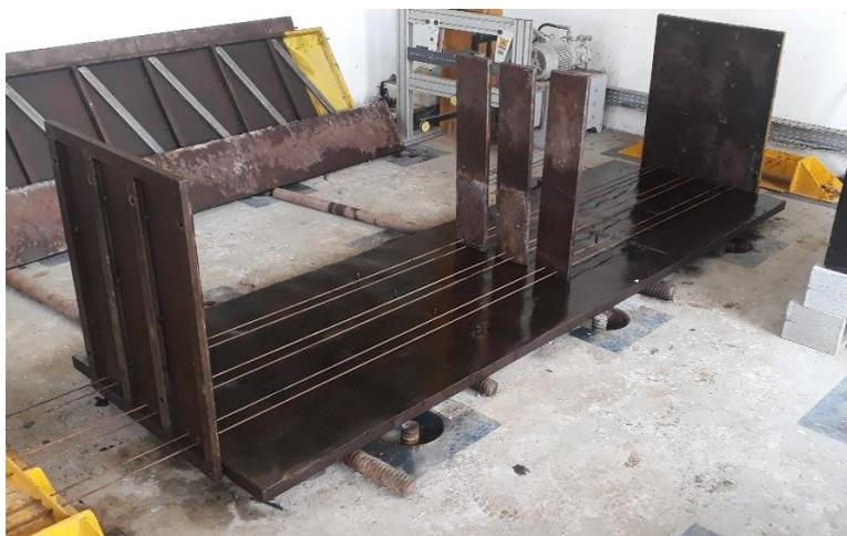
**Figura 3-13 – Fios locados e ancorados para ser tensionado.**
