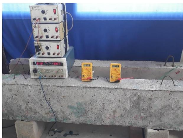
**Figura 3-32 - Aplicação de corrente nas vigas sendo registrada pelos multímetros.**
