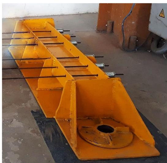
**Figura 3-8** – Sistema de ancoragem dos fios de protensão.
