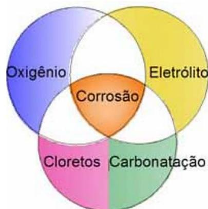
**Figura 2-7- Condições para ocorrência de corrosão (Böhni, 2005).**
