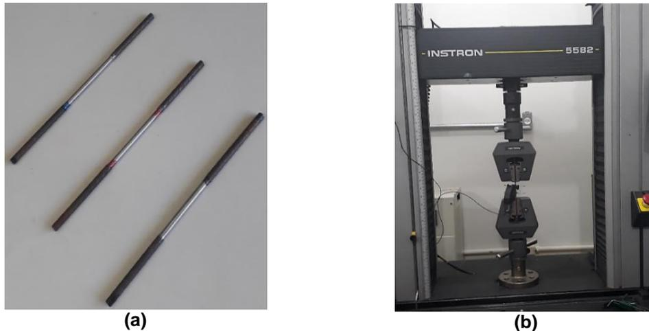
Figura 3-3 Armaduras e setup do ensaio: (a) amostras para ensaio; (b) ensaio de tração do aço.
