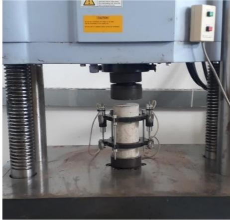
**Figura 3-20 - Ensaio de resistência à compressão com aquisição de dados de força e deslocamento.**
