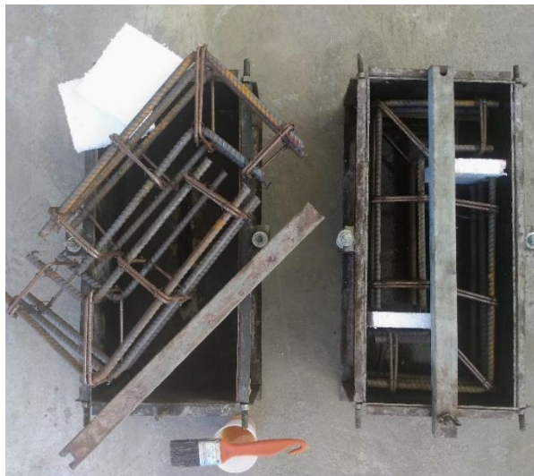
Figura 3.25: Forma e armadura do push-off .
