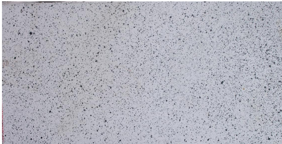
Figura 3.46: Padrão de pontos do vão de cisalhamento da viga RAC 2.
