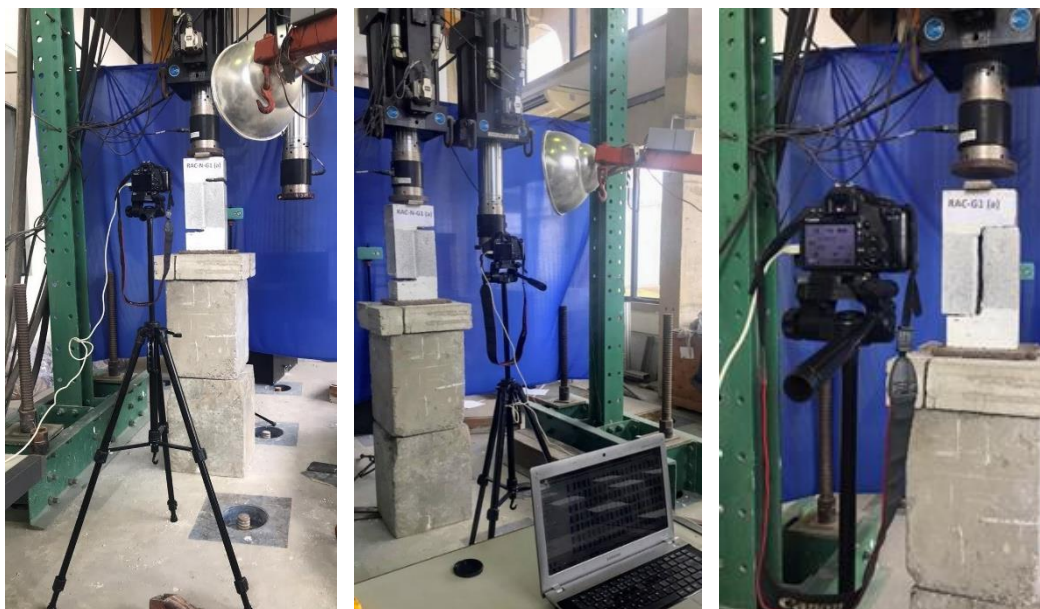
Figura 3.30: Configuração dos ensaios dos espécimes push-off .
