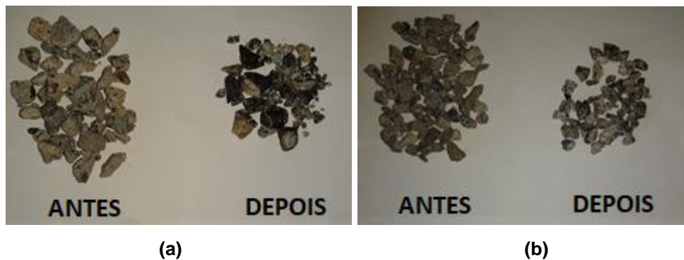
Figura 3.16: Amostras antes e depois do ataque químico: (a) Grupo 1 e (b) Grupo 2.
