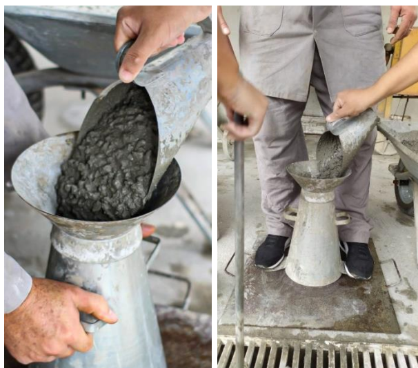
Figura 3.18: Ensaio de abatimento do tronco de cone.
