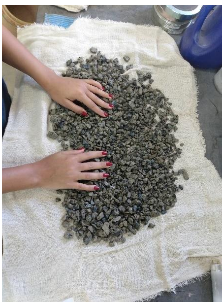
Figura 3.11: Ensaio de absorção de água.
