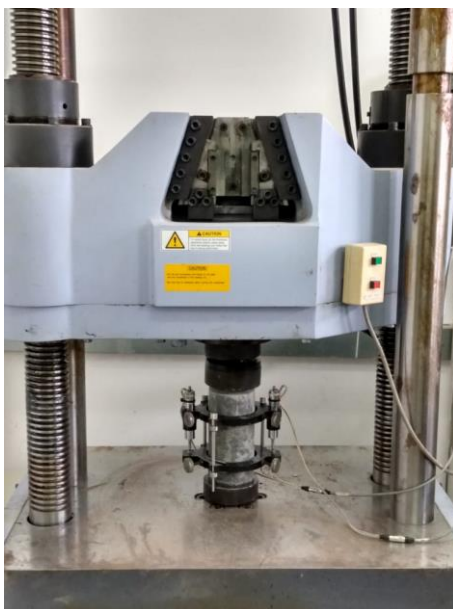
Figura 3.22: Ensaio de módulo de elasticidade.
