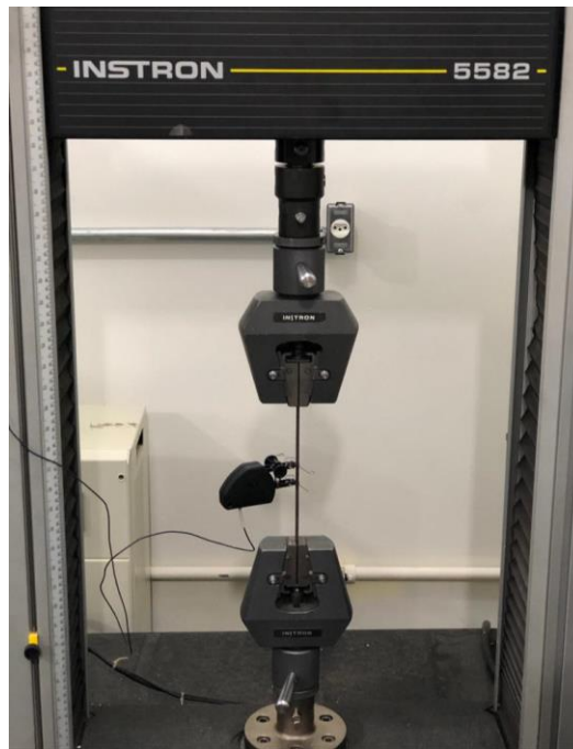
Figura 3.34: Execução do ensaio de tração nas barras de aço.
