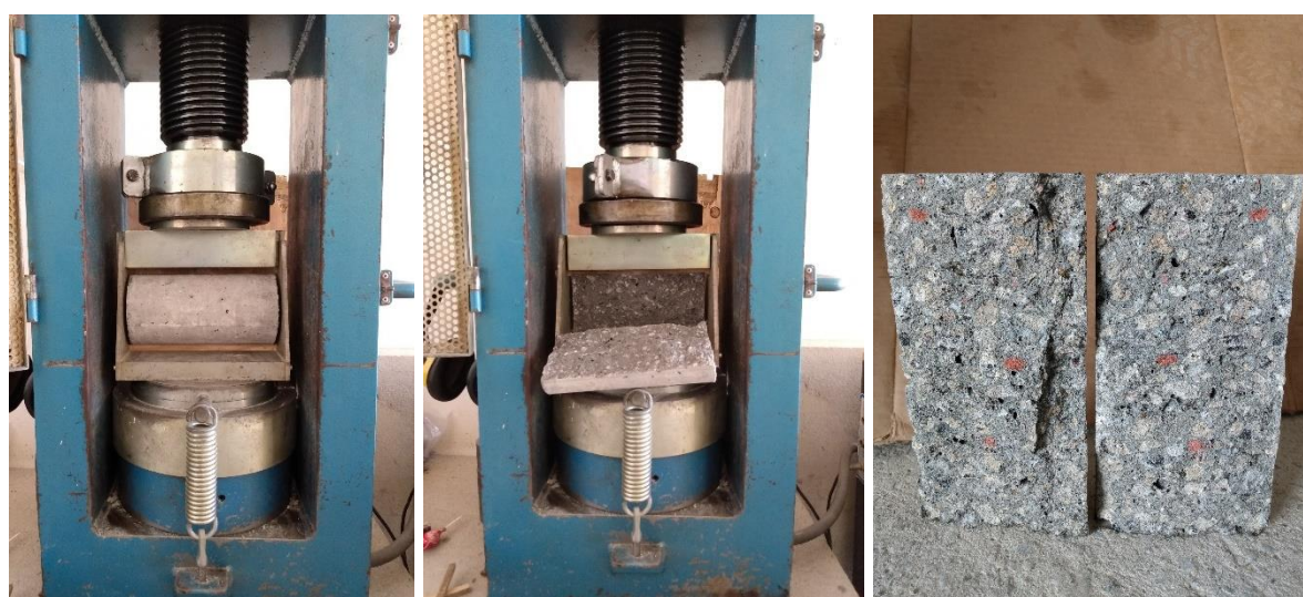
Figura 3.21: Ensaio de resistência à tração por compressão diametral.
