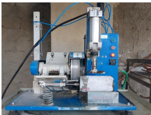
Figura 3.19: Retificação dos corpos-de-prova cilíndricos.
