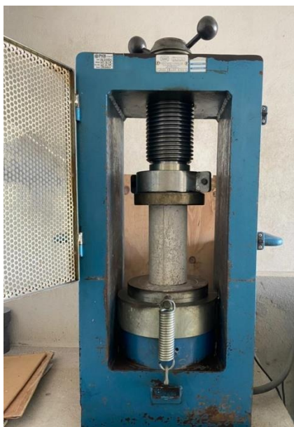
Figura 3.20: Ensaio de resistência à compressão.
