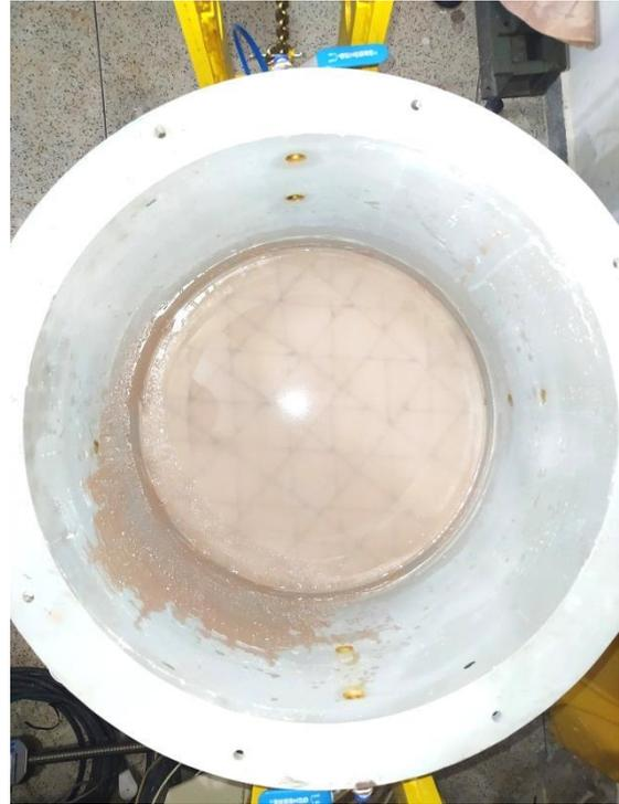
Figura 55. Camada 4 escarificada após a retirada do TopCap para deposição da Camada 3.
