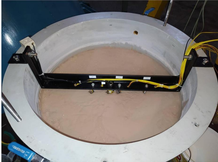
Figura 60. Cantoneira com instrumentação após sua inserção no solo.
