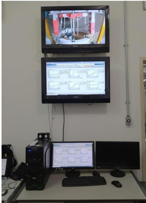
Figura 44. Telas de visualização e controle do ensaio centrífugo.
