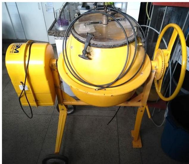
Figura 48. Equipamento deaerador de solo.
