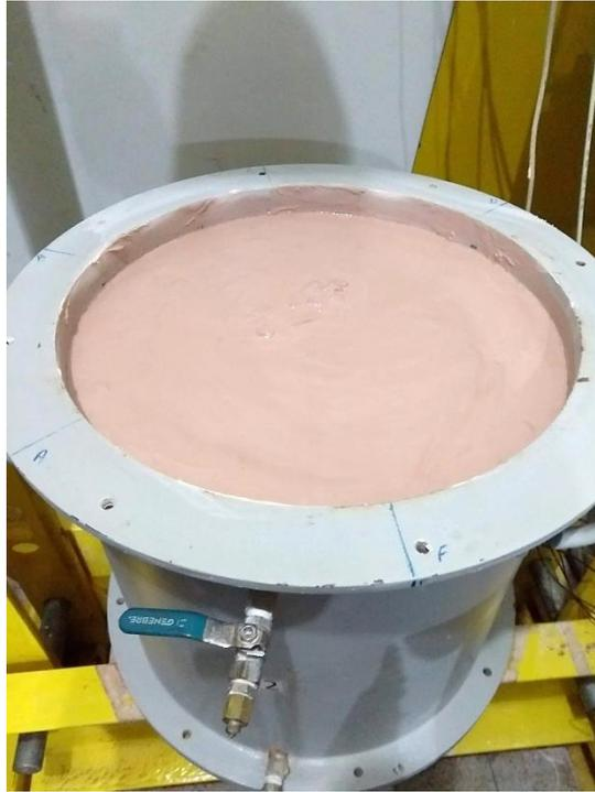
Figura 49. Lama confeccionada após deposição no container.
