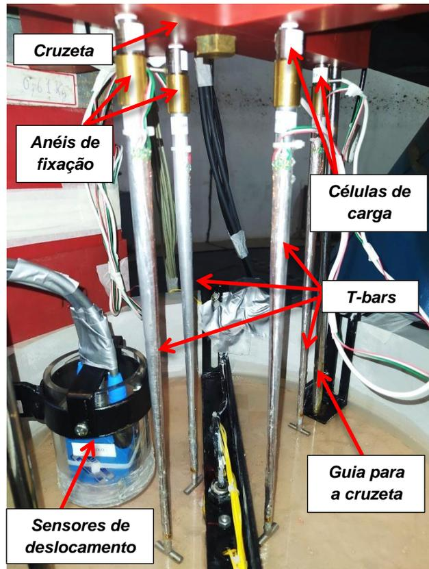
Figura 40. Penetrômetros T-bar conectados à cruzeta, juntamente com suas respectivas células de carga.
