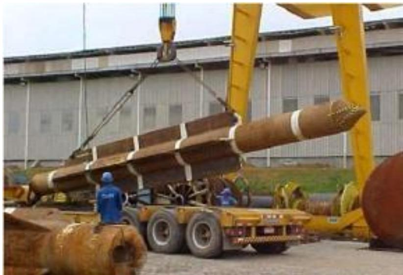
Figura 3. Estaca torpedo utilizada para ancoragem de plataformas flutuantes.
