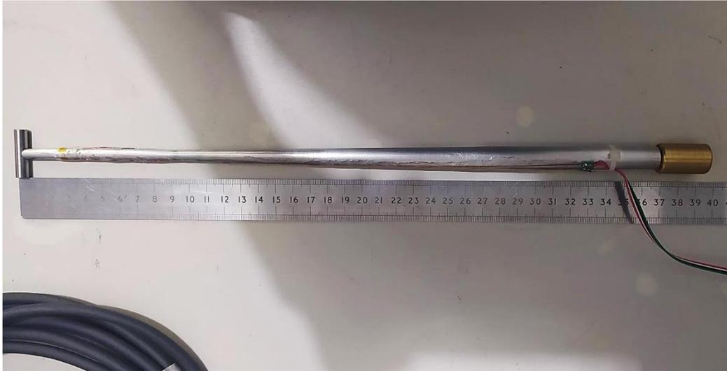
Figura 39. Penetrômetro T-bar utilizado para os ensaios centrífugos.
