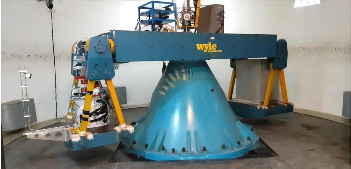
Figura 45. Centrífuga geotécnica da UENF.
