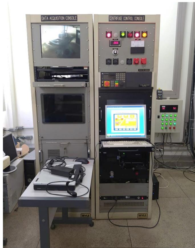
Figura 46. Painel de controle da centrífuga geotécnica.
