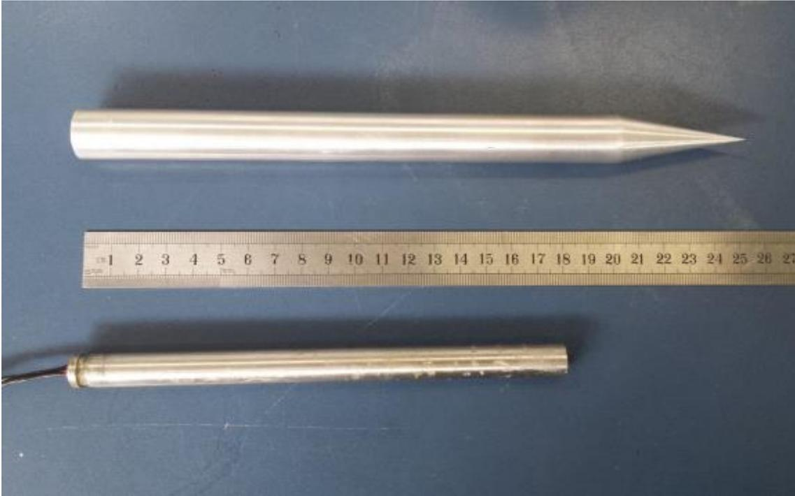
Figura 29. Estaca e aquecedor utilizados na confecção do modelo físico reduzido.
