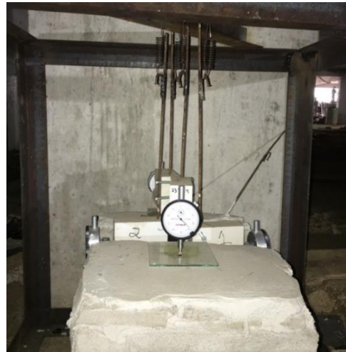
(b) Instrumento instalado no bloco sobre as estacas
