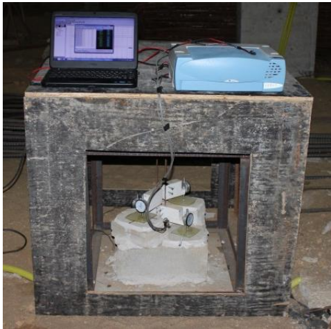
(a) Sistema de aquisição de dados (LYNX) conectado ao computador e aos strain-gages
