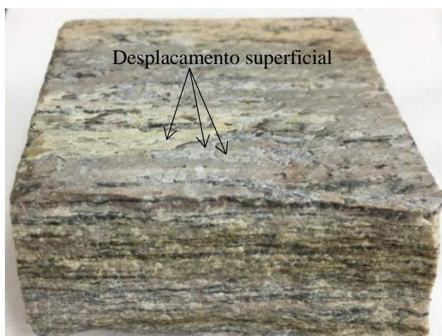
Figura 4.16 – Gnaise milonítico envelhecido em laboratório. Fonte: Autora
