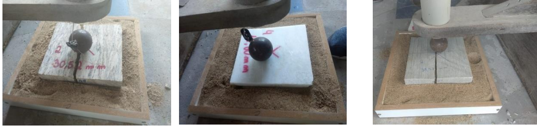
Figura 3.16 -Teste de Impacto de Corpo Duro. Fonte: Autora
