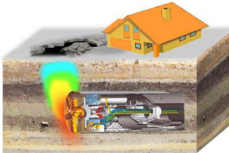
Figura 2.6 Danos provocados pela instabilidade da face na escavação mecanizada.
