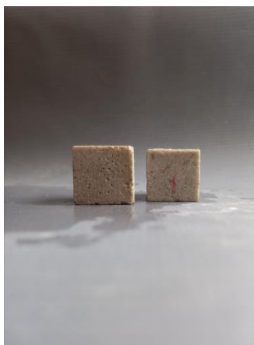
Figura 17: Corpos de provas cúbicos (aresta 2,5 mm) para ensaio de atividade pozolânica com cal.
