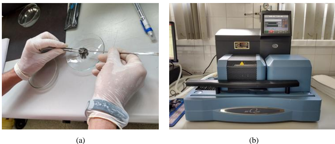
Figura 27: Análise termogravimétrica: a) preparação da amostra em cadinho; b) equipamento SDT Q600 - TA Instruments.
