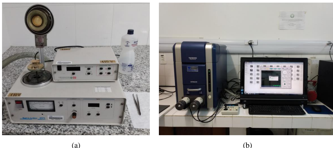
Figura 14: Análise por microscopia eletrônica de varredura: a) metalização das amostras em equipamento Sputter Coater SC7620; b) microscópio TM3000 – HITACH.
