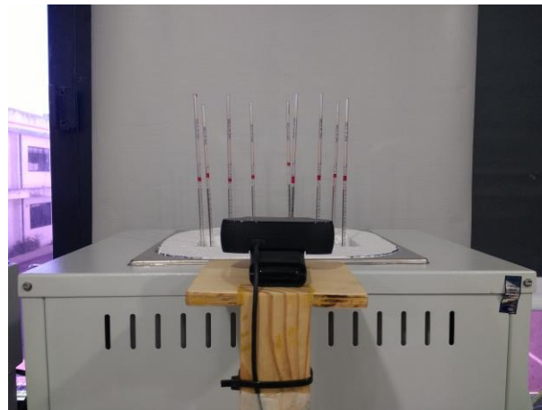
Figura 29: Ensaio de retração química - monitoramento da variação do volume de água das pipetas.
