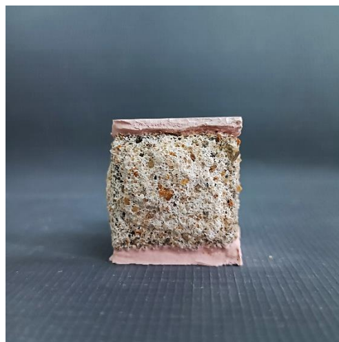
Figura 45 – Corpo de prova após 56 dias de ataque ácido com as faces capeadas para ensaio de resistência à compressão.
