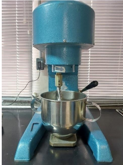
Figura 40 – Misturador de bancada utilizado na produção das argamassas.
