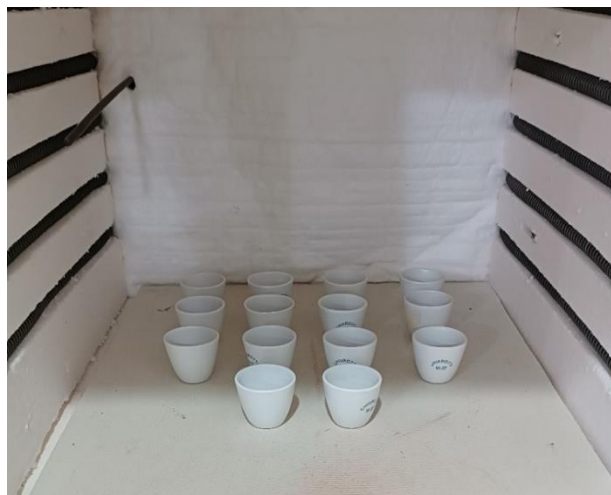
Figura 26 – Amostras em cadinhos de porcelana posicionadas para queima em mufla para determinação da perda ao fogo.
