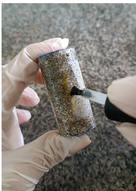
Figura 42 – Processo de aplicação da resina epóxi na lateral dos corpos de prova cilíndricos.
