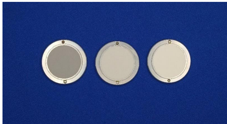
Figura 28 – Amostras de CFB-IN, CFB-AD e CFB-AC preparadas para ensaio de difratometria de raios X.
