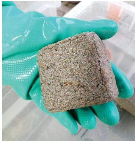
Figura 33: Aparência do corpo de prova cúbico sendo atacado após o procedimento de lavagem.
