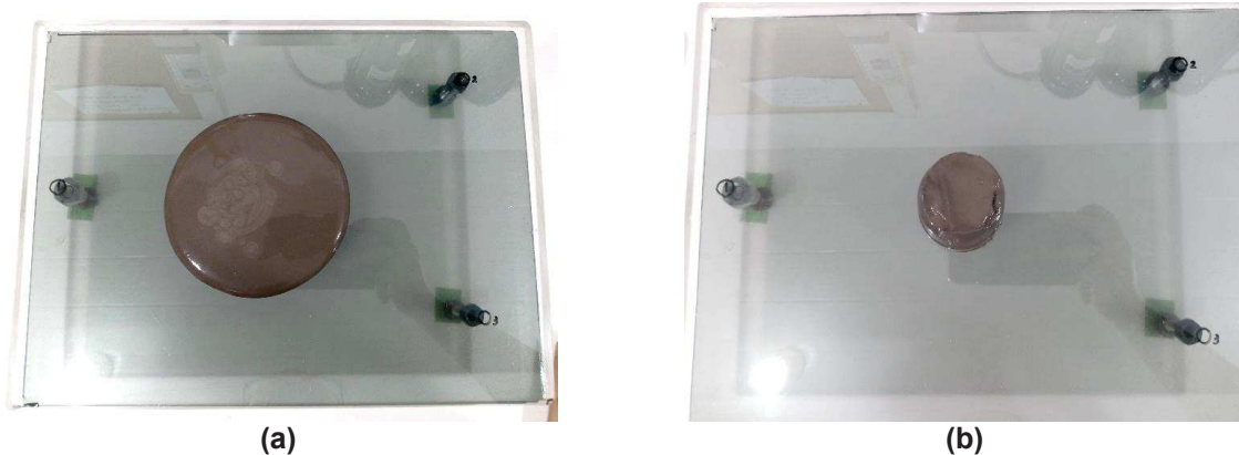
Figura 24: Ensaio de miniabatemento do tronco do cone da P-REF (a) e P-CLBC10 (b).
