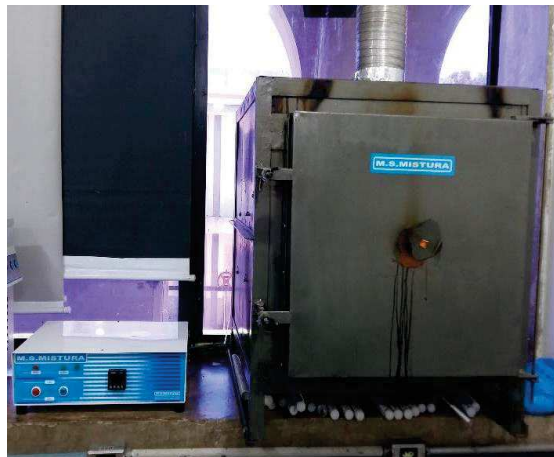
Figura 16: Forno mufla M.S. Mistura do Nexmat/LECIV/UENF.
