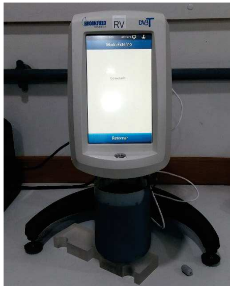
Figura 29: Viscosímetro de taxa controlada Brookfield do tipo DV-3 T, equipado com um eixo de geometria Vane do tipo V-73, Nexmat/ LECIV/UENF.
