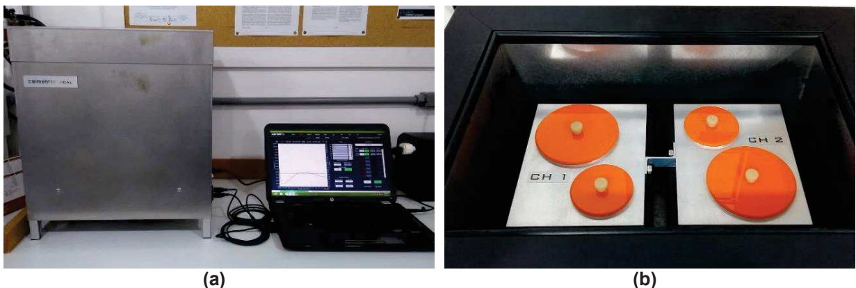
Figura 25: Equipamento para leitura da liberação de calor durante a hidratação inicial com calorímetro I-CAL 2000 (a) e interior do calorímetro com seus dois canais (b), Nexmat/LECIV/UENF.
