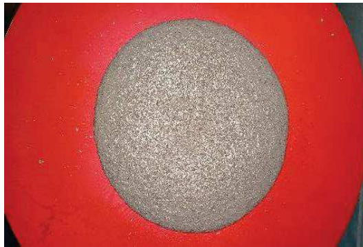
Figura 22: Determinação do espalhamento no ensaio de reatividade com cal da CLBC20.
