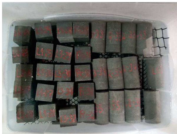
Figura 31: Cura dos corpos de prova em solução saturada com cal.
