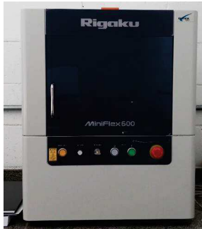
Figura 18: Difratorômetro Miniflex 600, Nexmat/LECIV/UENF.
