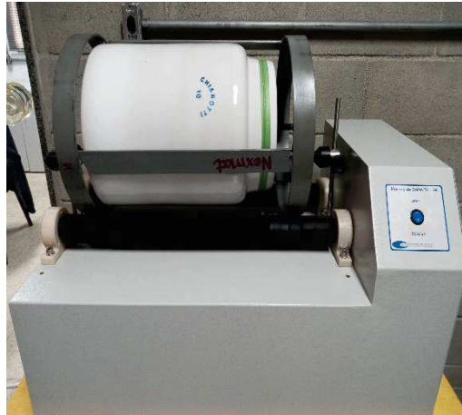
Figura 12: Moinho de bolas SL-34 da Solab e vaso de 10 L da Chiarotti.
