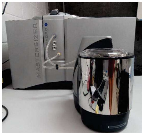
Figura 20: Granulômetro a laser Malvern Mastersizer 3000 e unidade de dispersão Hydro LV, Nexmat/LECIV/UENF.
