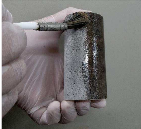
Figura 35: Aplicação da primeira camada de verniz após secagem em estufa para realização do ensaio de capilaridade.
