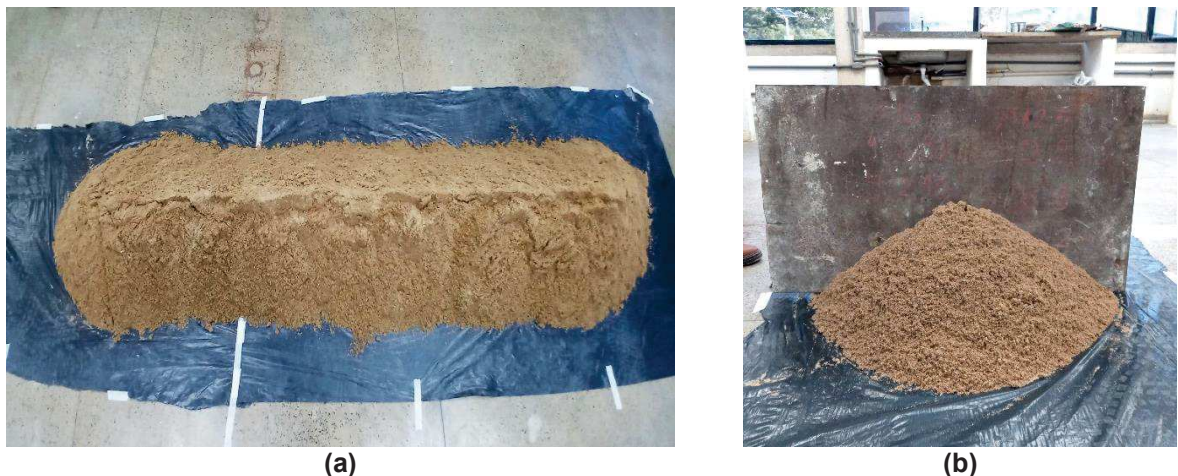
Figura 13: Homogeneização da areia de rio (a) e quarteamento (b).
