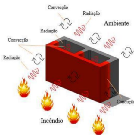
Figura 10 – Mecanismos de transferência de calor durante o incêndio (Rodvalho, 2018).
