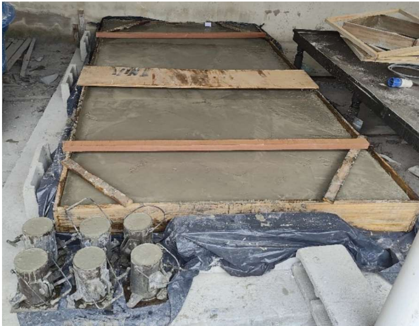
Figura 24: Laje e corpos de prova para confecção e caracteriação do AR.
