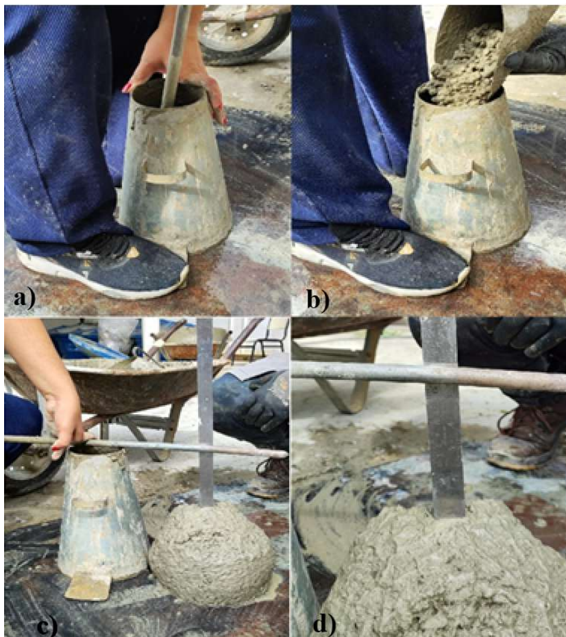
Figura 25: Ensaio de abatimento de cone (a) adensamento, (b) preenchimento, (c) remoção do molde e (d) medição do abatimento
