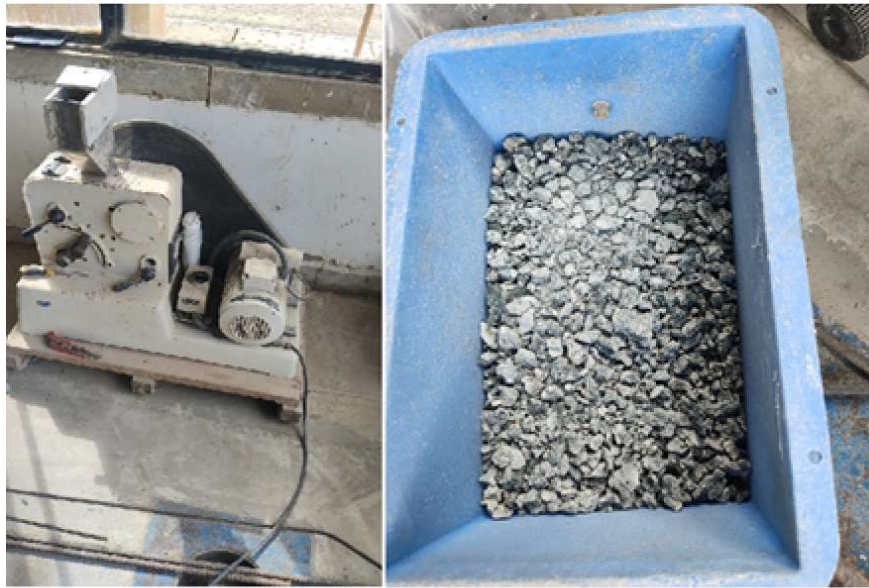
Figura 29: Processo de britagem (a) britador de mandíbula e (b) redução das dimensões
