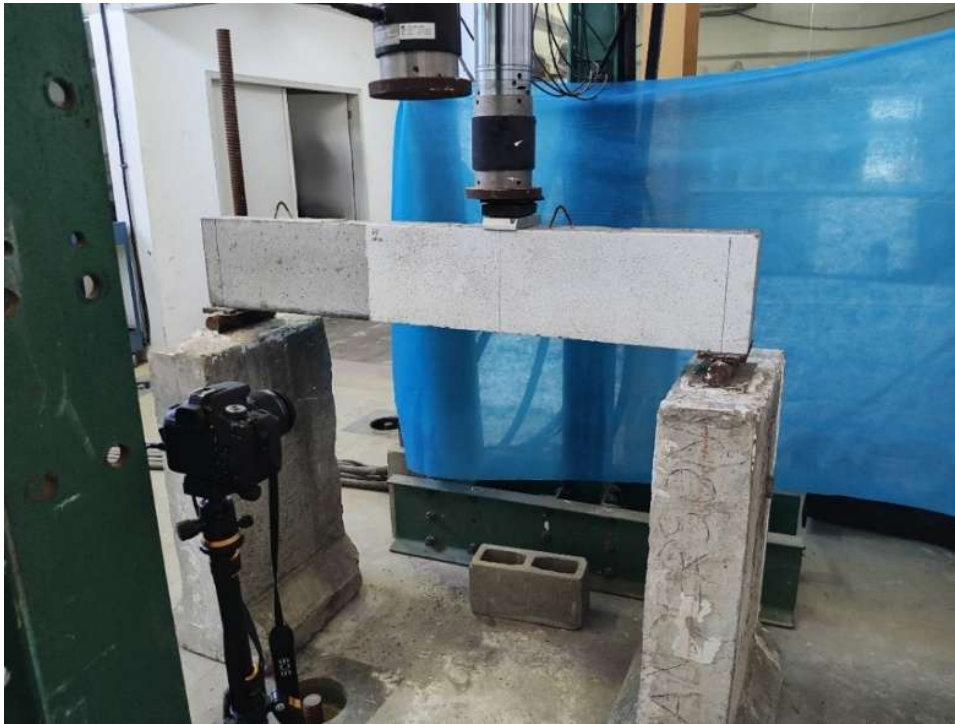
Figura 56: Realização do ensaio de flexão da viga de referencia NAT 0%
