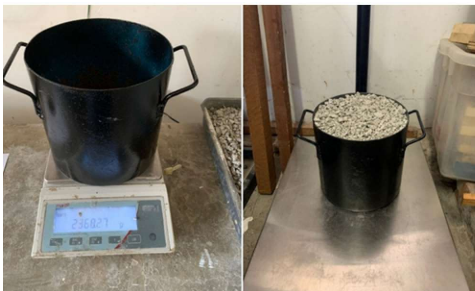
Figura 32: Ensaio de massa unitária (a) recipiente de volume padrão e (b) recipiente com os agregados compactados
