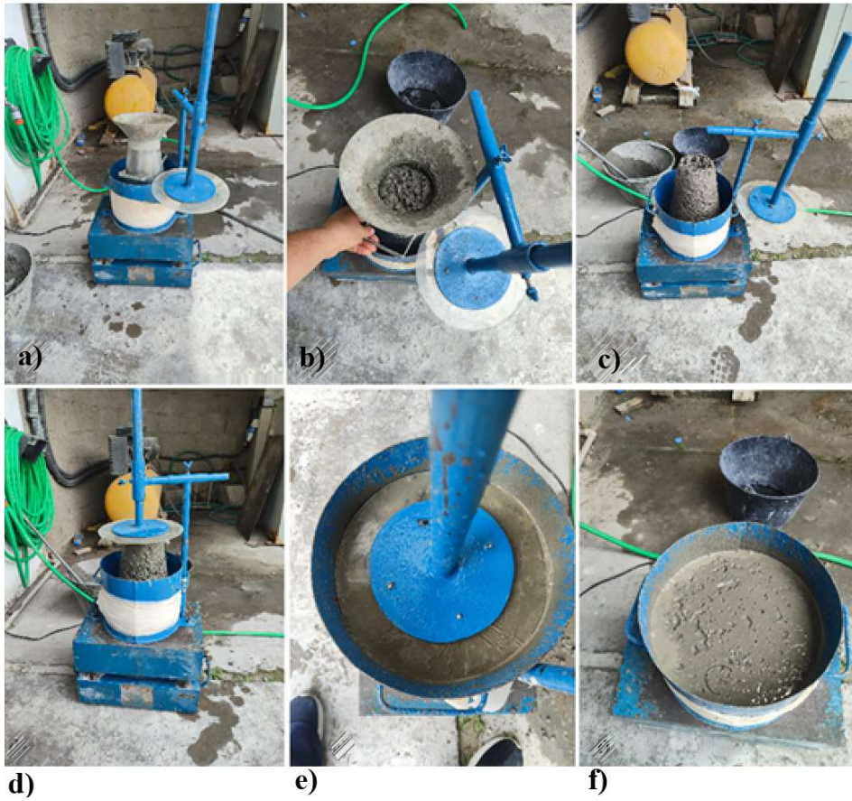
Figura 45: Execução do ensaio VeBe (a) Ensaio montado em mesa vibratória, (b) abatimento de cone, (c) Sedimentação do cone, (d) preparo para vibração, (e) vibração até preencher os vazios, (f) resultado do ensaio
