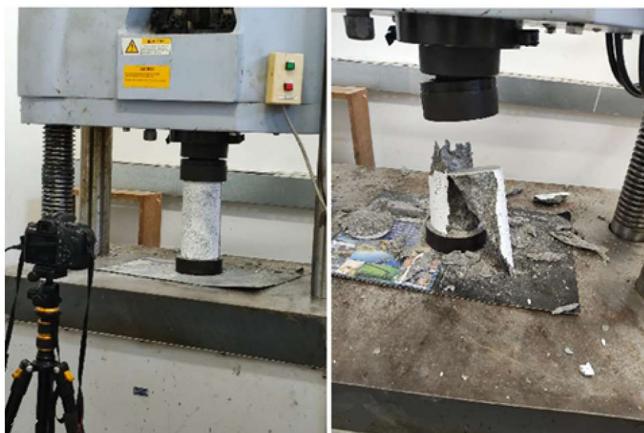
Figura 51: Ensaio de resistência à compressão: (a) registro por fotogrametria; (b) momento da ruptura
