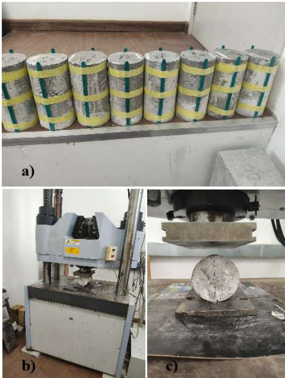
Figura 52: Ensaio de resistência com compressão diametral: (a) preparo dos corpos-de-prova; (b) execução do ensaio; (c) após ruptura.
