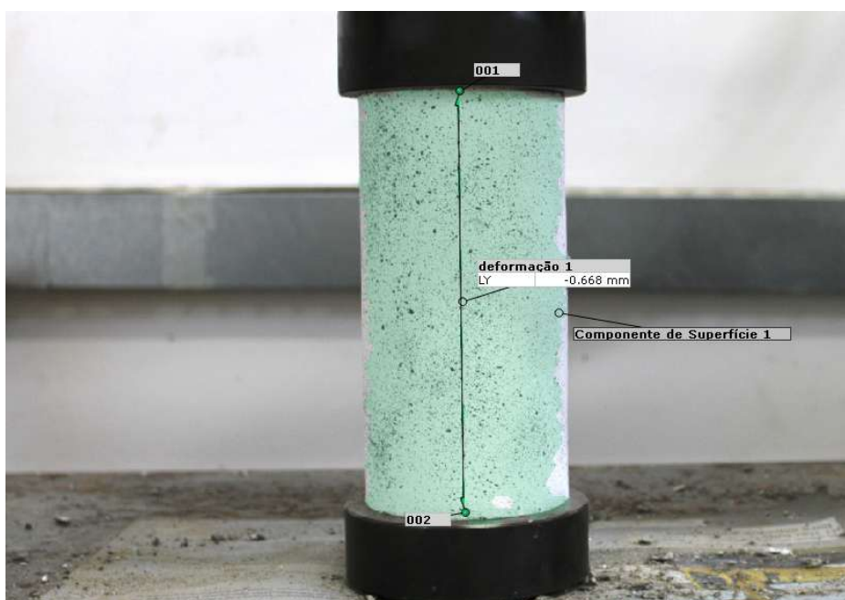
Figura 50: Deformação sofrida no momento antes da ruptura
