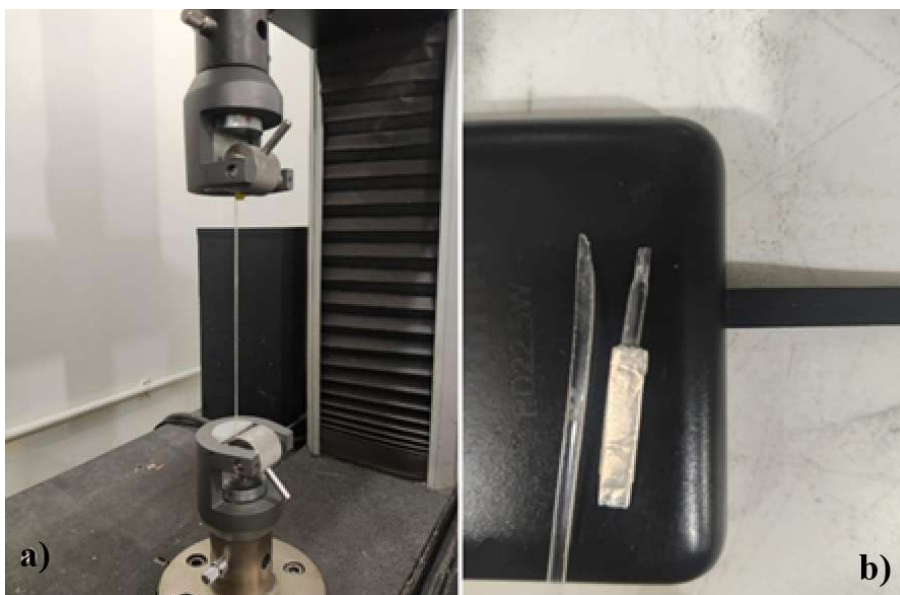
Figura 17: (a) Ensaio de tração e (b) Rompimento da fibra
