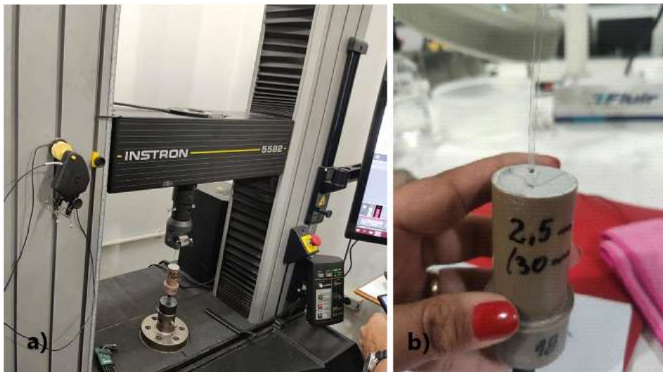
Figura 21: Ensaio PULL-OUT (a), escorregamento da fibra (b)
