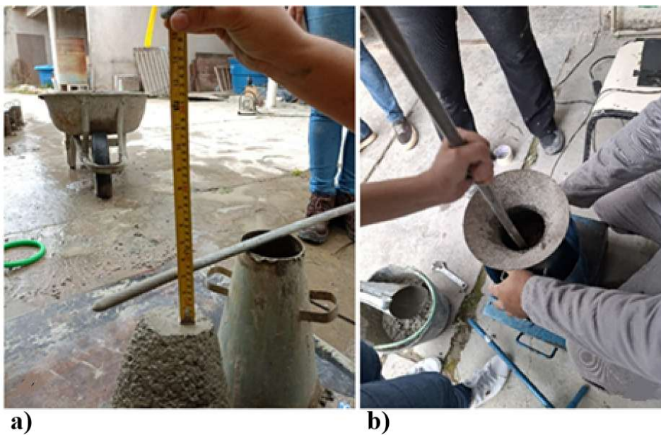
Figura 46: Caracterização do concreto no estado fresco: (a) ensaio de abatimento de cone, (b) ensaio de consistência VeBe
