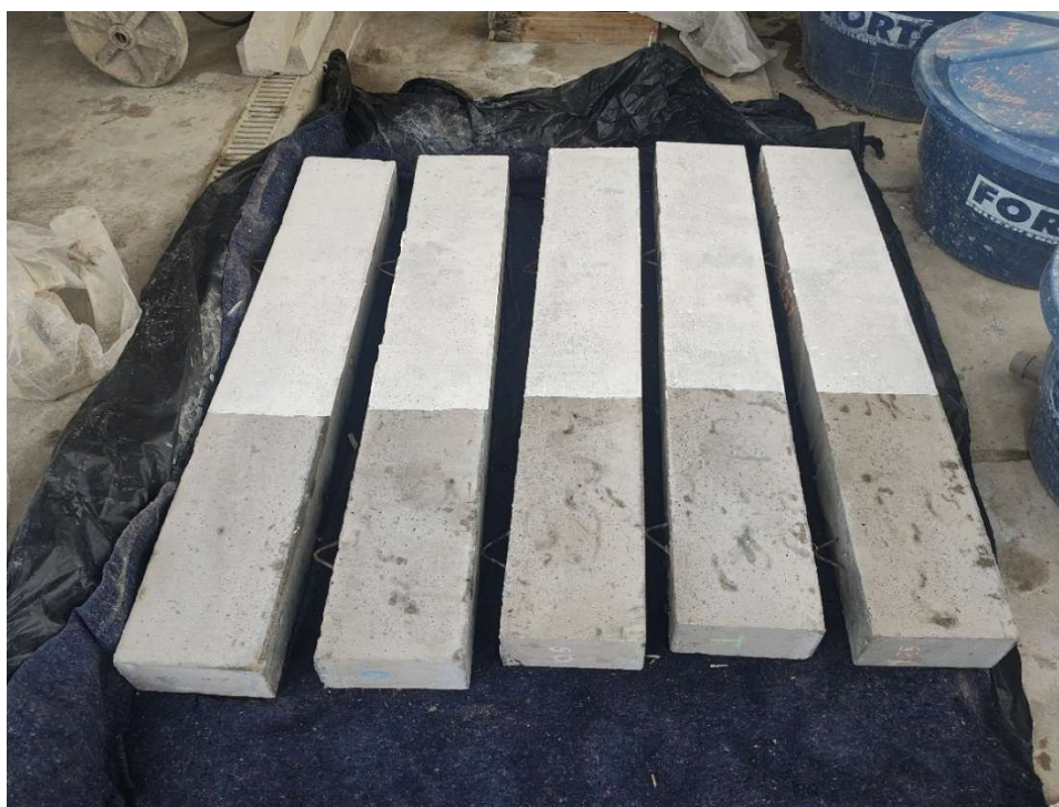
Figura 55: Vigas após tratamento na superfície de pintura
