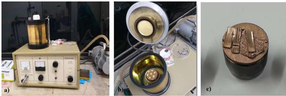
Figura 16: Processo de aplicação da metalização nas amostras
