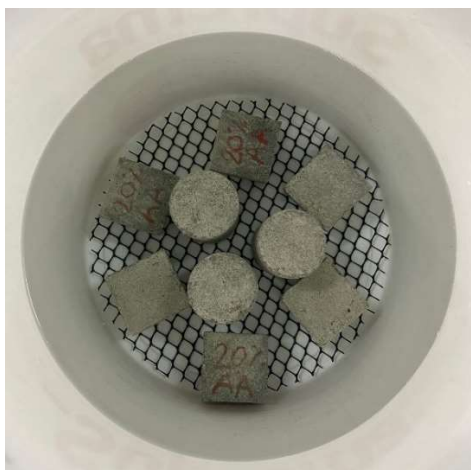
Figura 36: Corpos de prova submersos em solução.
