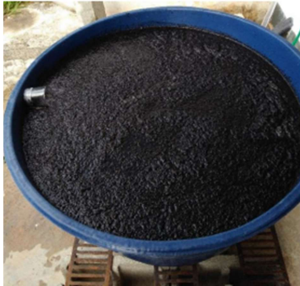
Figura 3: Procedimento de separação por fracionamento densimétrico da cinza residual (Andreão, 2018).
