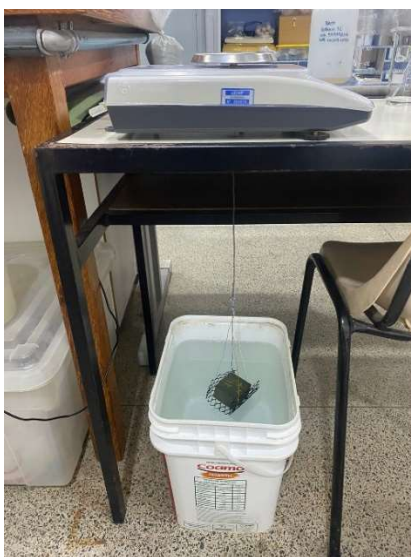
Figura 33: Determinação da massa saturada imersa de corpos de prova de argamassa.
