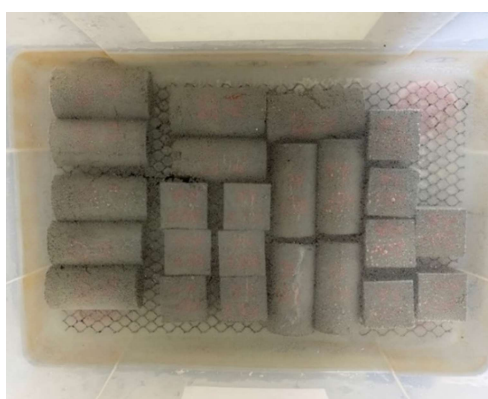
Figura 30: Corpos de prova submersos em água saturada de cal.
