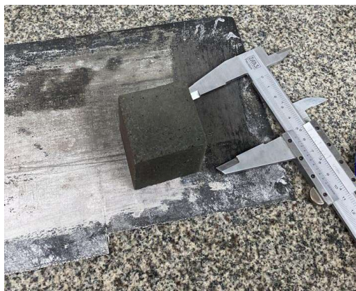
Figura 31: Preparo do corpo de prova antes do ensaio de resistência à compressão.
