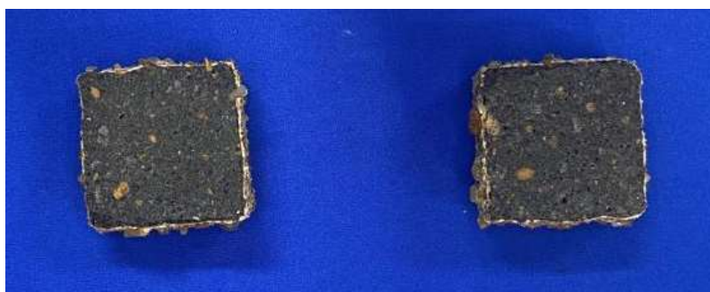
Figura 37: Corpo de prova cúbico pós ataque, seccionado ao meio para ensaio de absorção por imersão total.
