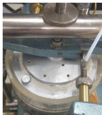
Figura 78 — Temperatura Ambiente: a) Extrusão do Solo a Tensão Normal 125 kPa sob Taxa de Cisalhamento 30°/min; b) Extrusão do Solo a Tensão Normal 125 kPa sob Taxa de Cisalhamento 60°/min.
