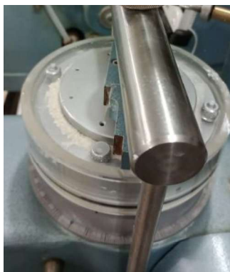
Figura 77 — Temperatura Ambiente: a) Extrusão do Solo a Tensão Normal 125 kPa sob Taxa de Cisalhamento 2,4°/min; b) Extrusão do Solo a Tensão Normal 125 kPa sob Taxa de Cisalhamento 12°/min.
