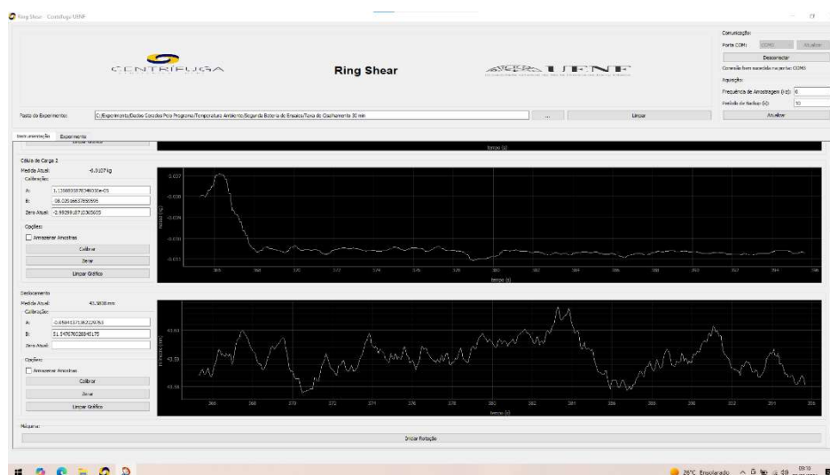
Figura 20 — Interface do Programa Monitoramento dos Sensores de Carga e LVDT.
