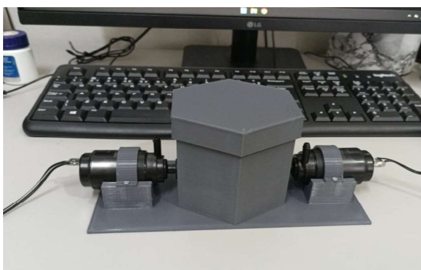
Figura 15 — Caixa d'água com Bombas para Controle do Nível d'água.
