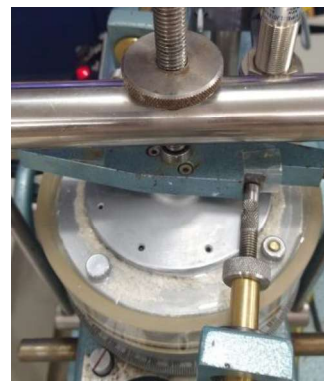
Figura 77 — Temperatura Ambiente: a) Extrusão do Solo a Tensão Normal 125 kPa sob Taxa de Cisalhamento 2,4°/min; b) Extrusão do Solo a Tensão Normal 125 kPa sob Taxa de Cisalhamento 12°/min.
