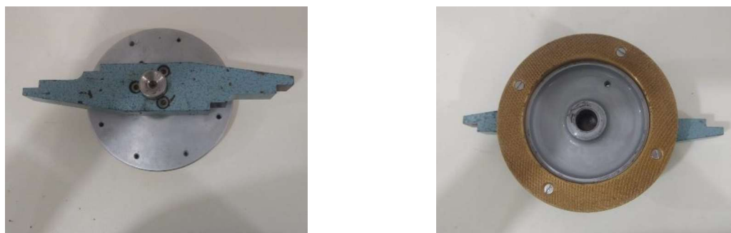
Figura 11 — a) Vista da área Externa da Placa Superior do Equipamento de Cisalhamento de Anel; b) Vista da Área Interior da Placa Superior do Equipamento de Cisalhamento de Anel.
