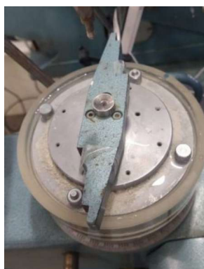
Figura 78 — Temperatura Ambiente: a) Extrusão do Solo a Tensão Normal 125 kPa sob Taxa de Cisalhamento 30°/min; b) Extrusão do Solo a Tensão Normal 125 kPa sob Taxa de Cisalhamento 60°/min.
