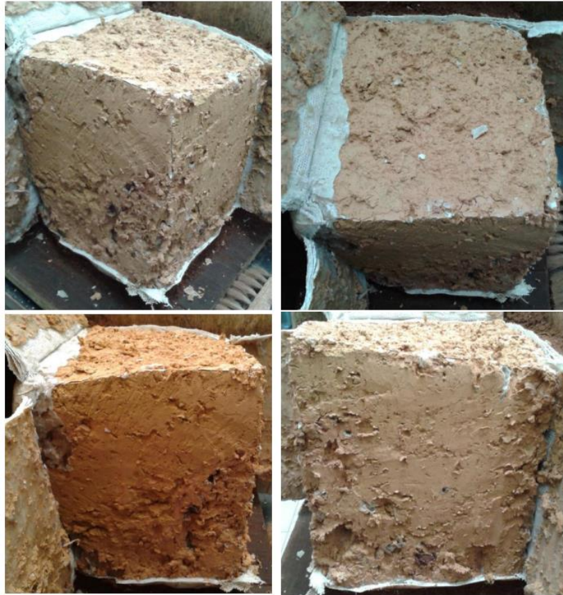
Figura 9-3 - Testemunho da amostra indeformada 2018-PI-01-AMI-01 da camada de pilha. Fonte: Mineradora responsável pela estrutura.
