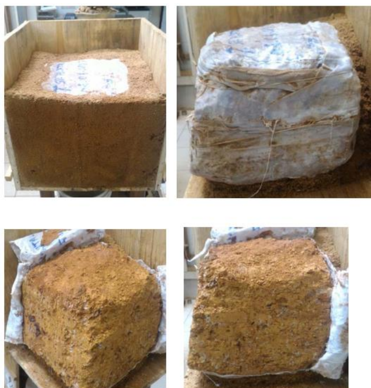
Figura 9-1. Testemunho da amostra indeformada retirada da camada de aterro.
