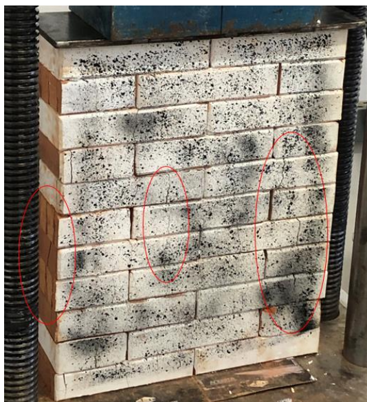
Figura 78 - Ruptura da Pequena Parede.
