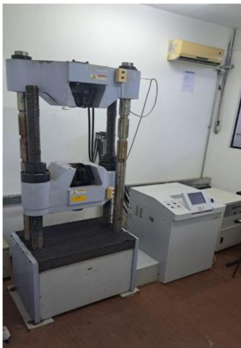
Figura 27 - Prensa Shimadzu, 500kN. Fonte – Autoria Própria.
