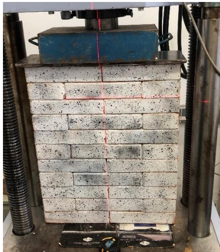
Figura 34 - Pequena Parede sendo preparada para o DIC.
