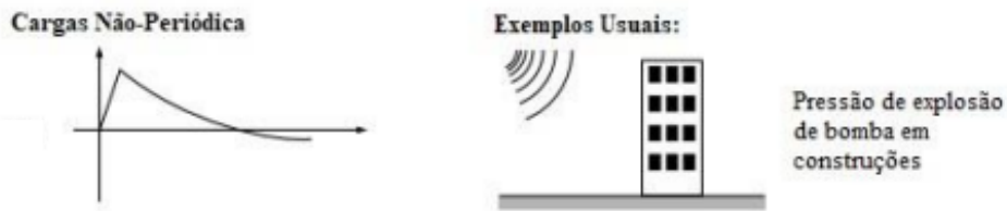
Figura 16 - Carregamento determinístico não-periódico. Fonte: Adaptado, Clough e Penzien (2003).
