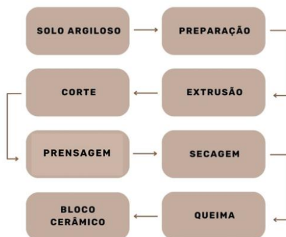
Figura 10 - Fluxograma do processo de fabricação de blocos cerâmicos.
