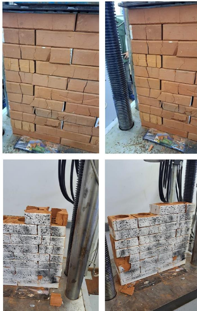
Figura 100 - Diferentes regiões de ruptura das Paredes.
