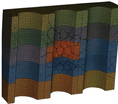
Figura 105 - Regiões de Fissuras.
