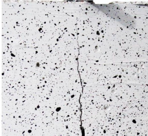
Figura 88 – Viga MB-1-1e após ensaio de flexão.
