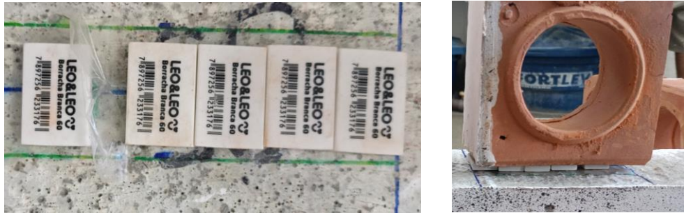
Figura 53 – Processo para secagem dos extensômetros e terminais.
