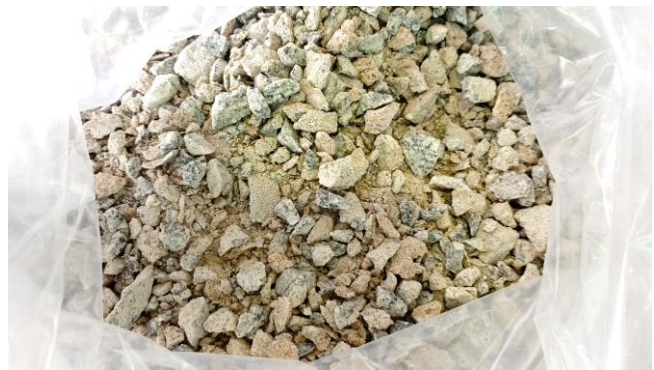
b) Agregado reciclado após a britagem.
