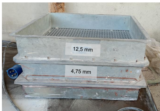
Figura 27 – Peneiras 12,5 mm e 4,75 mm utilizadas para obtenção de brita 0.
