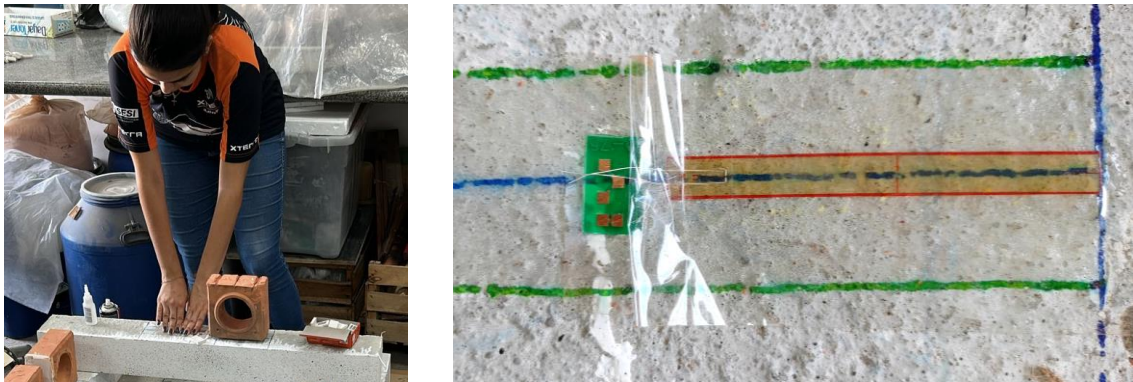
Figura 52 – Strain gage após aplicação de cola.
