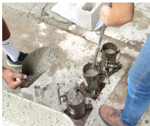
Figura 35 – Moldagem dos corpos de prova cilíndricos de 100 mm de diâmetro por 200 mm de altura.
