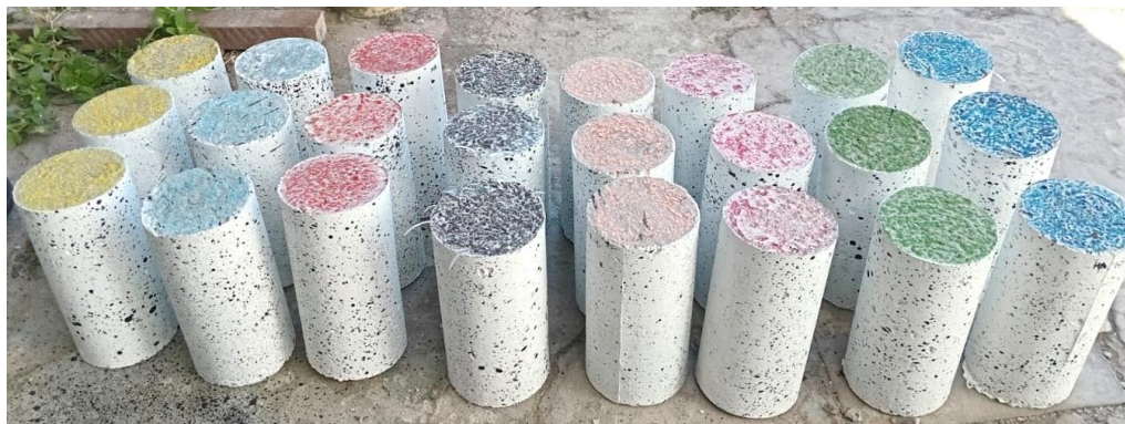
c) Corpos de prova cilíndricos após a finalização do processo de preparação superficial
