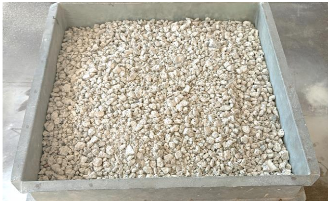
Figura 29 – Separação do agregado graúdo reciclado: a) material selecionado; b) fração descartada.
