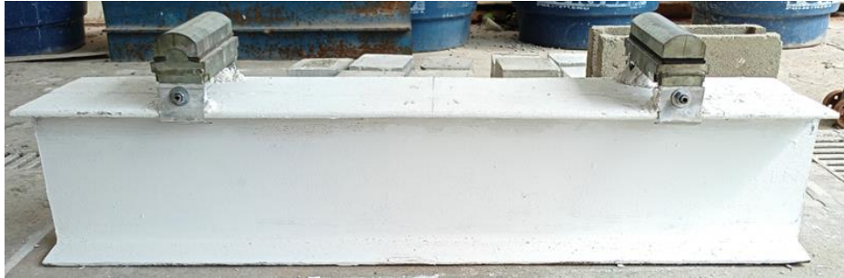
Figura 60 – Apoios para as vigas do Método B.
