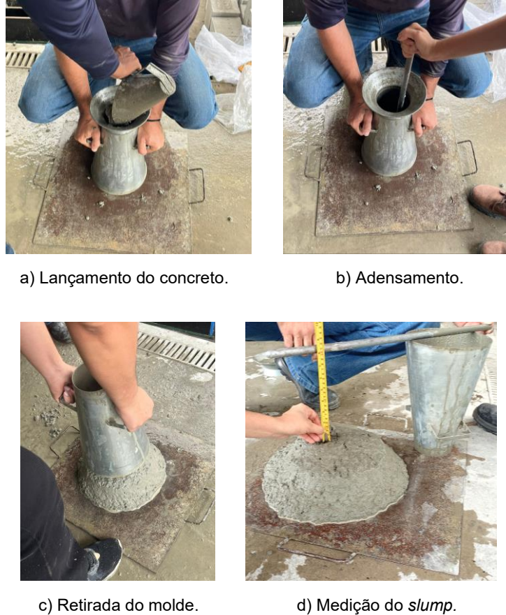
Figura 36 – Determinação da consistência pelo abatimento do tronco de cone.
