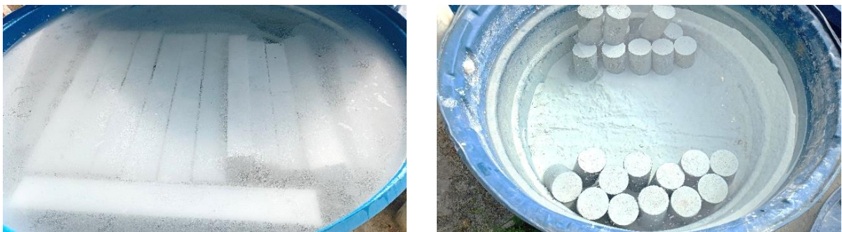
Figura 40 – Cura úmida dos corpos de prova.
