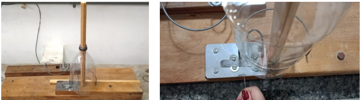
Figura 31 – Desfiador de fibras de PET a partir de garrafas.
