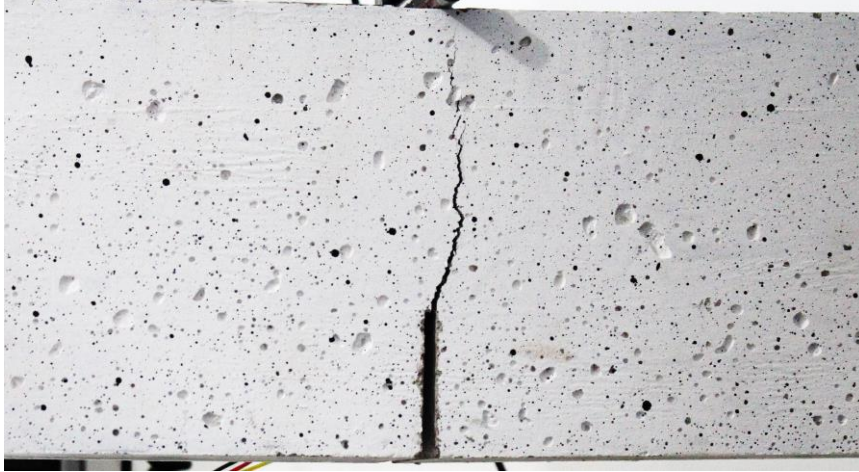
Figura 92 – Viga MB-1,25-2e após ensaio de flexão.
