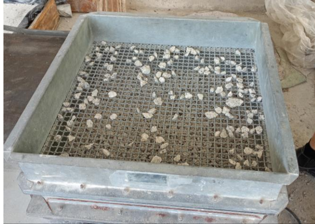
Figura 28 – Material retido na peneira 12,5 mm.
