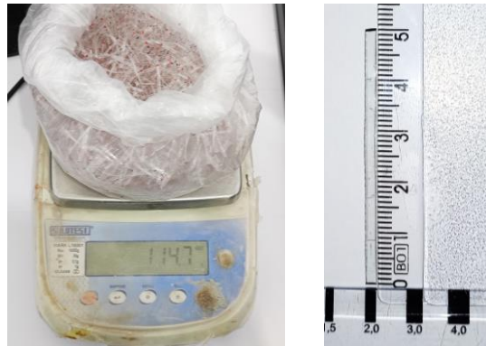
a) Pesagem das fibras. b) Medição da fibra.
