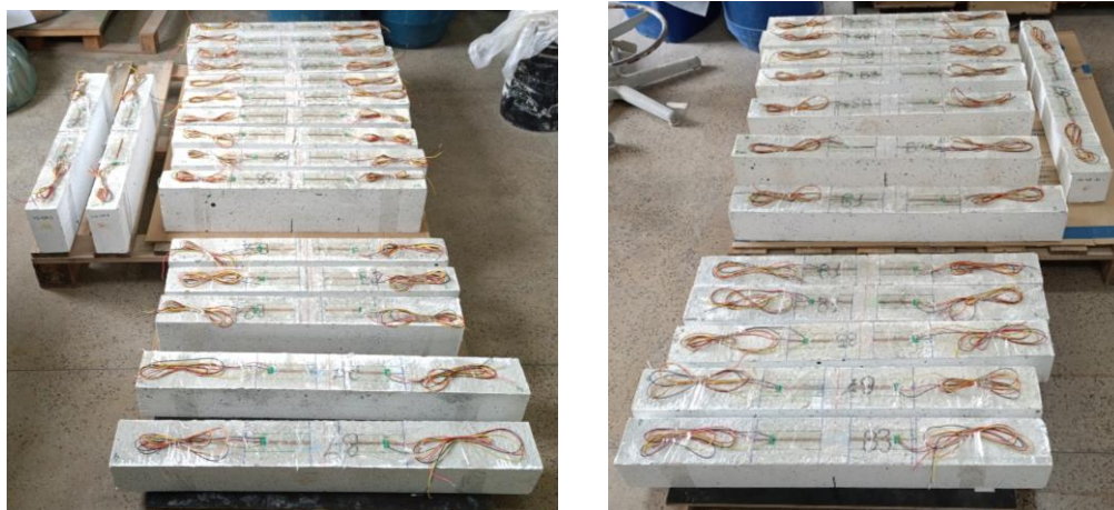
Figura 58 – Filme de PVC para proteger extensômetros e terminais.
