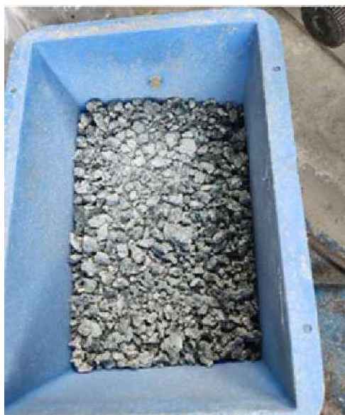
Figura 13 - Agregado Reciclado de Concreto após processo de britagem.
