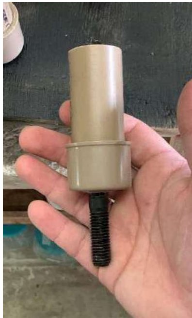
Figura 27 – Molde de PVC para fixação das fibras PET com matriz cimentícia para ensaio de pull-out .
