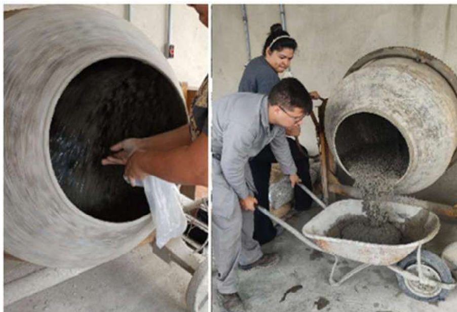
Figura 30 - Produção do concreto reciclado reforçado com fibras PET.
