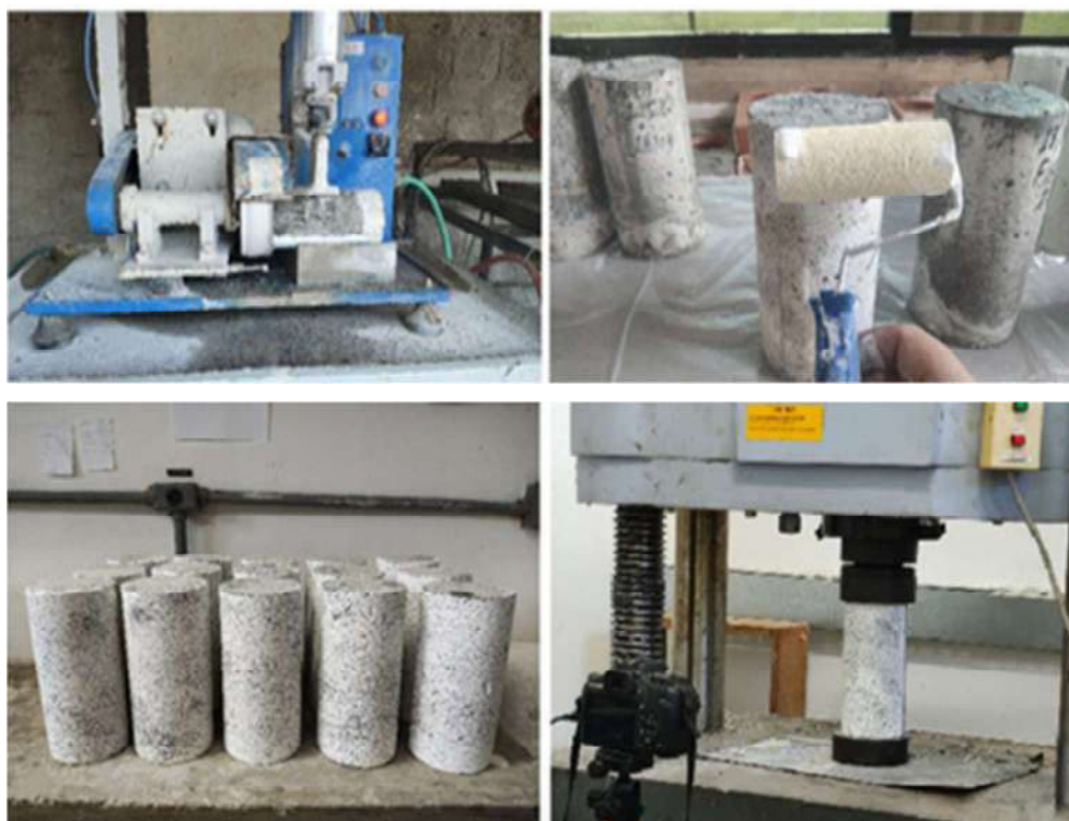
Figura 34 - Etapas para o ensaio de compressão: (a) retífica das faces, (b) pintura de base, (c) marcação dos pontos e secagem e (d) realização do ensaio de compressão.
