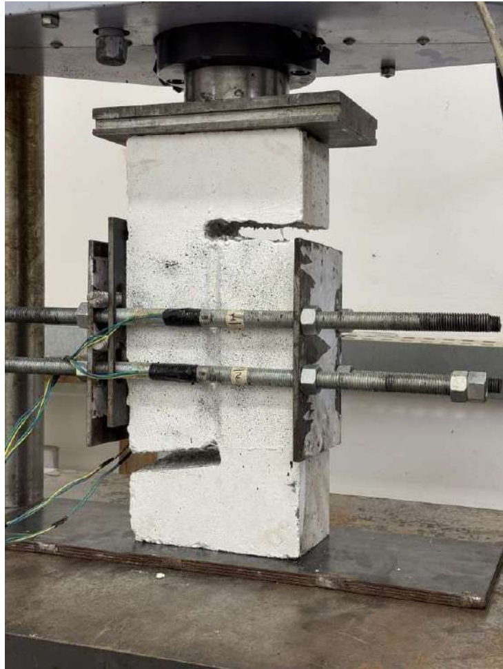
Figura 6 - Sistema de confinamento passivo utilizado nos ensaios de push-off.
