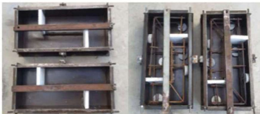
Figura 31 - Molde dos corpos-de-prova tipo push-off.
