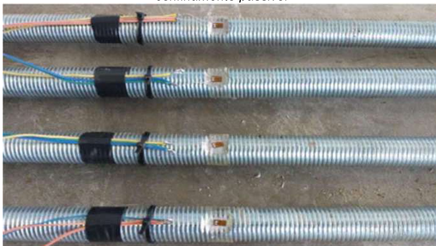
Figura 4 - Barras de aço rosqueadas instrumentadas com strain gauges utilizadas no sistema de confinamento passivo.
