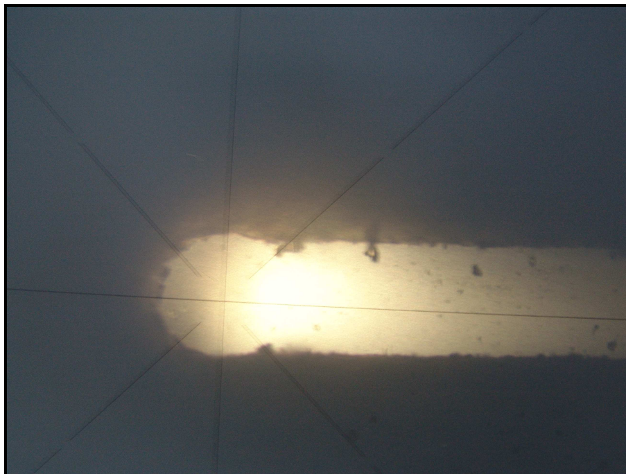
Figura 29 – Detalhe do entalhe não-singular aberta nos corpos de prova. Aumento 10x.
