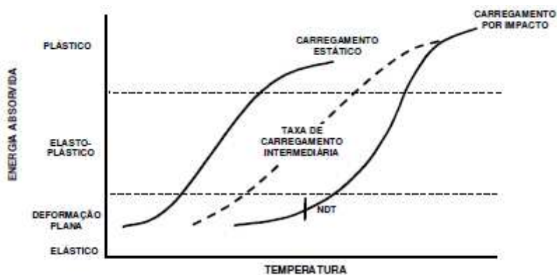
Figura 22 - Efeito (esquemático) da taxa de deformação na tenacidade ou ductilidade de metais com transição dúctil-frágil (Fortes, 2003).
