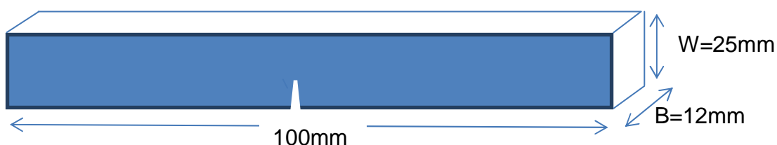
Figura 28 – Detalhe do corpo de prova com entalhe.
