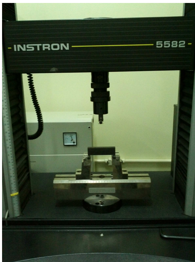
Figura 33 – Dispositivo de ensaio de flexão em três pontos utilizado na determinação da tenacidade à fratura ( K_{Ic} ) dos aços AISI 4140.
