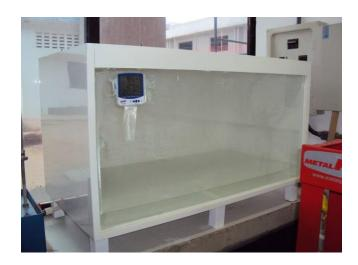
Figura 3.3. – Câmara úmida utilizada durante a cura dos corpos-de-prova (Rodrigues, 2012).
