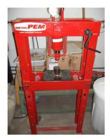
Figura 3.2. Prensa hidráulica utilizada na confecção dos corpos cimentíceos (Rodrigues, 2012).
