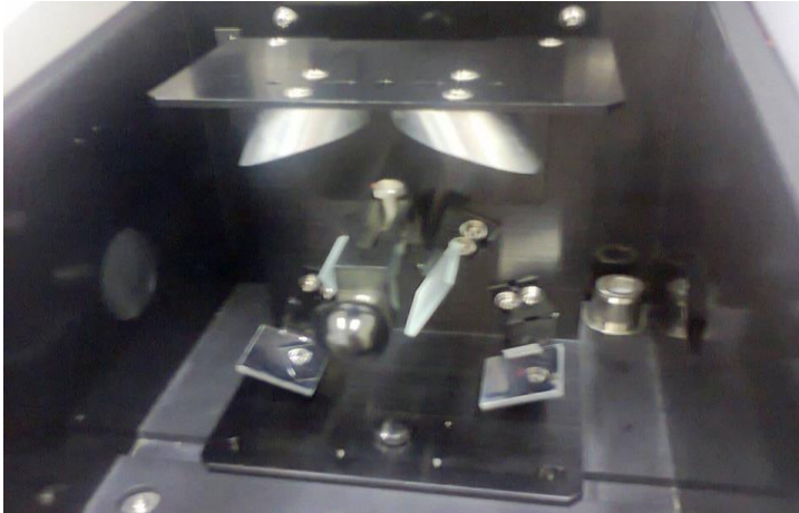
Figura 3.7 – Acessório de Refletância contendo o suporte com o diamante.
