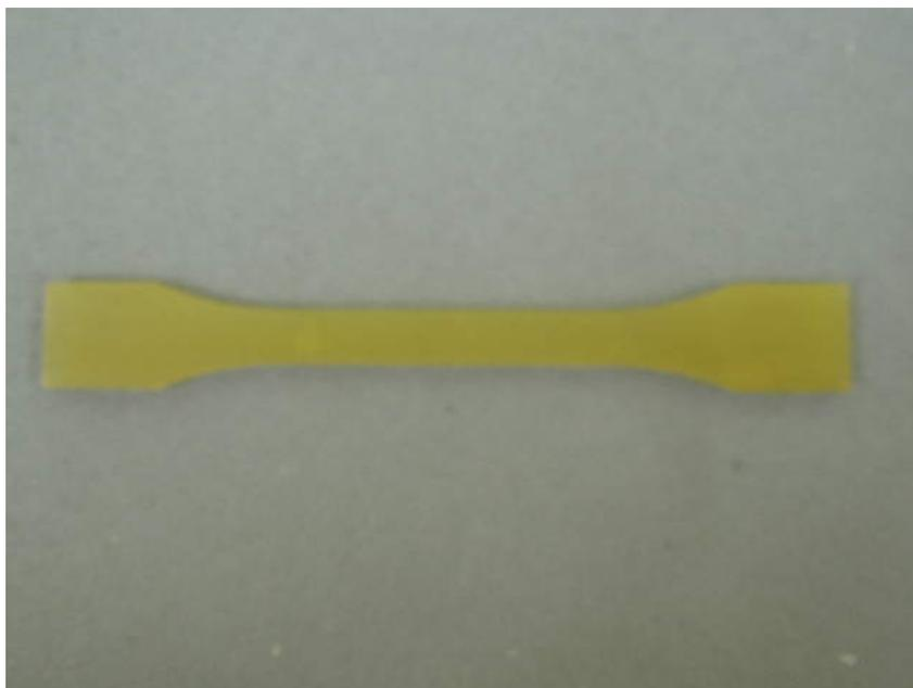
Figura 4.5 – Amostra para ensaio de fluência
