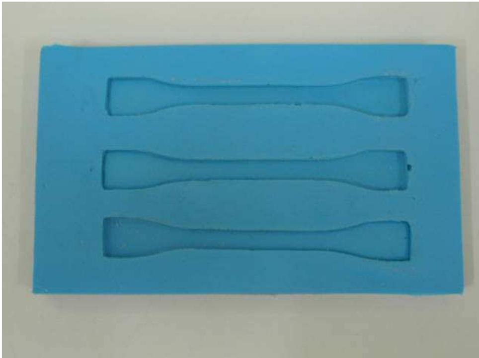
Figura 4.4 – Molde utilizado para confecção das amostras para ensaio de fluência
