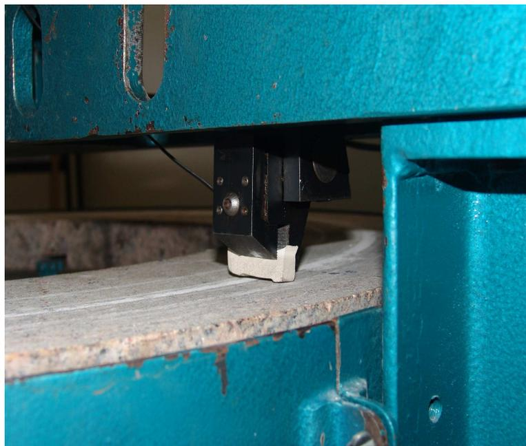
Figura 4.13 – Amostra fixa pelo suporte sobre o disco de granito
