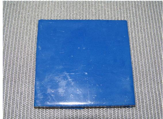
Figura 4.7 - Amostra de aço revestida com a PPA
