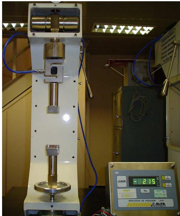
Figura 4.14 – Máquina de Fluência
