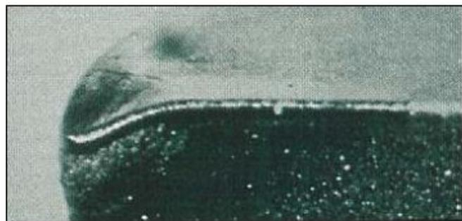
Figura 14 - Deformação Plástica devido a Elevadas Temperaturas (Kennametal Hertel, 1995).
