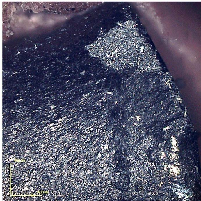
Figura 61 – Região de fratura da amostra de 5 ciclos de sinterização
