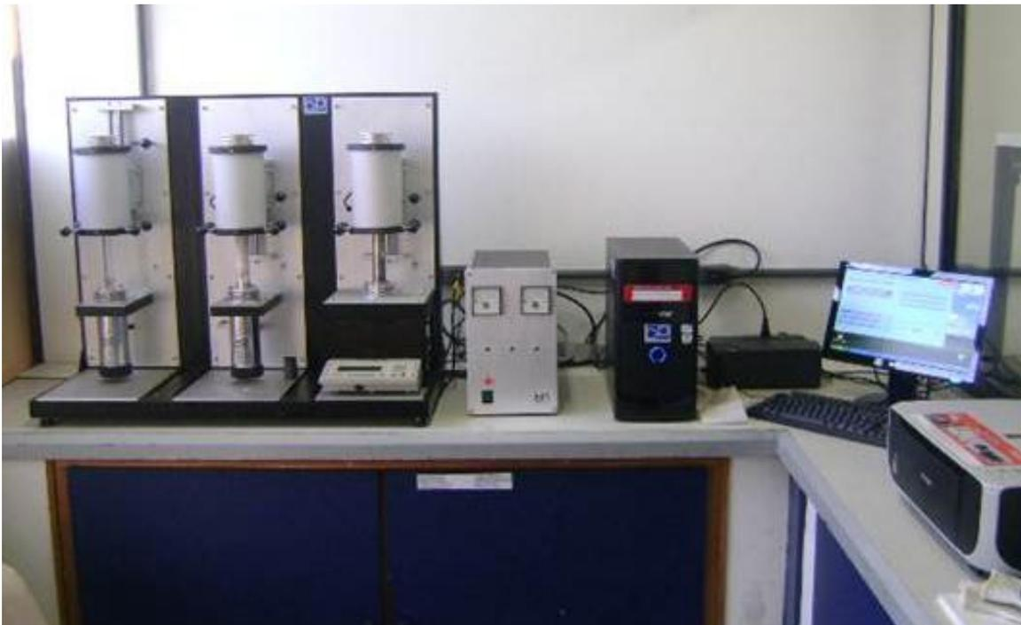
Figura 24 - Equipamento de análise térmica BP 300. LAMAV/UENF
