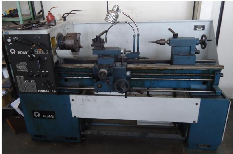
Figura 25 - Torno semiautomático modelo ROMI TORMAX 20A
