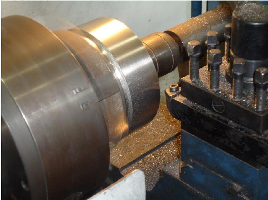
Figura 55 – Aspecto da peça usinada após ensaio de cilindragem.
