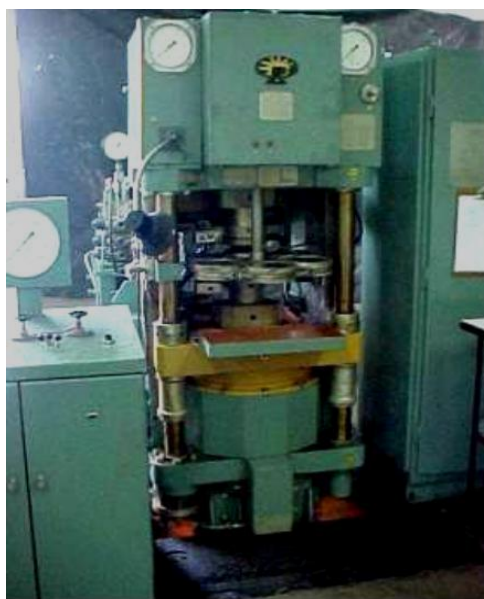
Figura 20 – Prensa hidráulica, modelo DO138B, 630 toneladas de força
