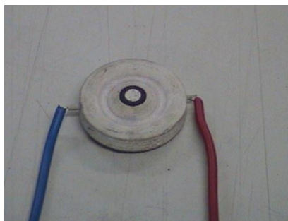
Figura 23 – Conjunto célula de reação, cápsula deformável e termopar pronto. para a execução da calibração da temperatura. (Júnior, 2007)
