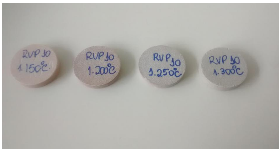
Figura 4.54 - Tonalidades das amostras RVP10, sinterizadas entre 1150°C à 1300°C.
