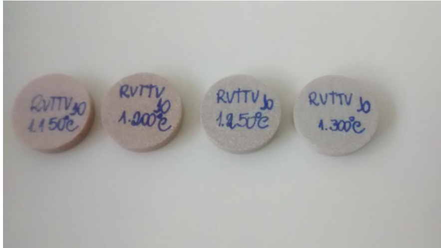
Figura 4.57 - Tonalidades das amostras RVTTV10, sinterizadas entre 1150°C à 1300°C.
