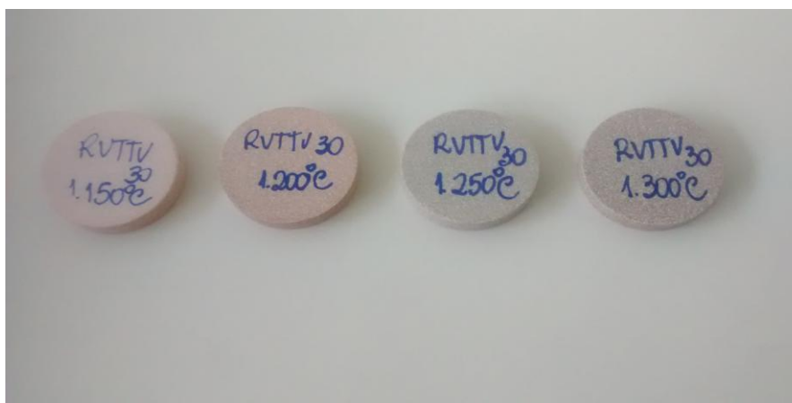
Figura 4.59 - Tonalidades das amostras RVTTV30, sinterizadas entre 1150°C à 1300°C.
