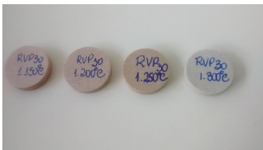
Figura 4.56 - Tonalidades das amostras RVP30, sinterizadas entre 1150°C à 1300°C.
