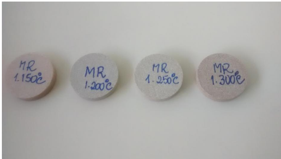
Figura 4.53 - Tonalidades das amostras MR, sinterizadas entre 1150°C à 1300°C.
