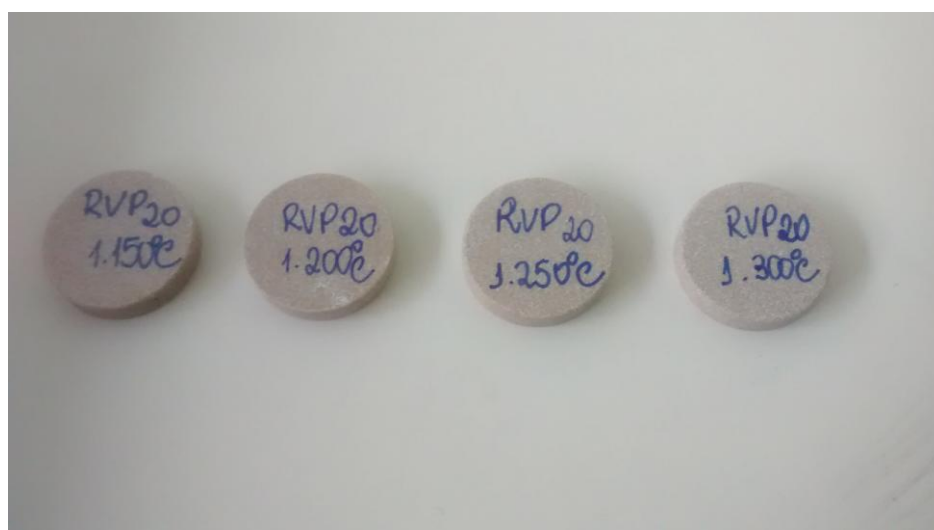
Figura 4.55 - Tonalidades das amostras RVP20, sinterizadas entre 1150°C à 1300°C.
