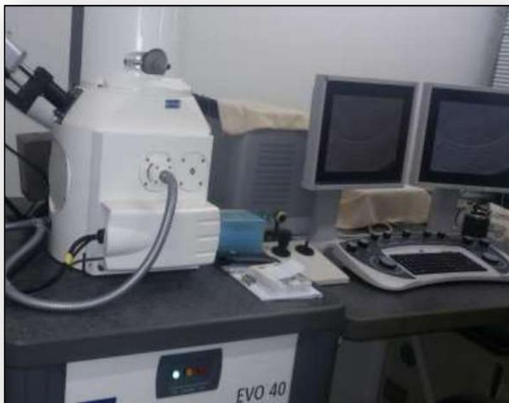
**Figura 11:** Microscópio eletrônico de varredura de marca ZEISS, Evo 40, (10kV), disponível no Laboratório de Biologia Celular e Tecidual – LBCT CBB/UENF (Arquivo próprio)
