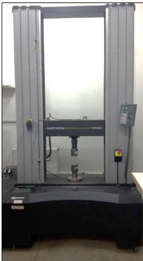
**Figura 07:** INSTRON modelo 5582, LAMAV/UENF. (Arquivo próprio)
