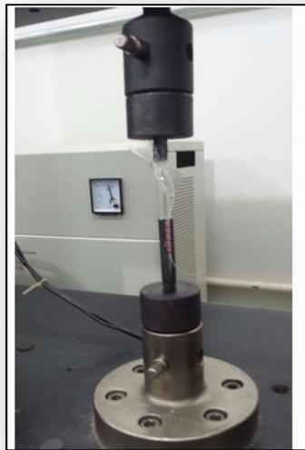
**Figura 08:** Dispositivo Adaptado para Ensaio Mecânico de Tração (Arquivo próprio)
